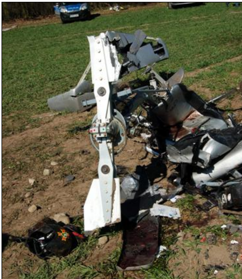
Rys.5. Destrukcja głowicy wirnika nośnego (foto: PKBWL).
