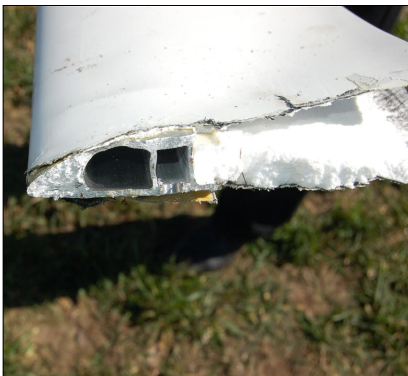
Rys.6. Destrukcja łopaty wirnika nośnego, widok od strony głowicy (foto: PKBWL).
