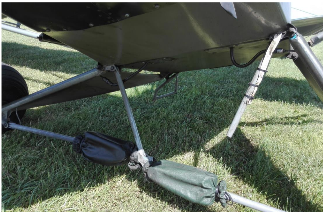
Rys. 2. Złamany wspornik podwozia głównego. [foto A. Nowak]
