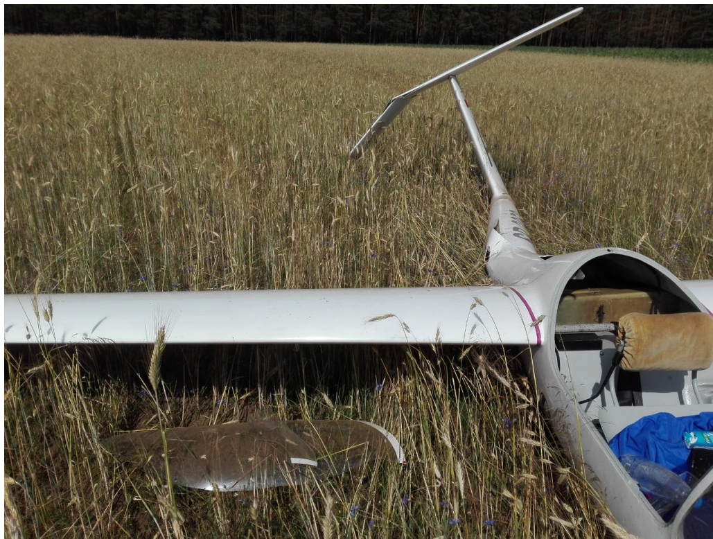
Rys. 2 Szybowiec Jantar Standard – widoczne uszkodzenia (fot. Użytkownik)
