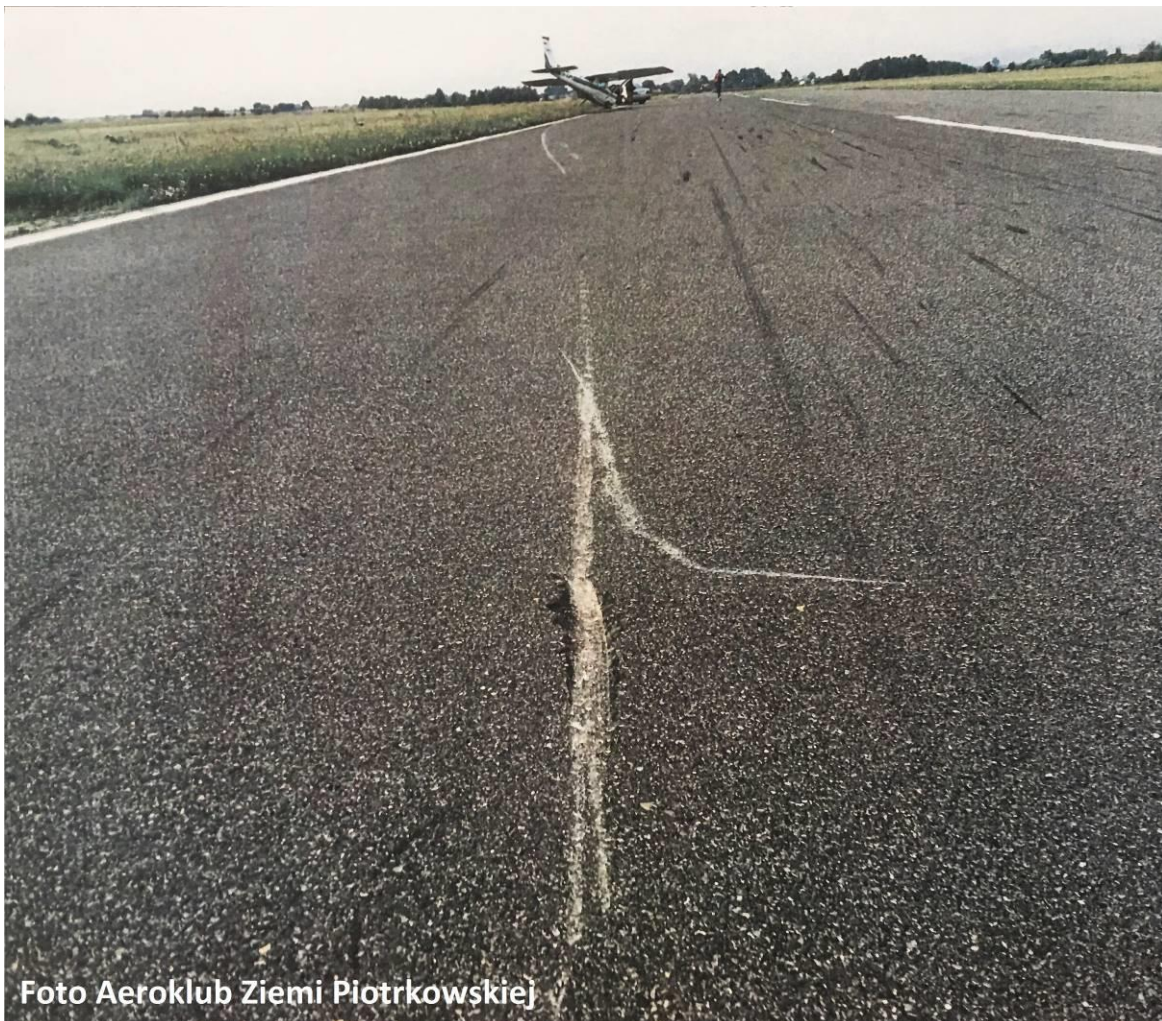
Ilustracja nr 1. Na ilustracji widać samolot po zakończonym dobiegu. Widoczny jest ślad pozostawiony na pasie startowym przez złamaną goleń przedniego podwozia i śmigło.
