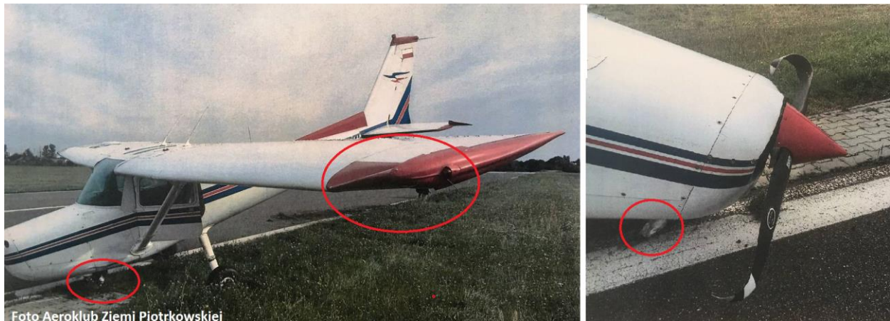
Ilustracja nr 2. Na zdjęciach pokazano uszkodzenia samolotu.
