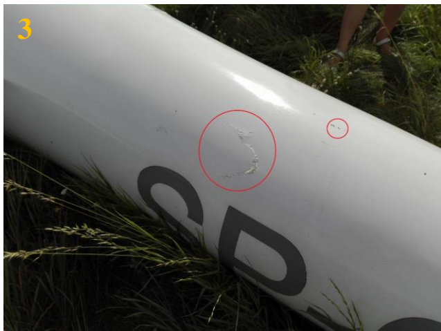
Rys. 2 Uszkodzenia szybowca SZD-51-1 Junior [źródło: Użytkownik]
