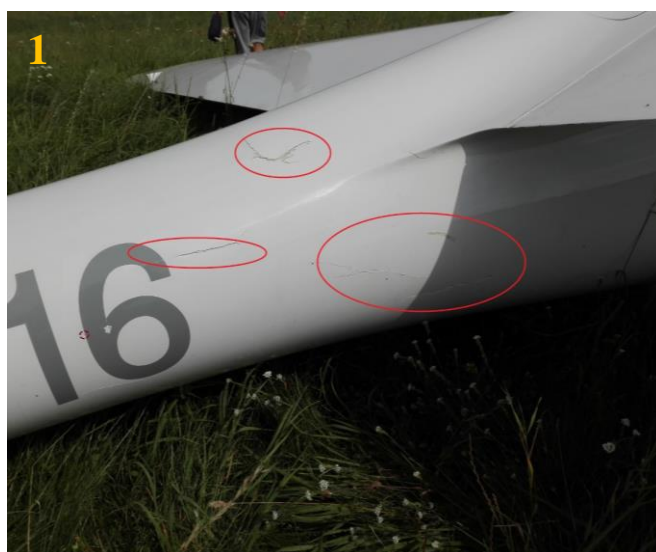
Rys. 2 Uszkodzenia szybowca SZD-51-1 Junior [źródło: Użytkownik]
