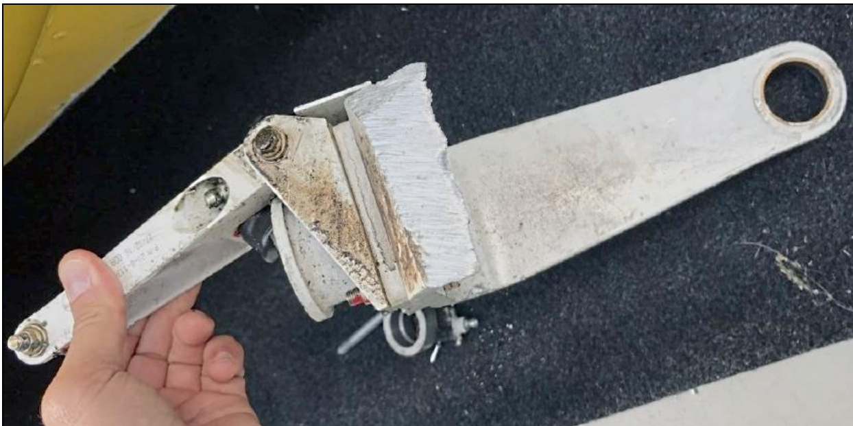
17 – Zniszczony (złamany i starty) widelec przedniego koła [foto: Użytkownik samolotu].
