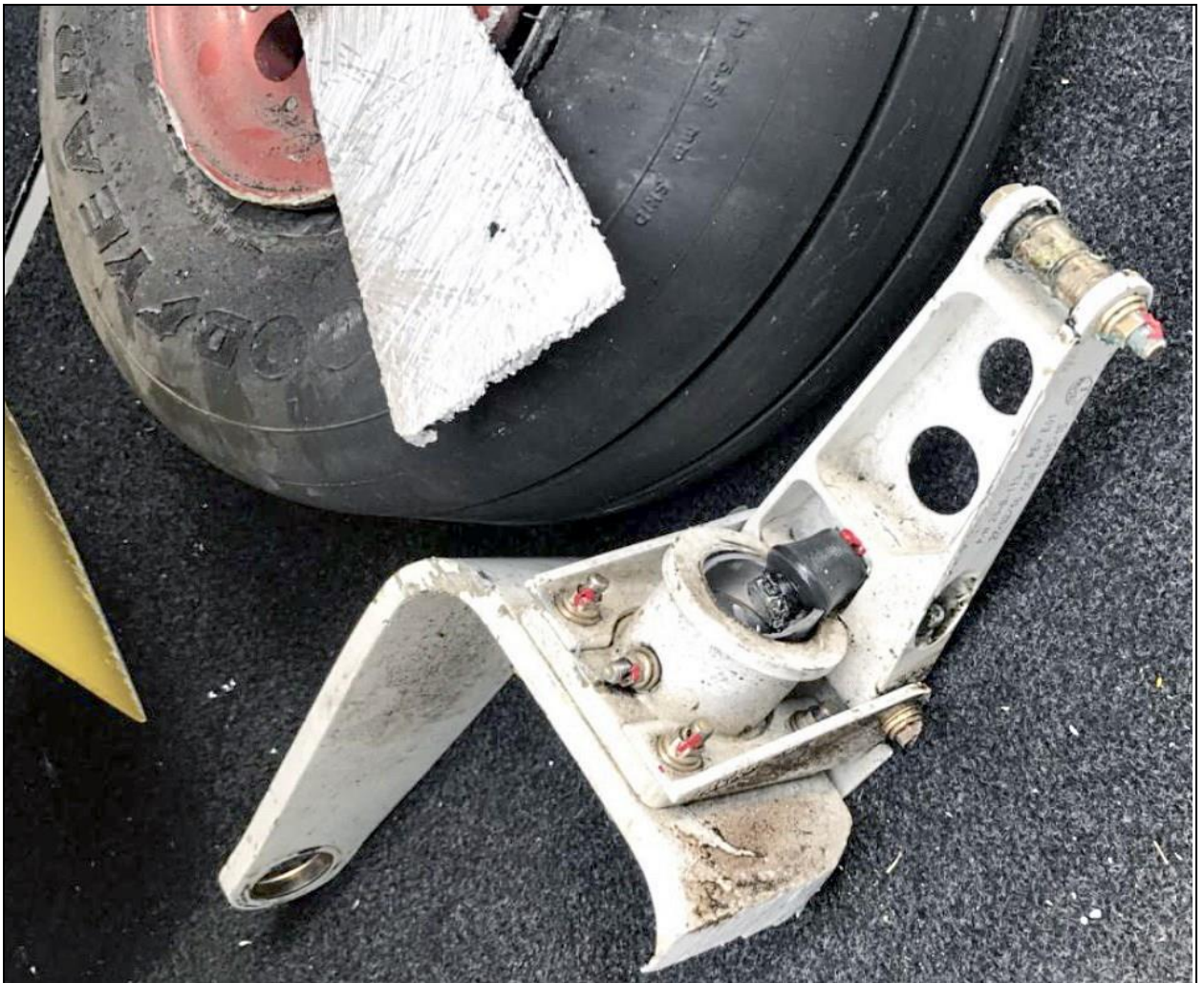
19 – Zniszczony widelec koła i koło przedniego podwozia [foto: Użytkownik samolotu].
