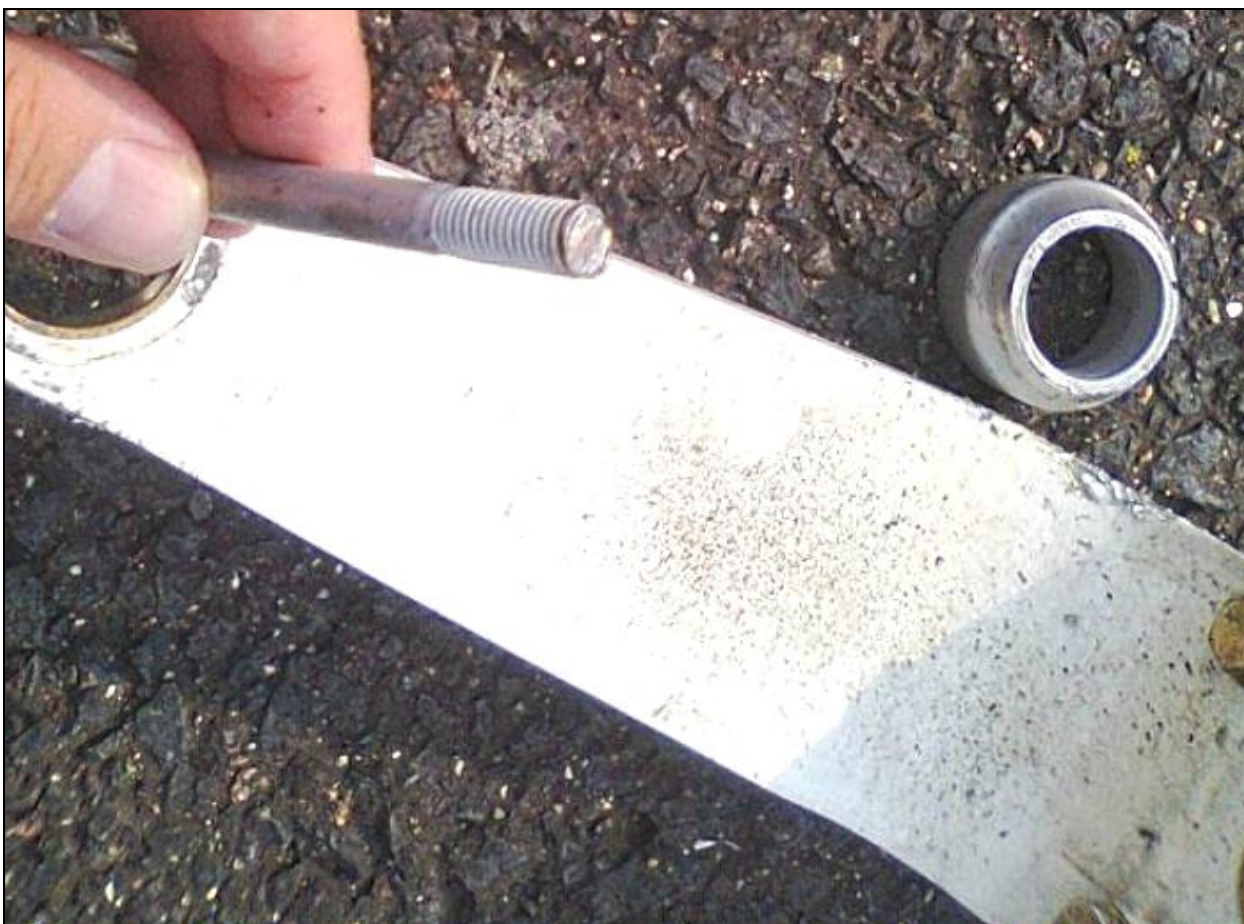
18 – Ścięty sworzeń osi koła i jego tulejka [foto: Użytkownik samolotu].
