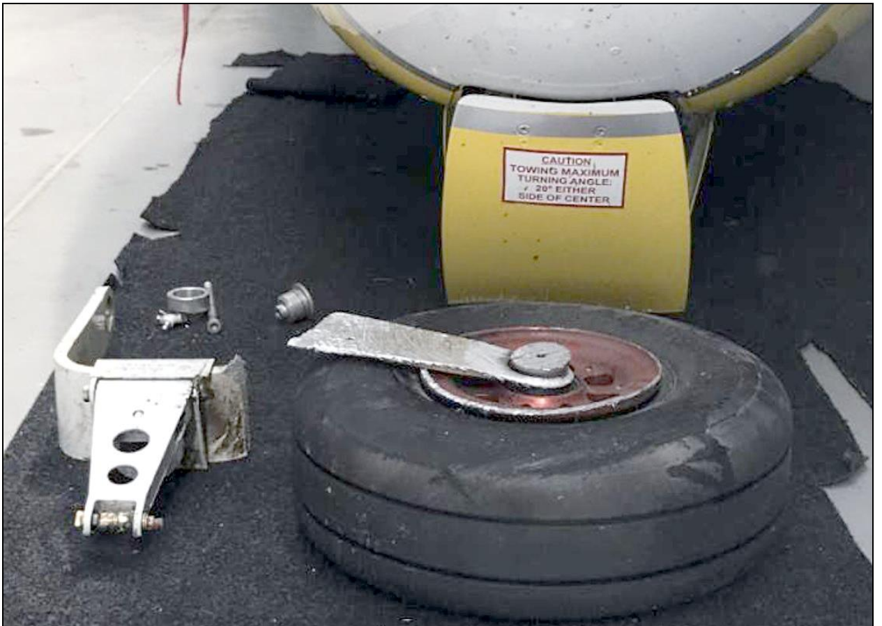
15 – Elementy przedniego podwozia, które oddzieliły się od samolotu [foto: Użytkownik samolotu].
