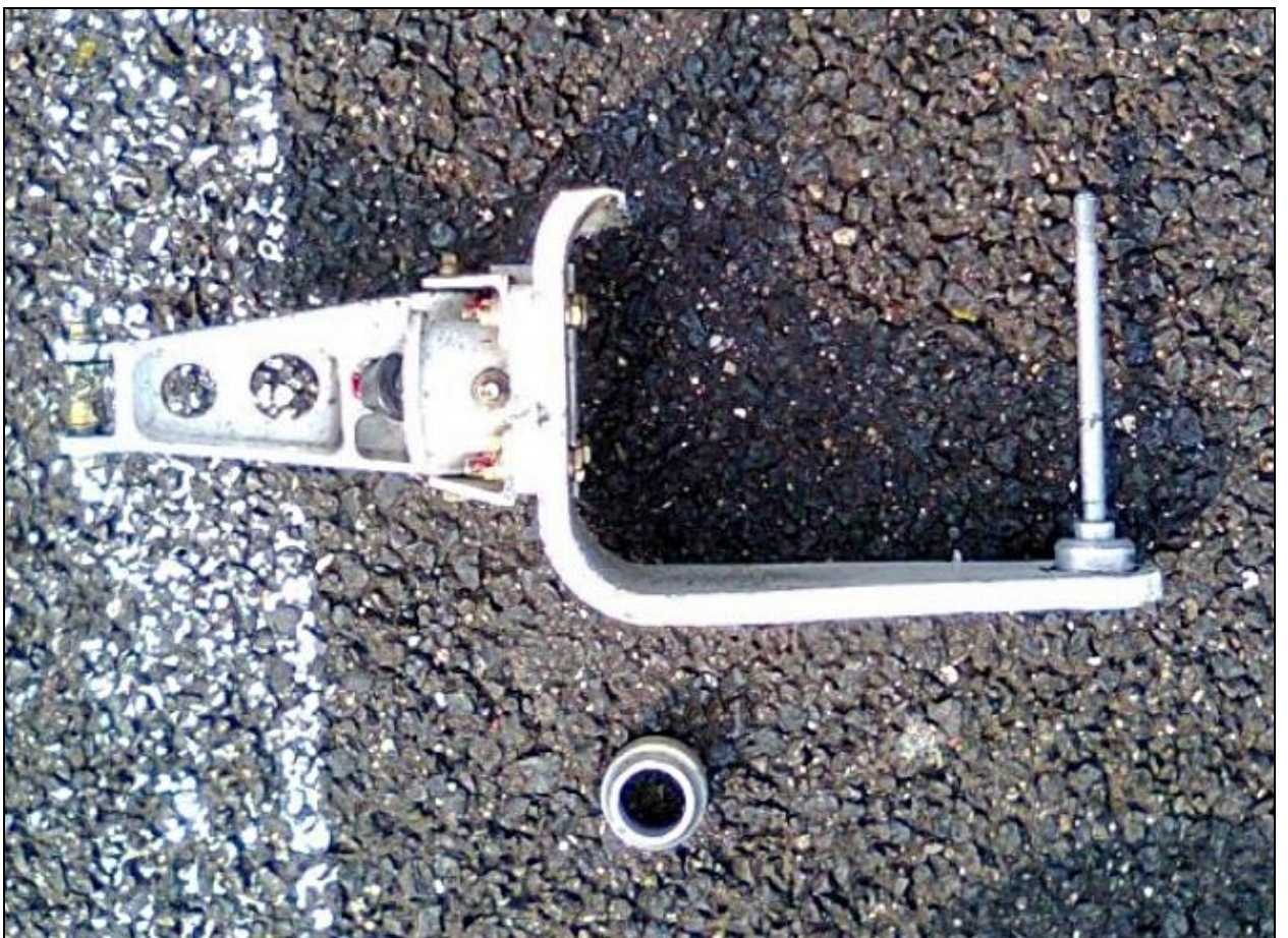
16 – Zniszczony (złamany i starty) widelec przedniego koła i tulejka sworznia osi koła [foto: Użytkownik samolotu].
