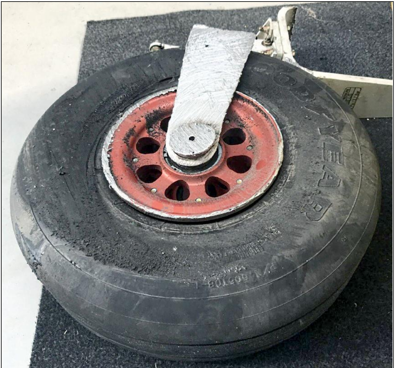
22 – Przednie koło z zniszczonym (odłamanym i startym) fragmentem widelca [foto: Użytkownik samolotu].
