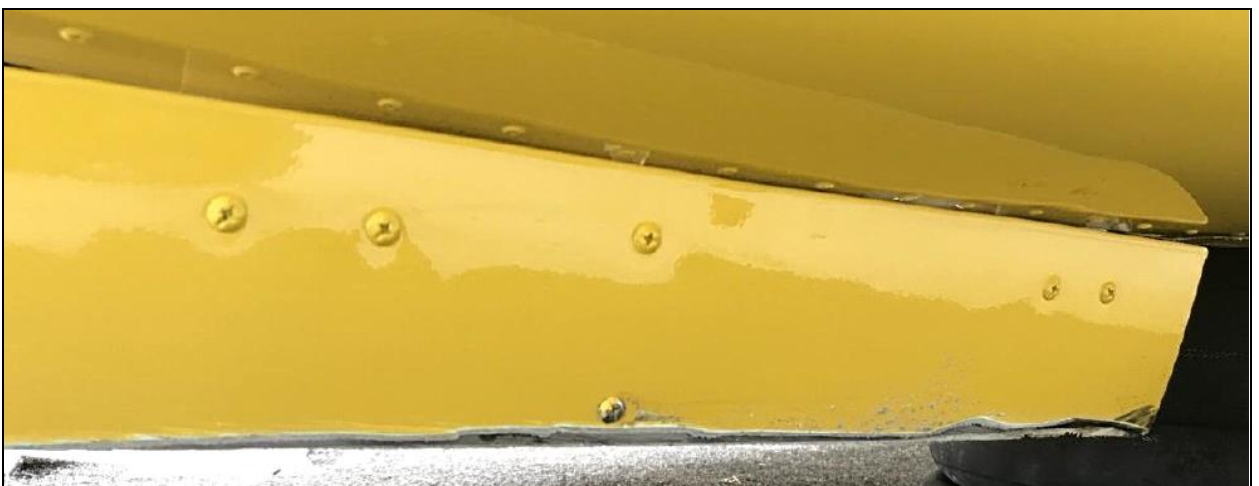
9 – Uszkodzona prawa pokrywa luku przedniego podwozia [foto: Użytkownik samolotu].
