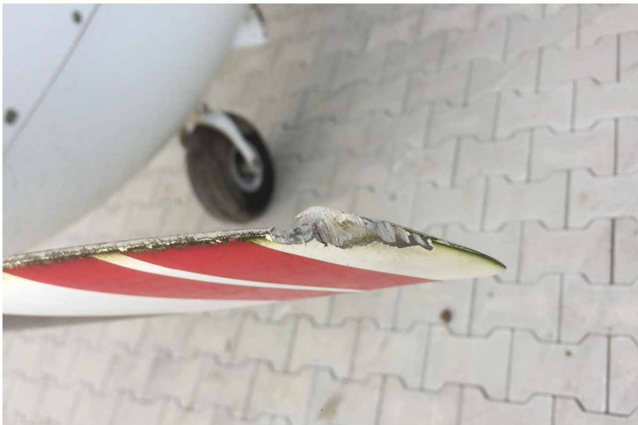
Fot.1 Łopata śmigła nr 1 po zdarzeniu. (foto. użytkownika)
