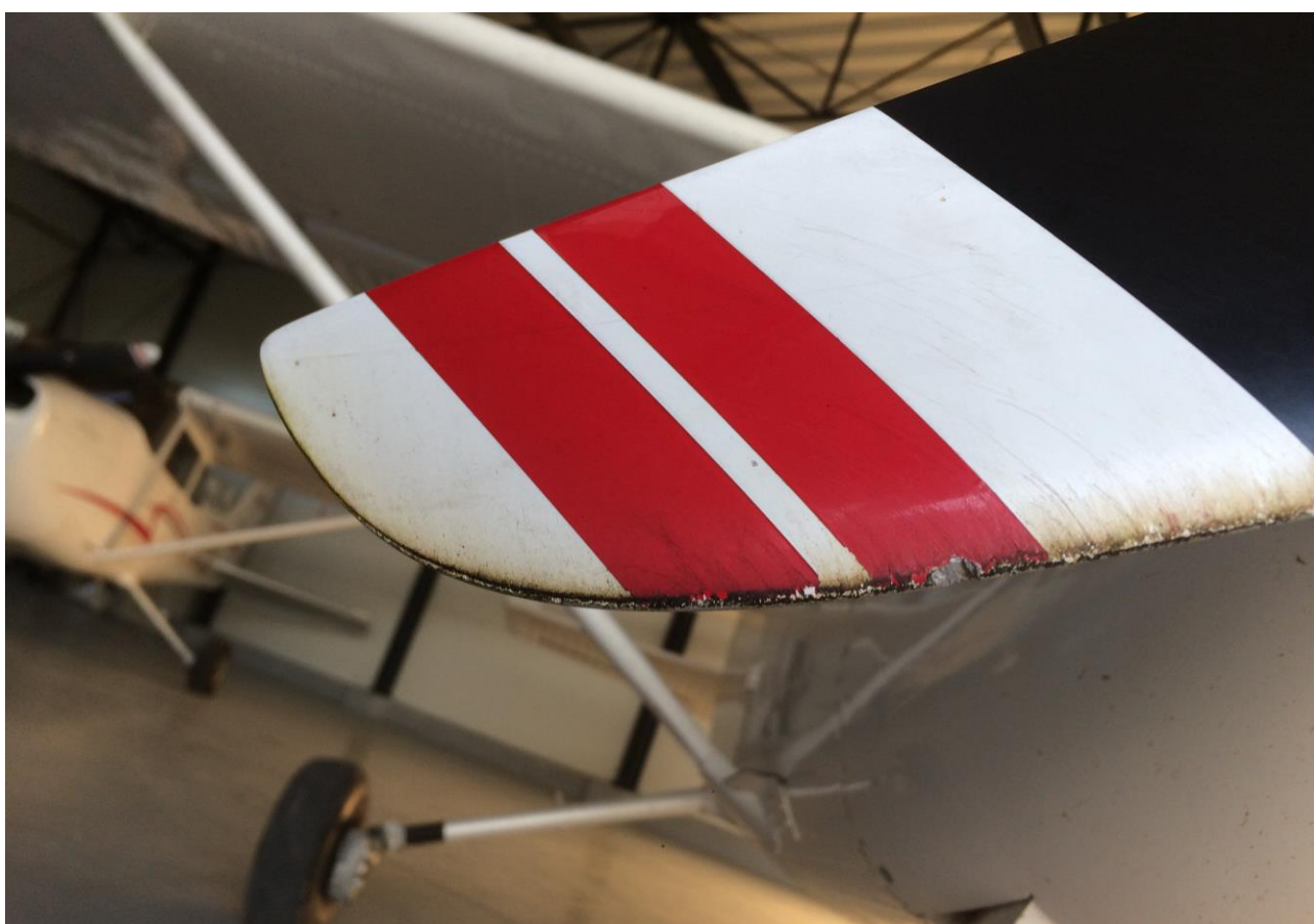
Fot.2 Łopata śmigła nr 2 po zdarzeniu. (foto. użytkownika)
