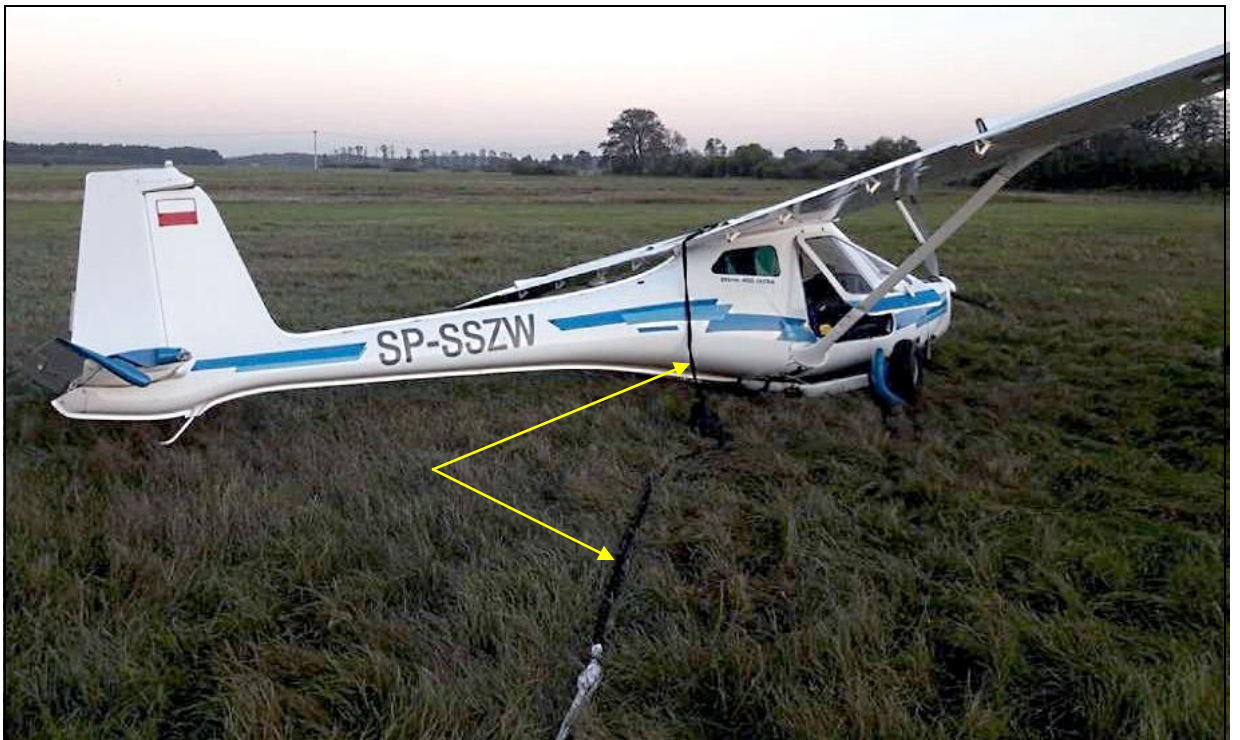
7 – Samolot na miejscu wypadku. Widoczna wyciągnięta uprząż spadochronu ratowniczego systemu GRS [foto: Wojciech Nawrocki, włoclawek.naszemiasto]
