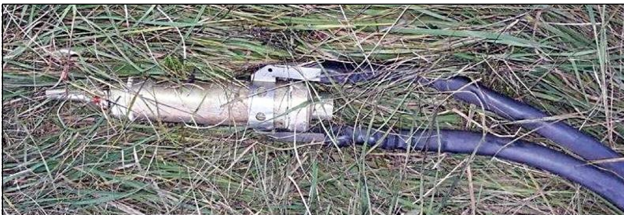
9 – Rakietka systemu ratowniczego GRS na miejscu wypadku; z prawej strony kadru widoczne izolowane liny łączące ją ze spadochronem [foto: Wojciech Nawrocki, wloclawek.naszemiasto]
