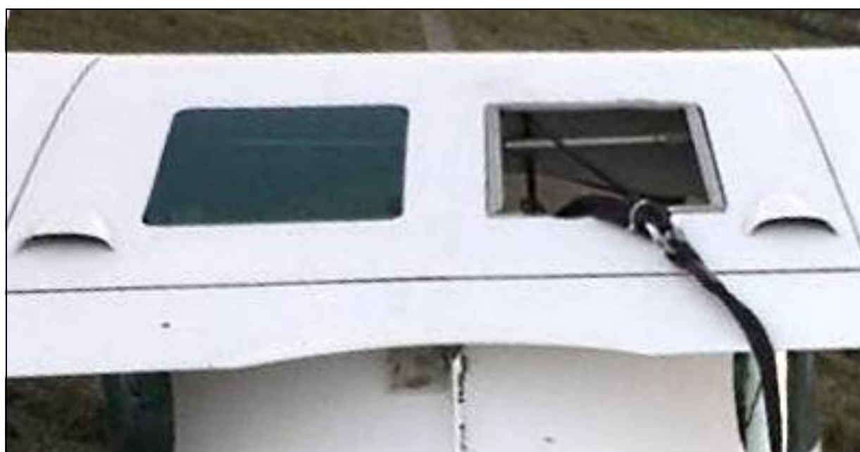
5 – Otwarty (pozbawiony oszklenia) luk systemu ratowniczego GRS Galaxy na samolocie 3Xtrim. Widoczna taśma nośna spadochronu.
