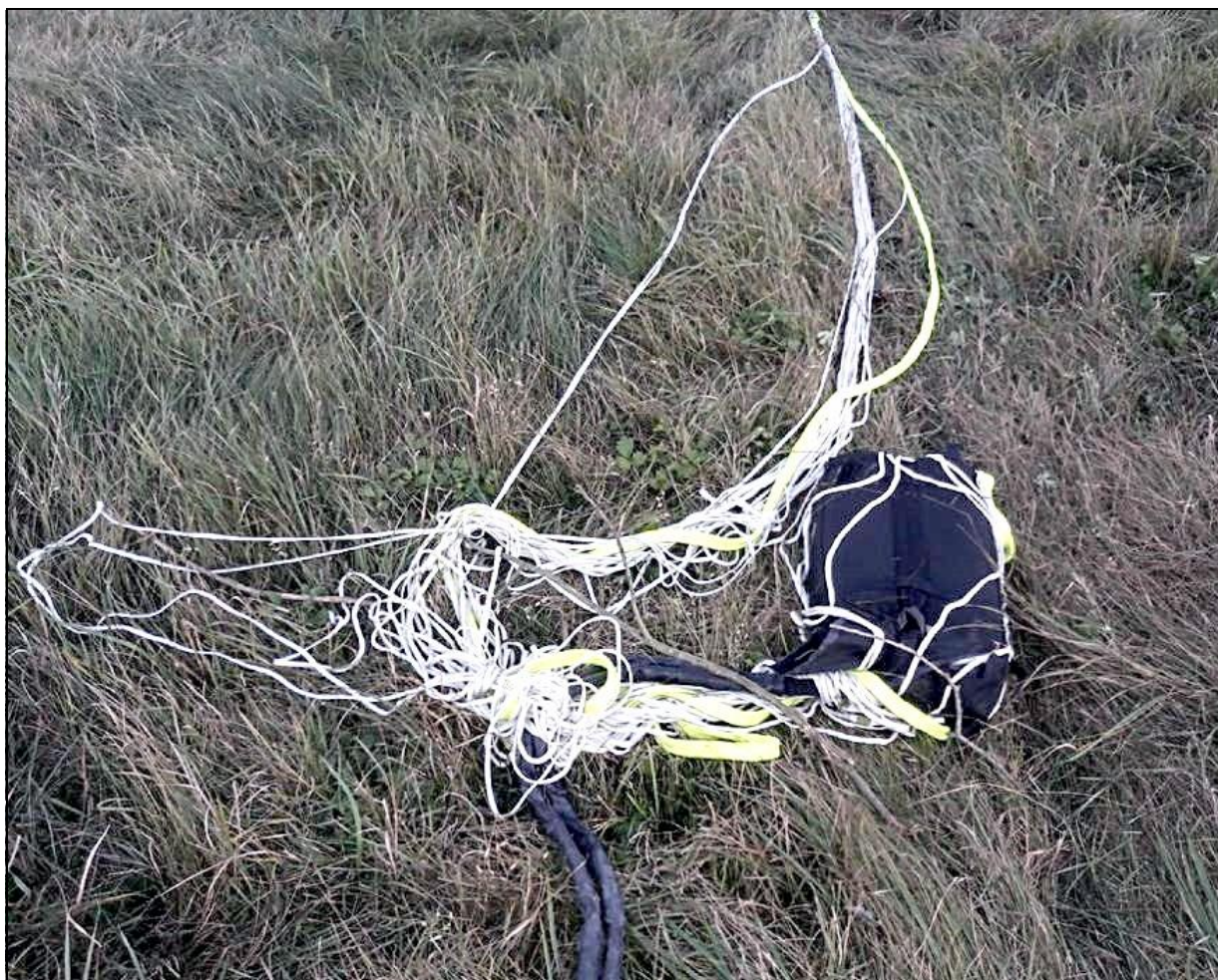
8 – Spadochron systemu ratowniczego GRS w pokrowcu, z częściowo wyplecionymi linkami. W dolnej części kadru widoczne izolowane liny prowadzące do rakiety [foto: Wojciech Nawrocki, wloclawek.naszemiasto]
