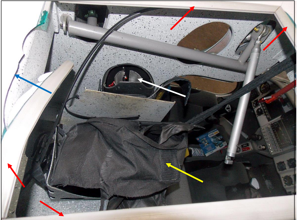
6 – Zbliżenie z zewnątrz na luk systemu ratowniczego GRS. Widoczny wylot rury-prowadnicy rakiety systemu GRS (biała strzałka), zasobnik spadochronu (żółta strzałka) i uszczelka obramowania pokrywy luku (czerwone strzałki). Zwraca uwagę uszkodzenie – wyłamanie pokrywy przy tylnej krawędzi luku (strzałka niebieska).
