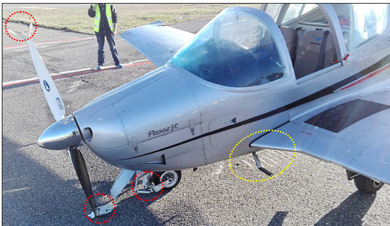
2 – Samolot na miejscu zdarzenia. Widoczne uszkodzenia śmigła i przedniego podwozia (zaznaczone kolorem czerwonym) oraz ślady łopat śmigła na nawierzchni asfaltowej (zaznaczone kolorem żółtym) [fot: Użytkownik samolotu].
