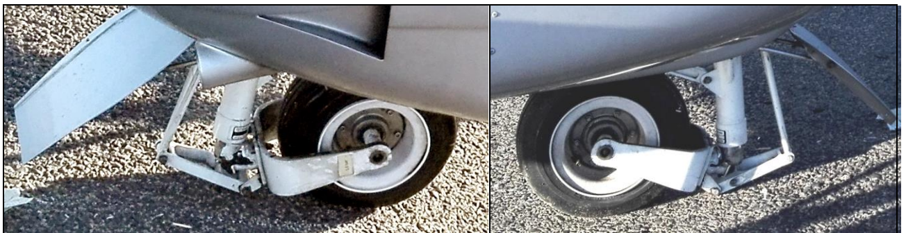
4, 5 – Zbliżenie na uszkodzone przednie podwozie z lewej i prawej strony [fot. Użytkownik samolotu].
