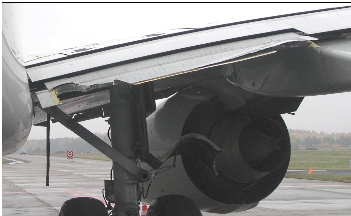
73 – Uszkodzenia lewej klapy wewnętrznej, widok od tyłu
