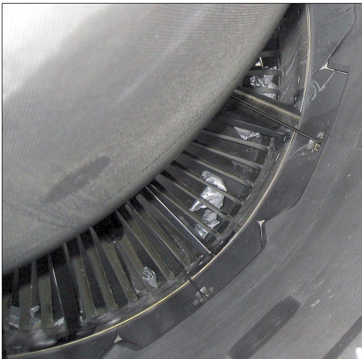
76 – Szczątki lamp, które przeszły przez zewnętrzny przepływ silnika [foto: załoga samolotu]
