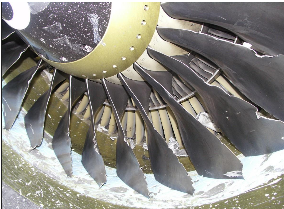
50 – Zbliżenie na uszkodzenia wentylatora lewego silnika
