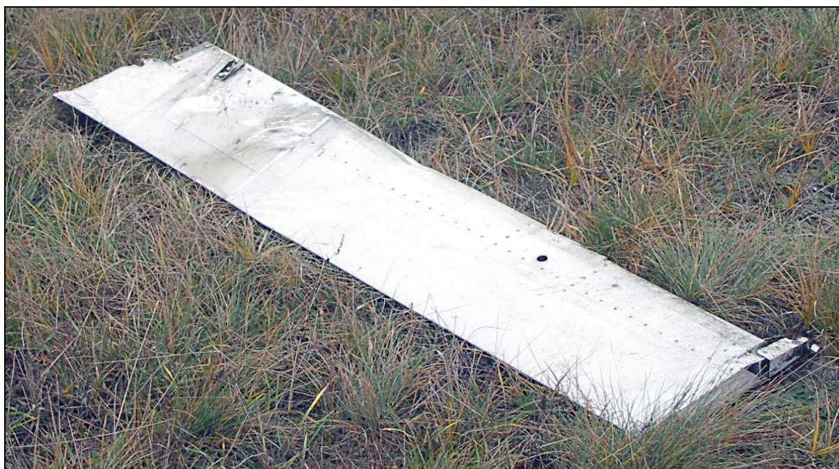
14 – Oderwany spływowy fragment prawej kłapy zewnętrznej
