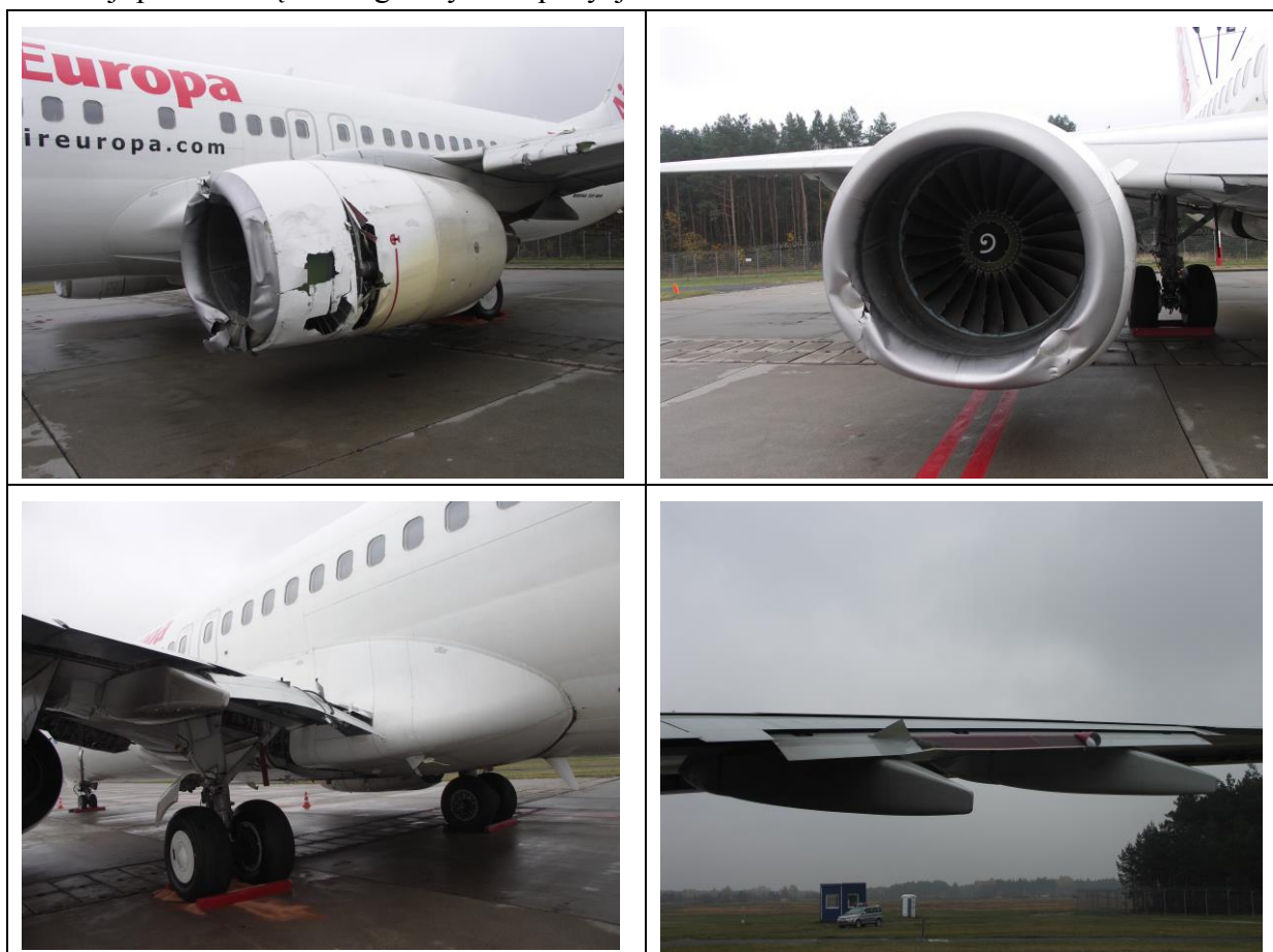
Ilustracje 3-6. Uszkodzenia samolotu EC-HBM
