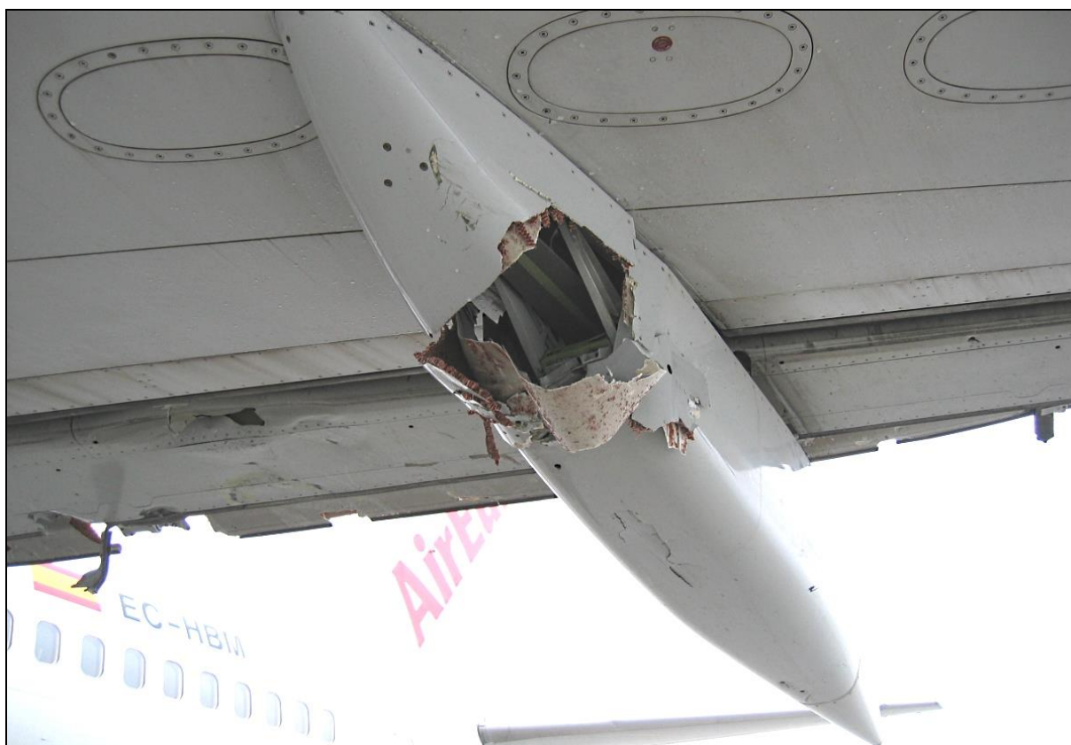
62 – Uszkodzenia osłony prowadnicy lewej kłapy zewnętrznej; widoczne uszkodzenia kłapy [foto: załoga samolotu]
