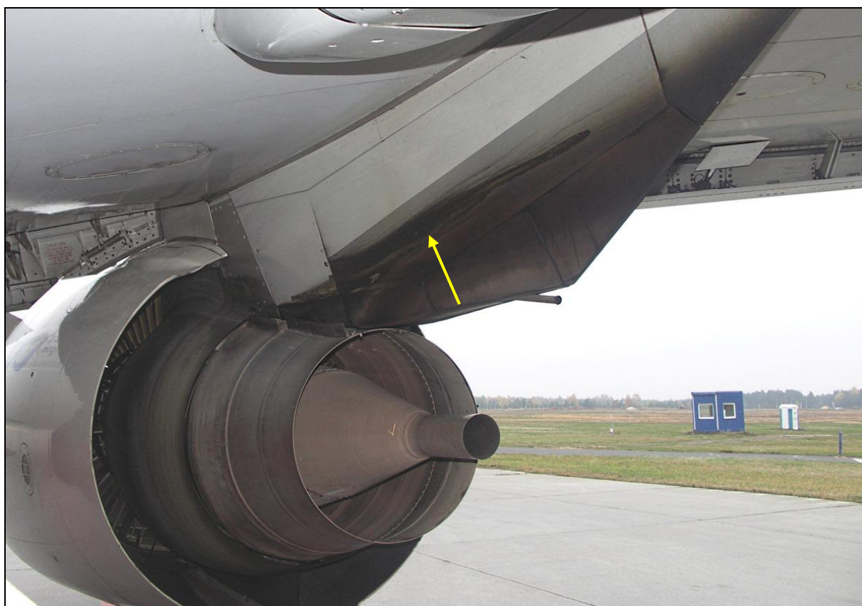
75 – Nienormalne osmalenia na wsporniku prawego silnika
