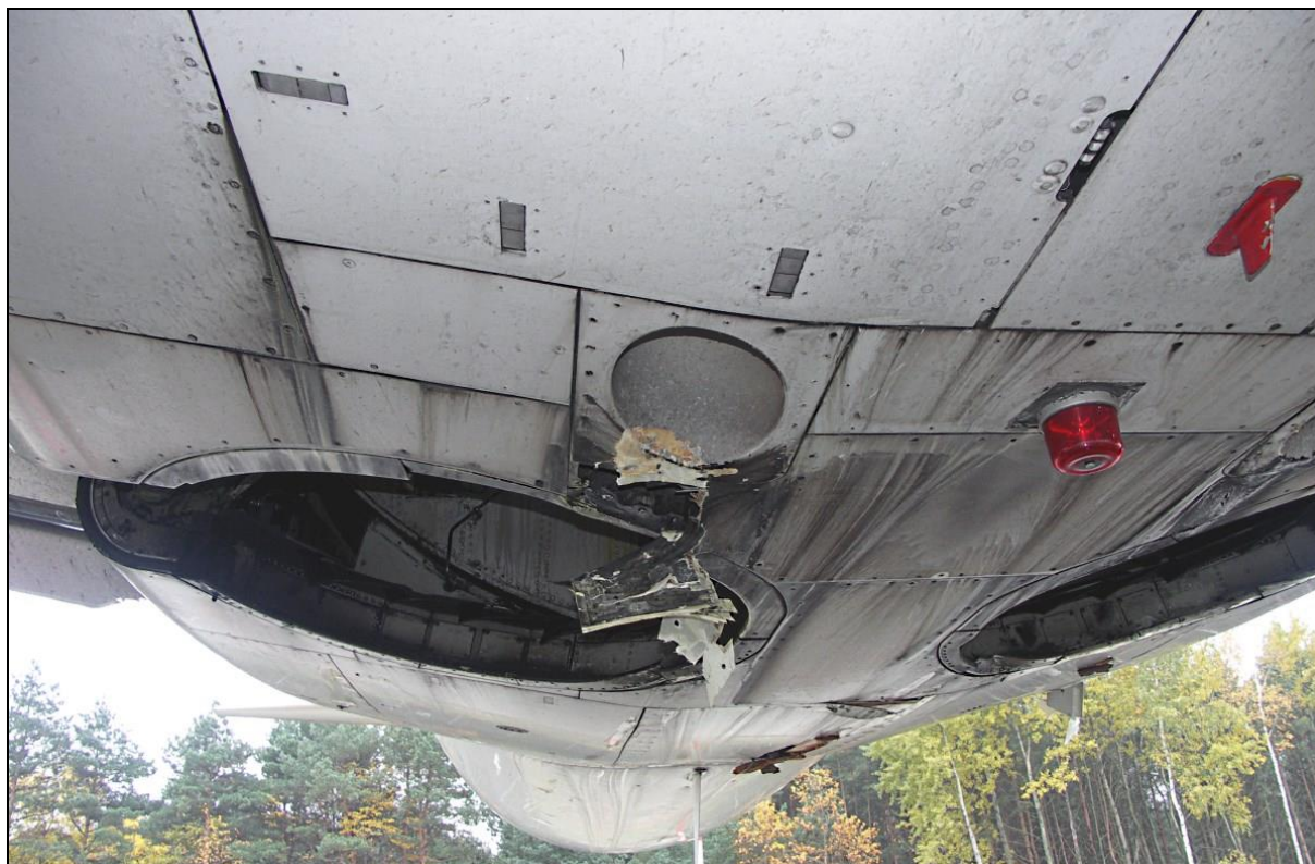
86 – Uszkodzenia owiewki podkadłubowej – zbliżenie
