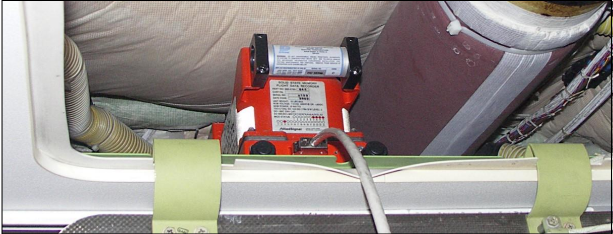
38 – Rejestrator parametrów lotu (FDR) przed wymontowaniem
