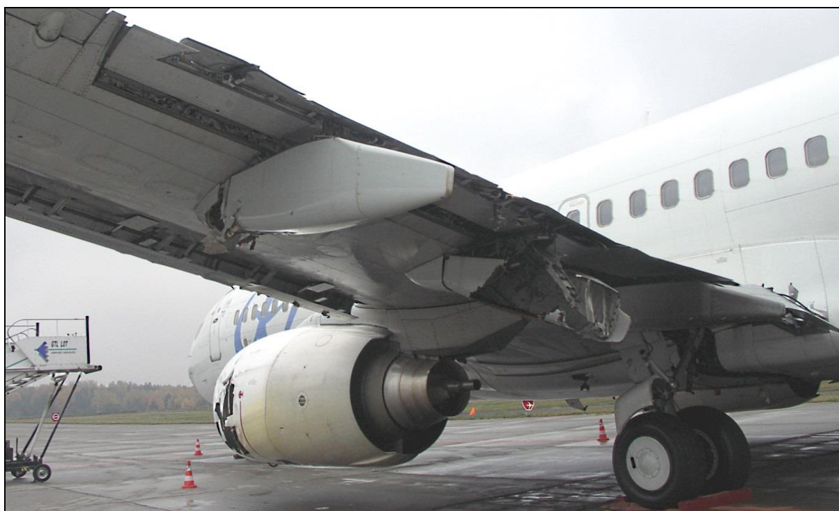
61 – Uszkodzenia lewej kłapy zewnętrznej i osłon jej prowadnic od tyłu – zbliżenie
