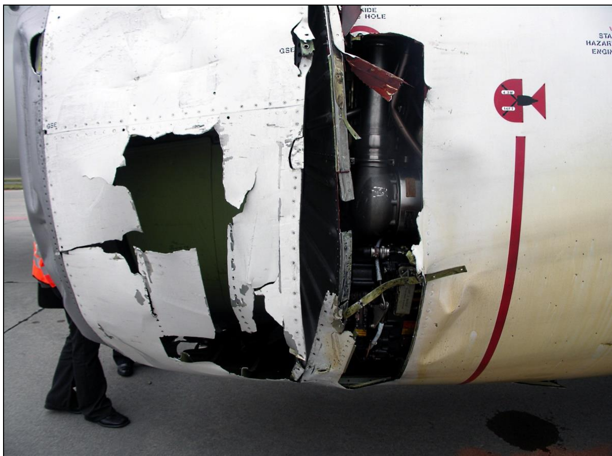
51 – Uszkodzenia lewej strony gondoli lewego silnika
