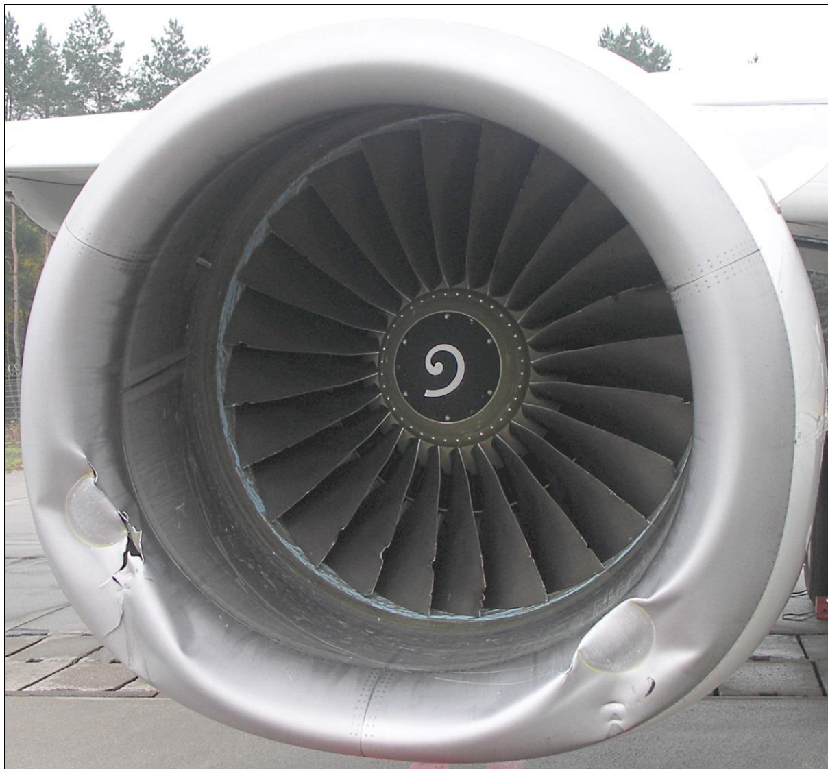
70 – Uszkodzenia wlotu prawego silnika
