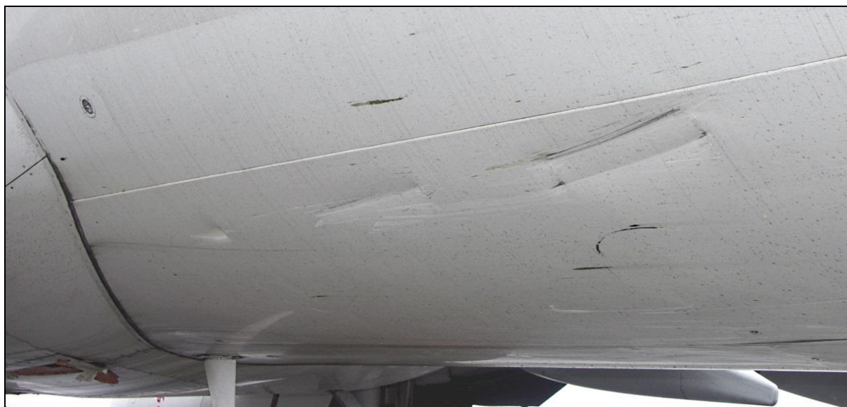
82 – Zarysowania i otarcia pokryć tylnej części kadłuba po lewej stronie – zbliżenie
