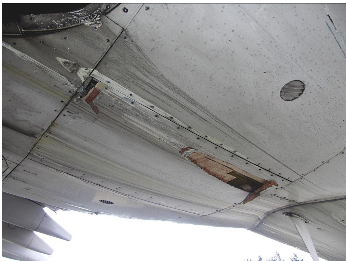
87 – Uszkodzenia owiewki podkadłubowej – zbliżenie
