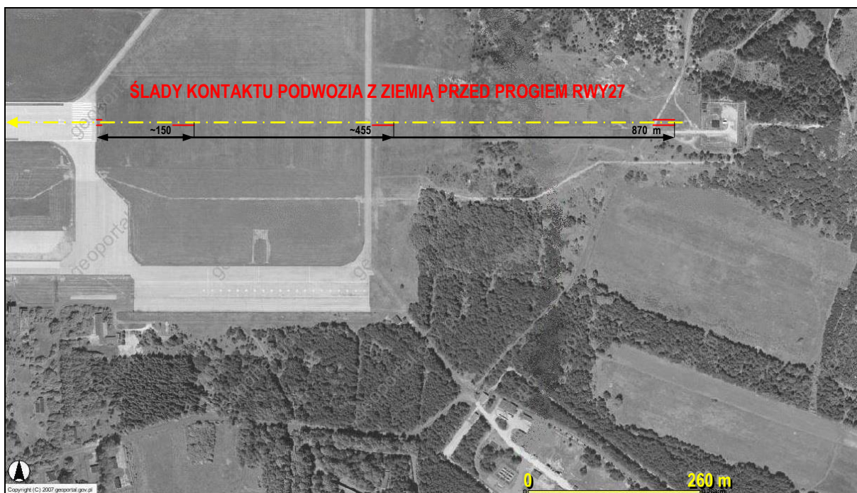
5 – Ślady lądowania przed drogą startową RWY27 lotniska EPKT [geoportal, 2007]
