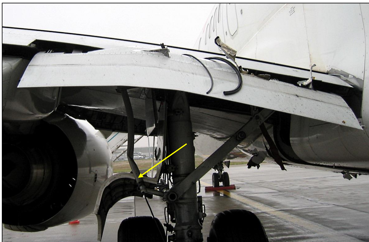
60 – Uszkodzenia lewej kłapy wewnętrznej od tyłu – zbliżenie. Zaznaczone elementy lampy wbite w konstrukcję samolotu. [foto: załoga samolotu]
