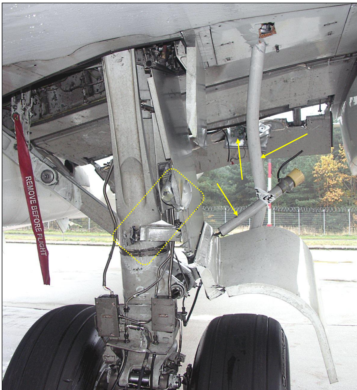
56 – Uszkodzenia pokryw lewego podwozia głównego i lewej kłapy wewnętrznej od spodu. Zaznaczone elementy lampy wbite w konstrukcję samolotu.
