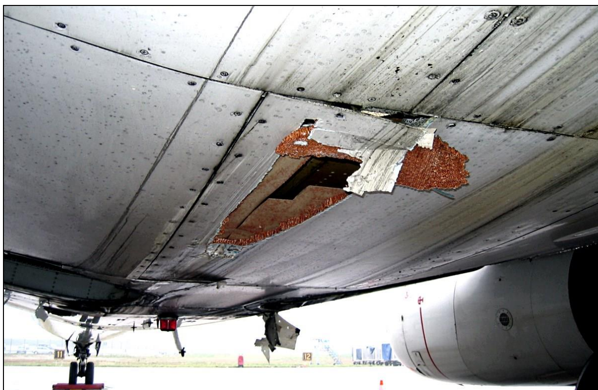
88 – Uszkodzenia owiewki podkadłubowej – zbliżenie [foto: załoga samolotu]
