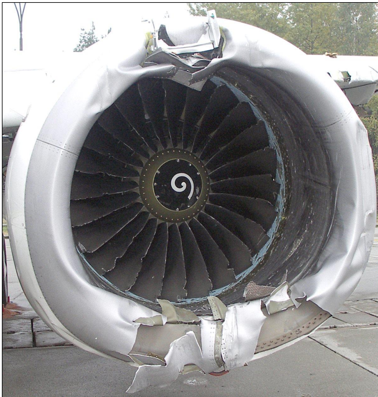
49 – Wlot powietrza do lewego silnika – widoczne uszkodzenia
