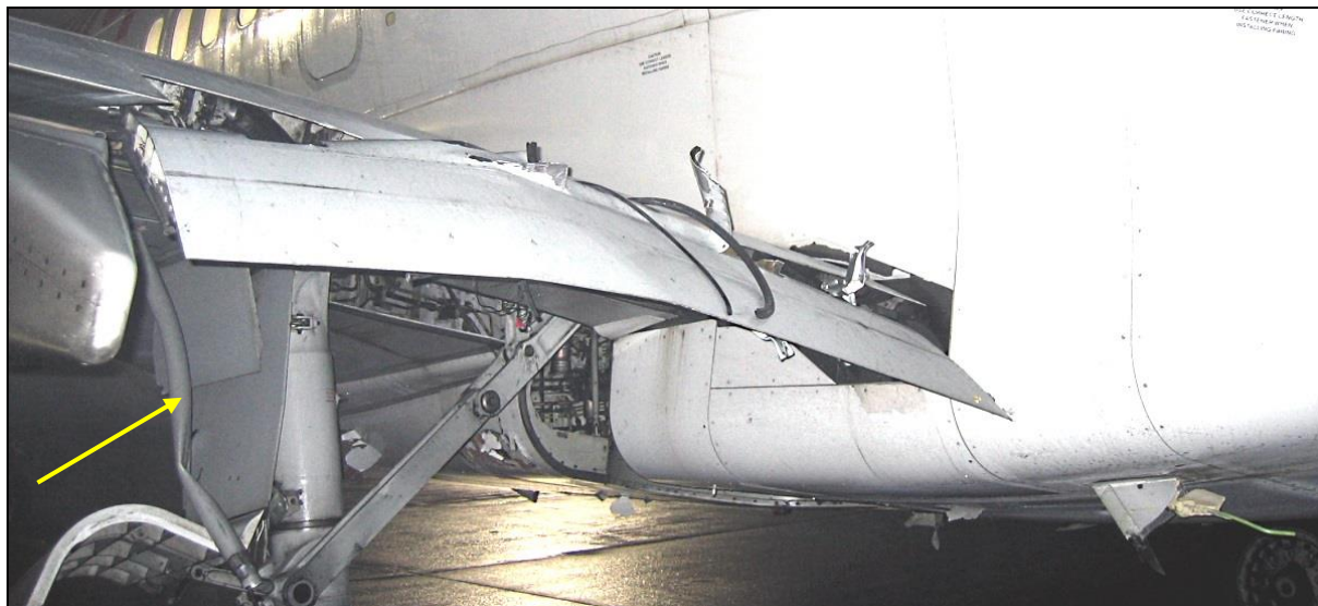
59 – Uszkodzenia pokryw lewego podwozia głównego i lewej kłapy wewnętrznej od tyłu. Zaznaczone elementy lampy wbite w konstrukcję samolotu. [foto: załoga samolotu]
