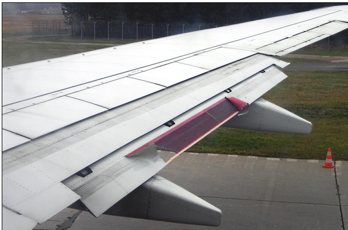
78 – Uszkodzona prawa kłapa zewnętrzna – widok z góry
