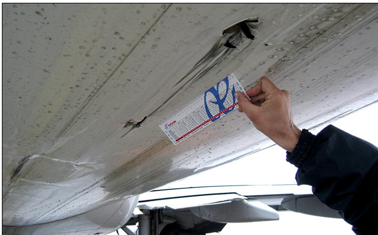
89 – Uszkodzenia dolnego pokrycia kadłuba – zbliżenie [foto: załoga samolotu]
