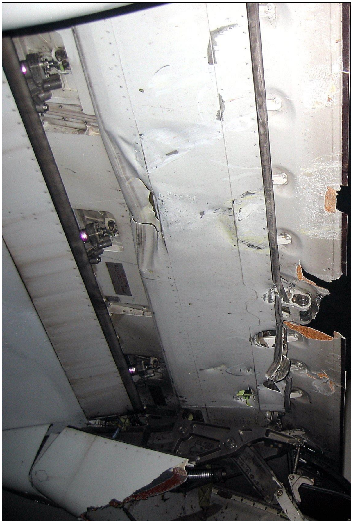
57 – Uszkodzenia lewej kłapy zewnętrznej od spodu – zbliżenie [foto: załoga samolotu].
