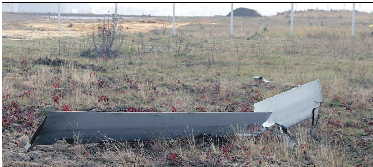
13 – Oderwany spływowy fragment lewej kłapy zewnętrznej
