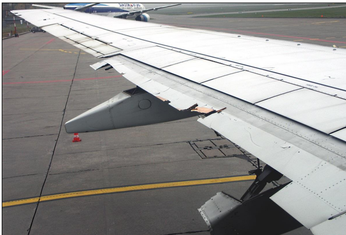
64 – Widok z góry na uszkodzoną lewą kłapę zewnętrzną. Widoczny fragment uszkodzonej osłony prowadnicy kłapy
