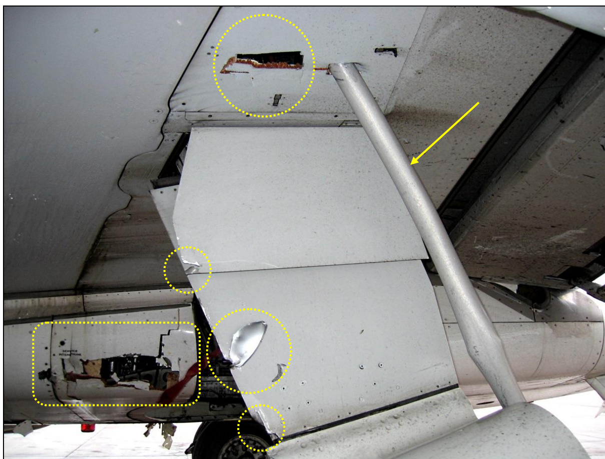
83 – Uszkodzenia pokryw lewego podwozia głównego i owiewki podkadłubowej. Zaznaczony element lampy wbity w konstrukcję samolotu [foto: załoga samolotu].
