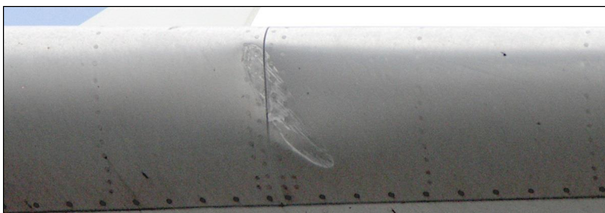
92 – Uszkodzenia noska lewego statecznika poziomego – zbliżenie
