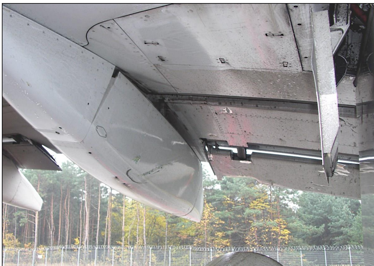
80 – Uszkodzona prawa kłapa wewnętrzna – widok od spodu
