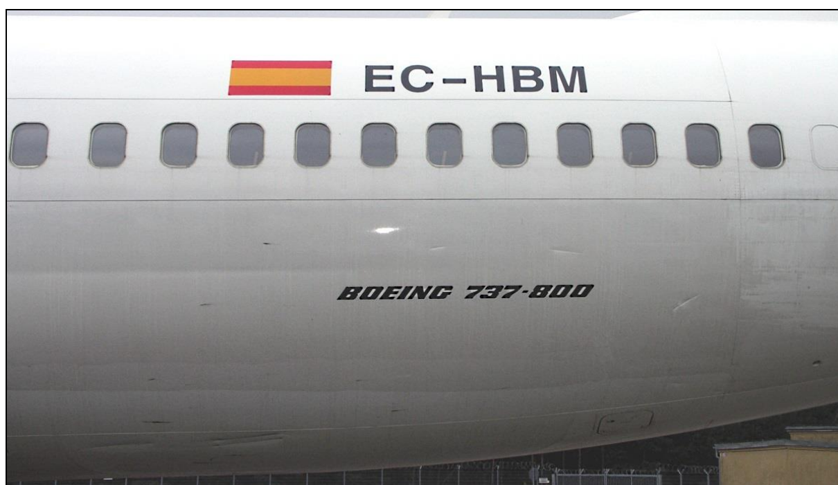
81 – Zarysowania i otarcia pokryć tylnej części kadłuba po lewej stronie
