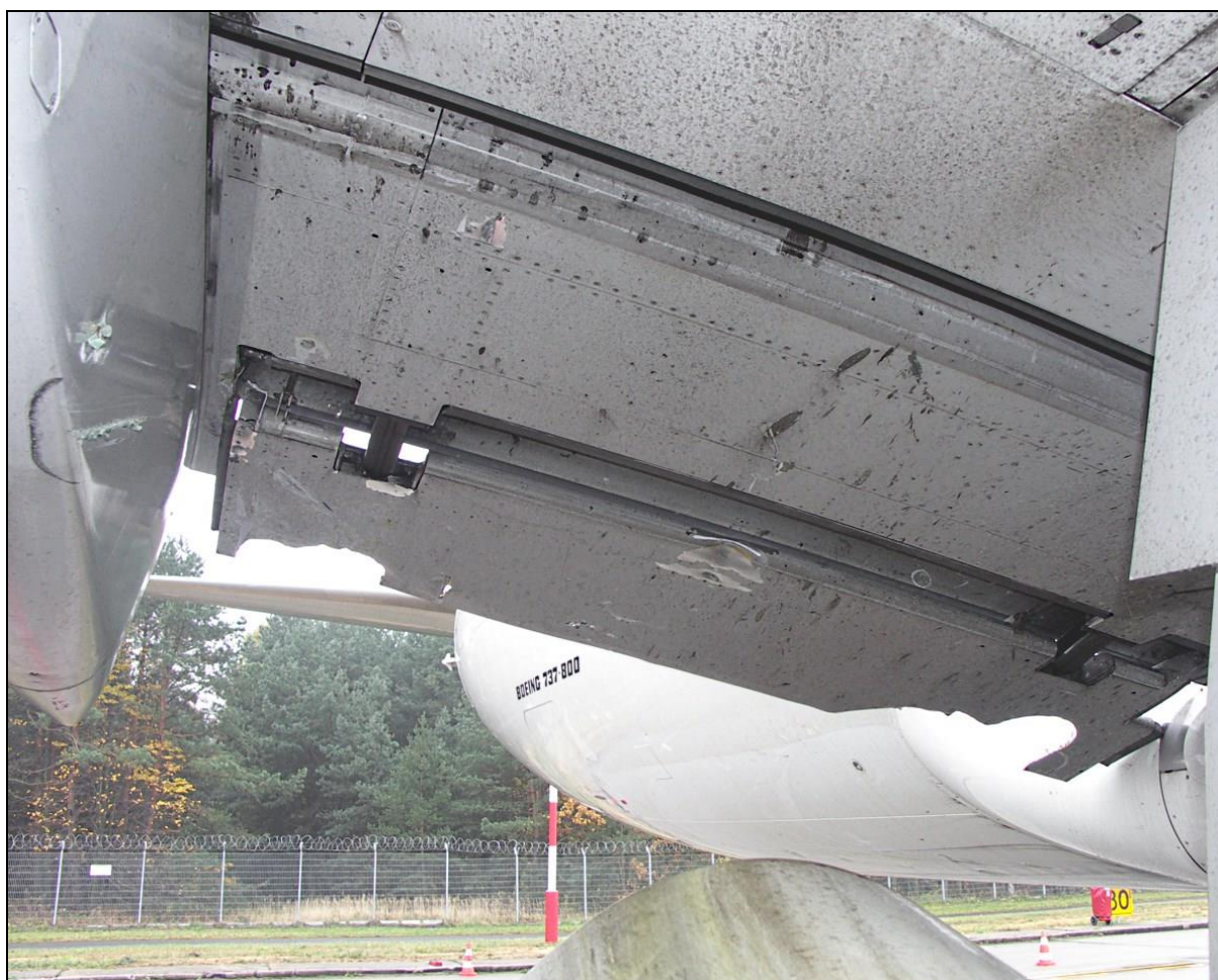
79 – Uszkodzona prawa kłapa wewnętrzna – widok od spodu
