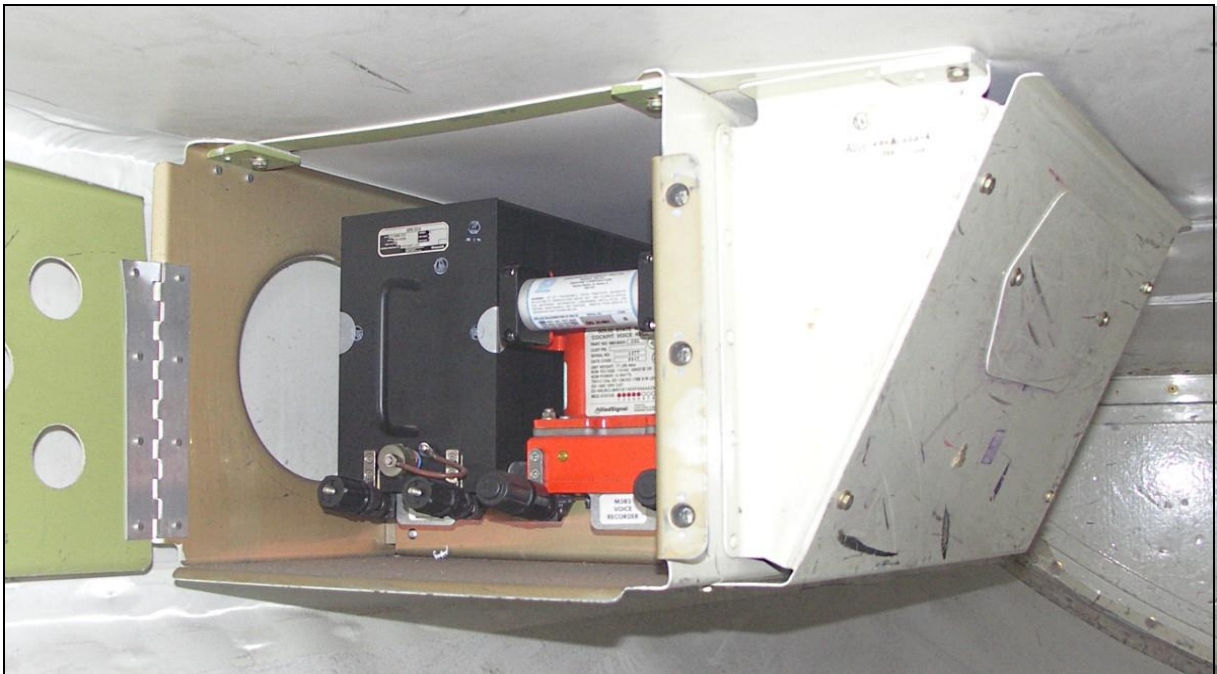
39 – Rejestrator dźwięków w kokpicie (CVR) przed wymontowaniem
