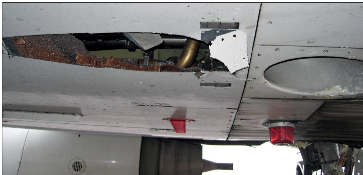
84 – Uszkodzenia owiewki podkadłubowej – zbliżenie [foto: załoga samolotu]
