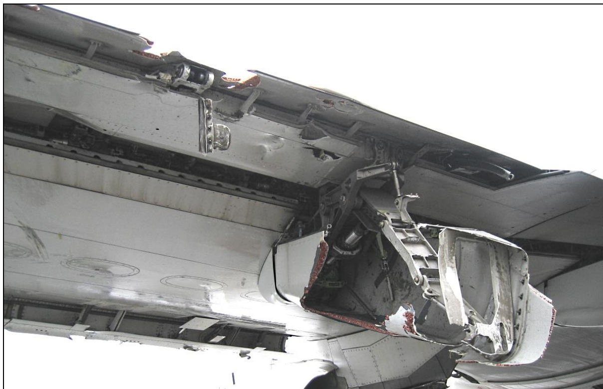
63 – Uszkodzenia osłony prowadnicy lewej kłapy zewnętrznej; widoczne uszkodzenia kłapy [foto: załoga samolotu]
