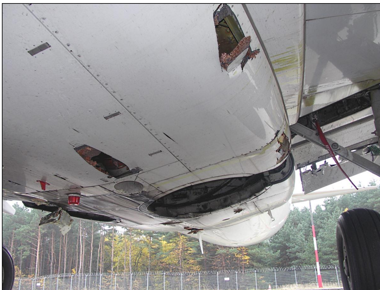
85 – Uszkodzenia owiewki podkadłubowej – zbliżenie [foto: załoga samolotu]
