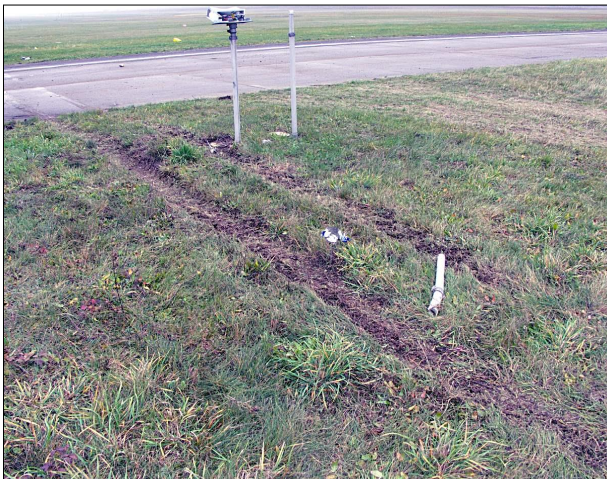
21 – Ślady kół lewego podwozia głównego przy poprzecznej drodze kołowania przed progiem RWY27 lotniska EPKT
