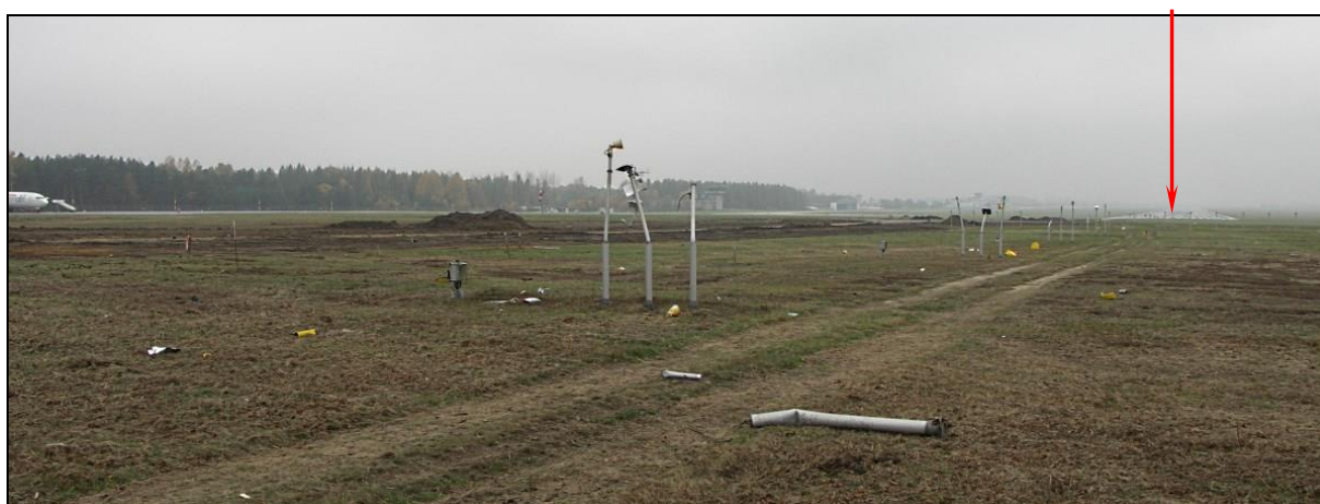
23 – Zniszczenia świateł podejścia i drobne szczątki pokrycia samolotu. Widoczny próg RWY27
