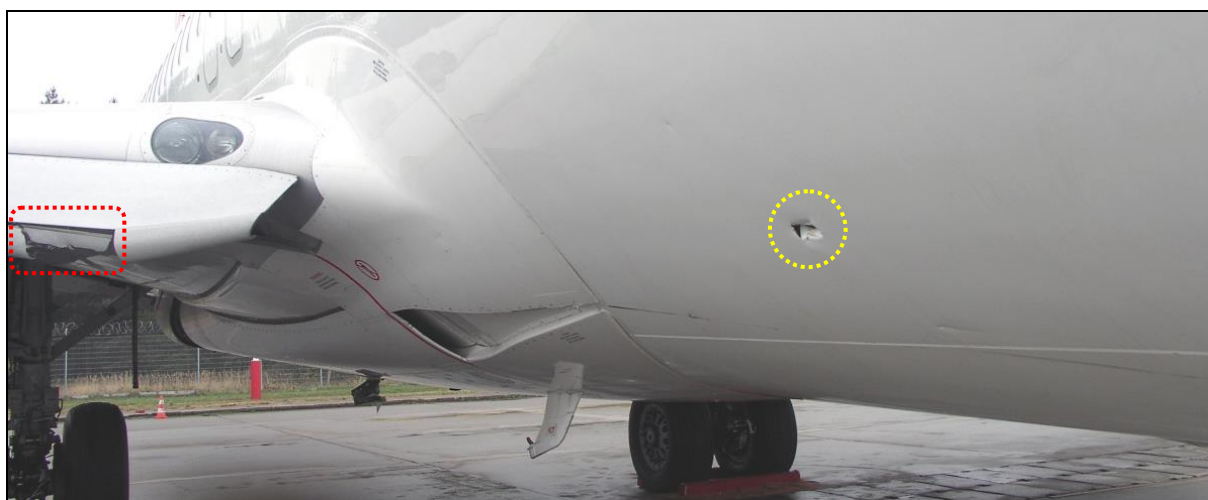
66 – Rejon nasady prawego skrzydła – widoczne uszkodzenie kłapy Krügera i przebicie kadłuba
