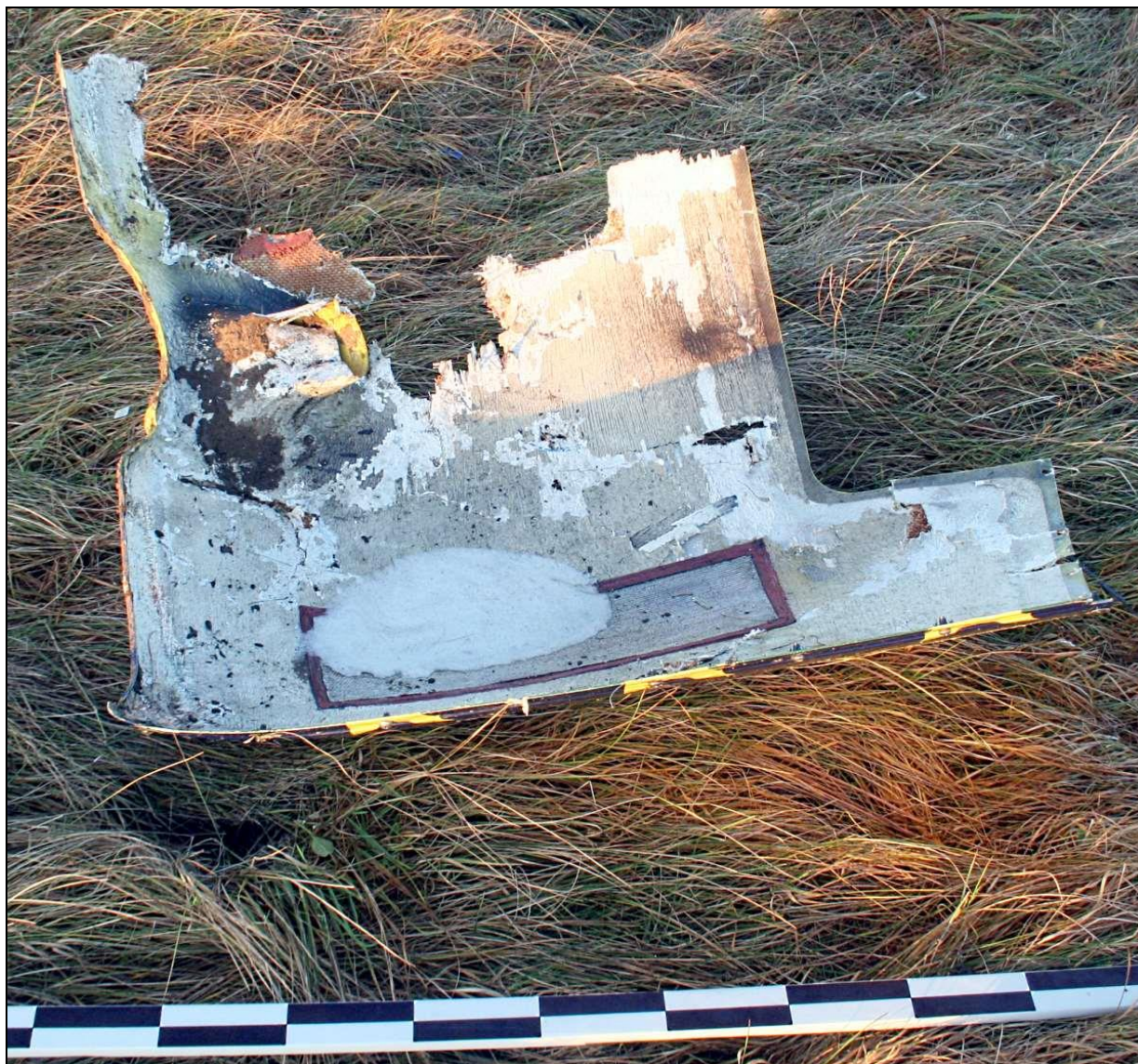
26 – Dolna osłona silnika [foto: KMP Koszalin]
