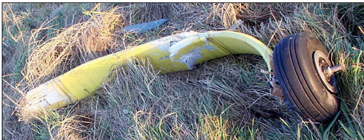
16 – Odłamana goleń prawego podwozia głównego z kołem [foto: KMP Koszalin]
