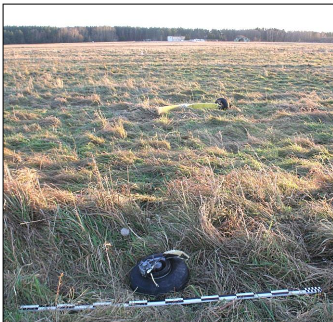
18 – Oderwane podwozie główne [foto: KMP Koszalin]
