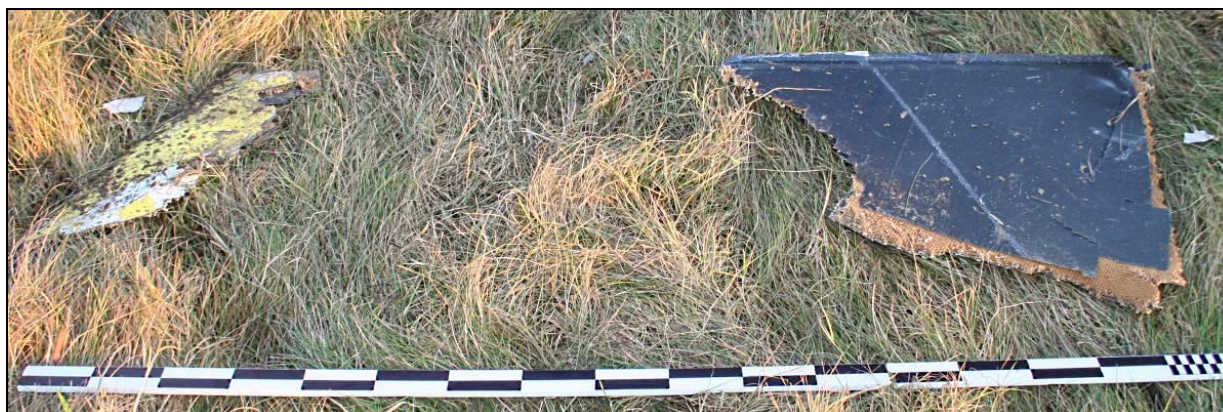
27 – Szczątki kompozytowych pokryć kadłuba [foto: KMP Koszalin]
