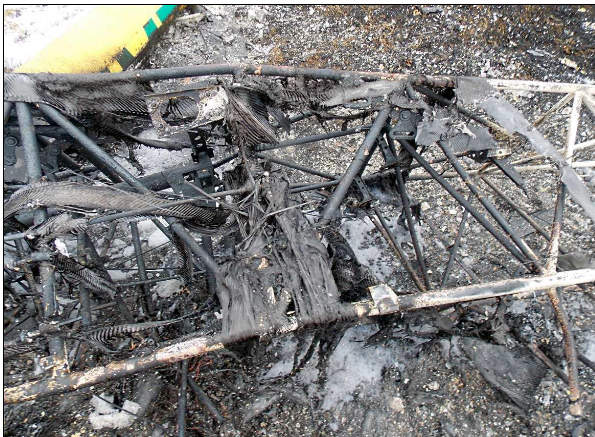
42 – Prawy bok kratownicy środkowej części kadłuba – zbliżenie.
