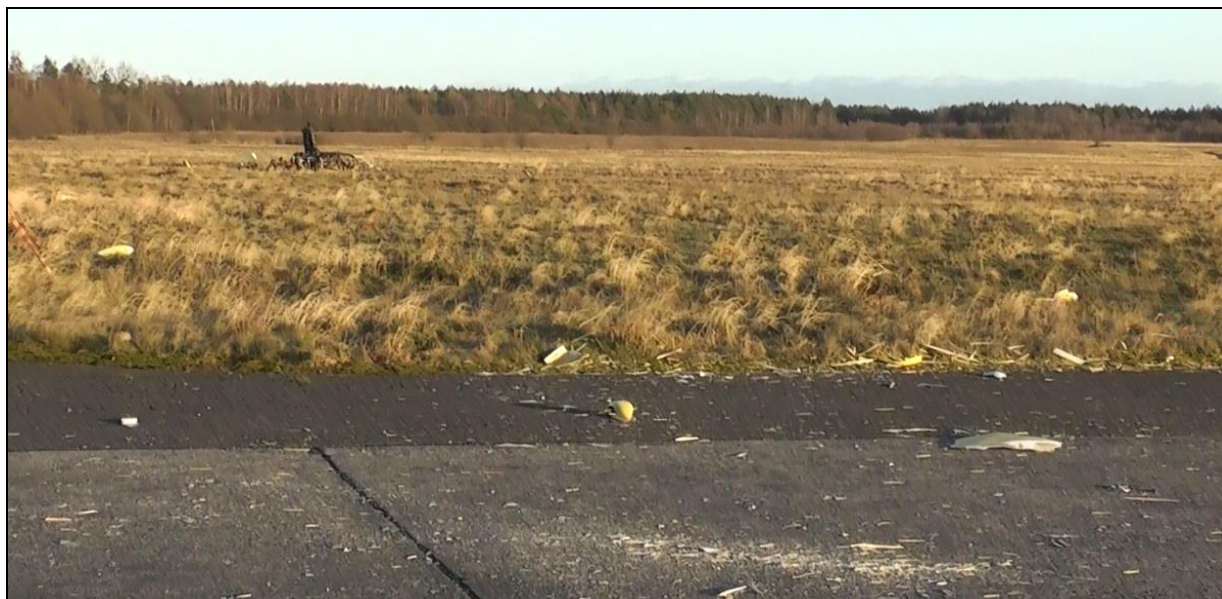
12 – Ślady zderzenia z ziemią, widoczne rozsypane drobne szczątki łopat śmigła i dolnej osłony silnika oraz oszklenia osłony kabiny [foto: KMP Koszalin]
