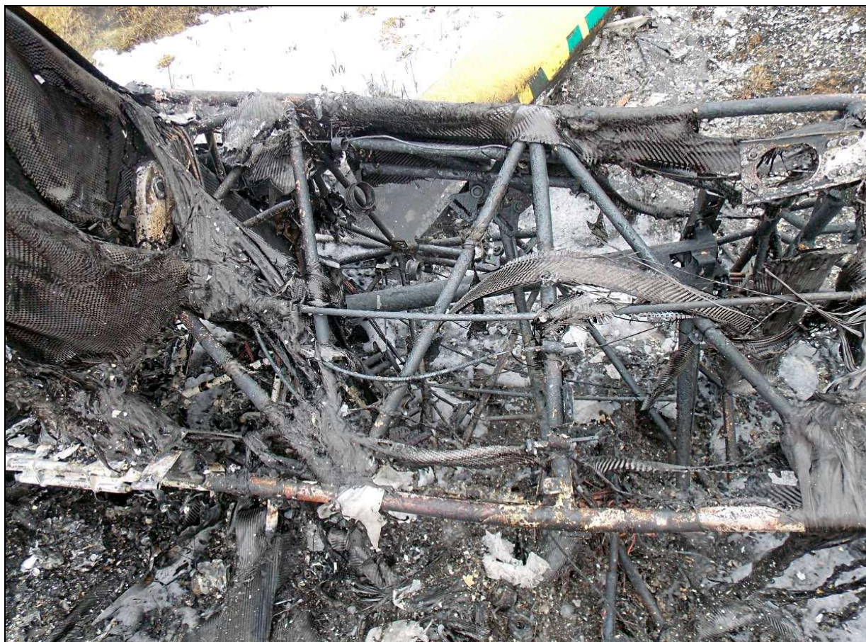
41 – Prawy bok kratownicy przedniej części kadłuba – zbliżenie.
