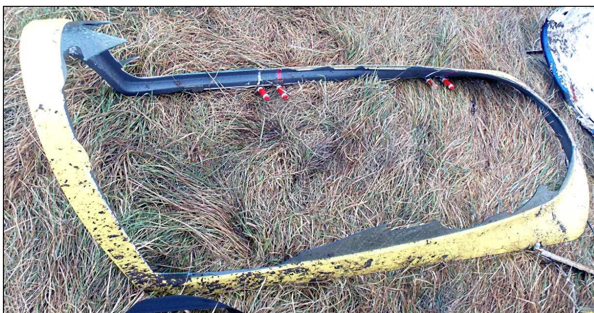
46 – Rama osłony kabiny z resztkami oszklenia.
