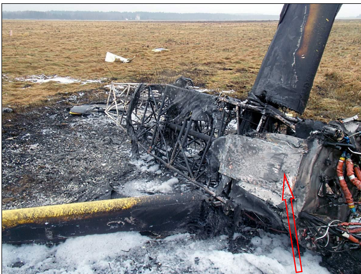
37 – Widok na spód kratownicy kadłuba. Strzałką wskazane ślady kontaktu konstrukcji kadłuba z twardym podłożem.
