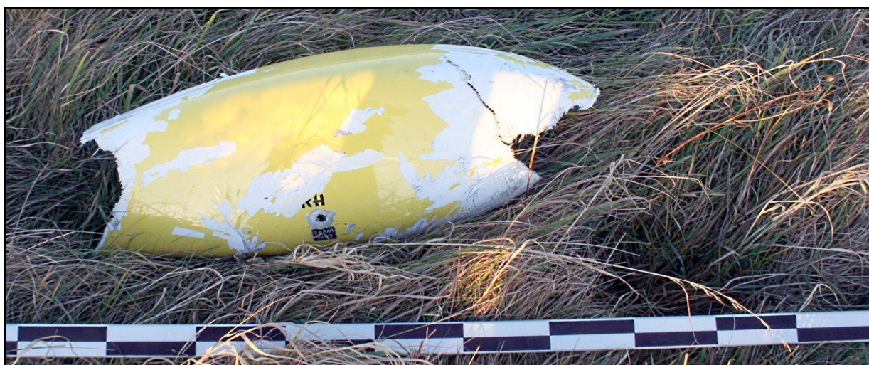
14 – Zniszczona owiewka prawego koła podwozia głównego [foto: KMP Koszalin]
