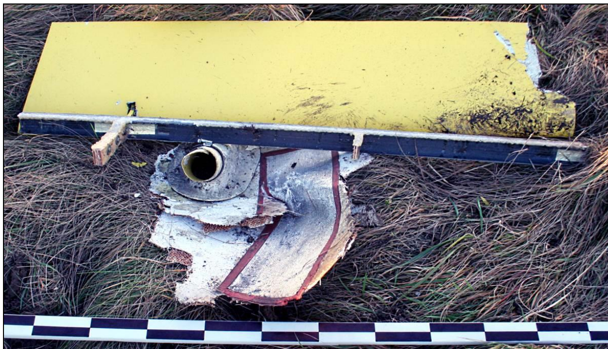
24 – Oderwana część lotki z fragmentem tylnego dźwigarka skrzydła [foto: KMP Koszalin]
