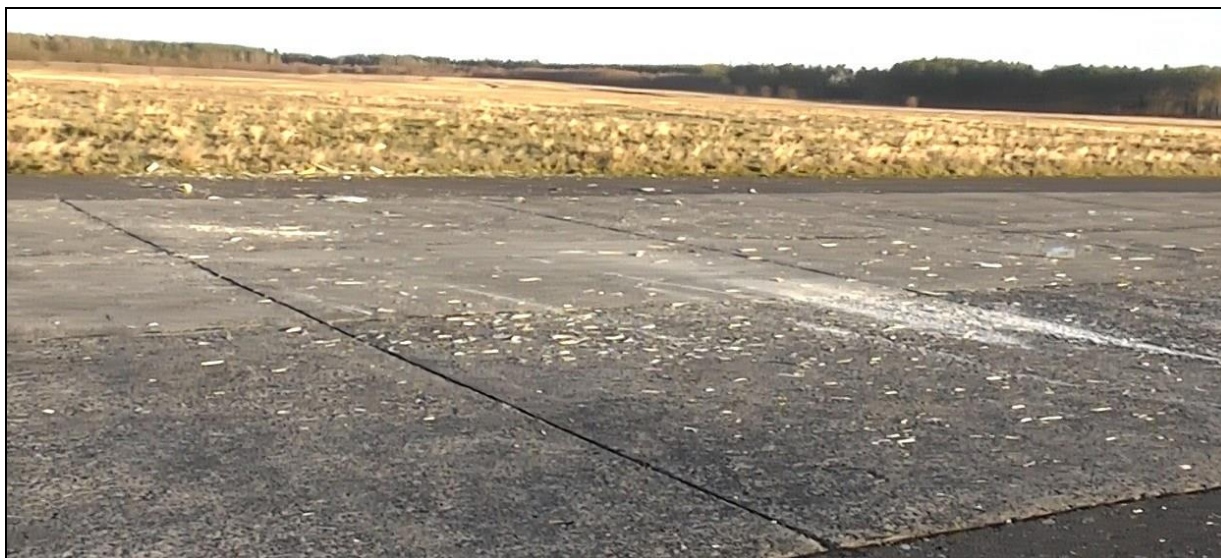
9 – Ślady zderzenia z ziemią, widoczne rozsypane drobne szczątki łopat śmigła i dolnej osłony silnika. [foto: KMP Koszalin]
