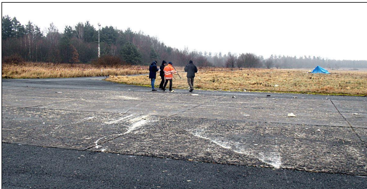
6 – Ślad pierwszego kontaktu samolotu z ziemią na granicy nawierzchni asfaltowej i betonowej drogi dojazdowej, widok w kierunku zbliżonym do kierunku lotu.
