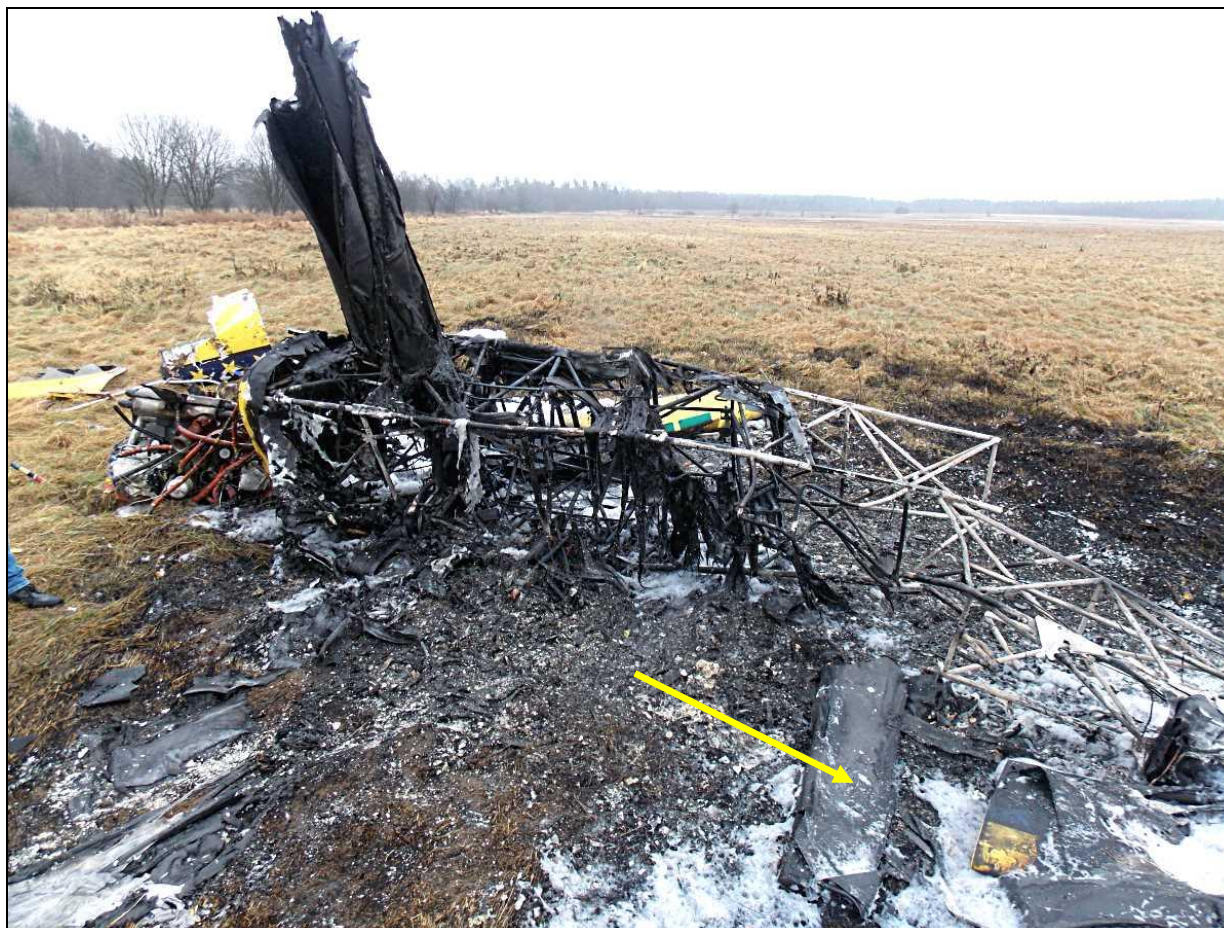
32 – Widok na grzbiet i prawy bok kratownicy kadłuba. Strzałką wskazane szczątki usterzenia.
