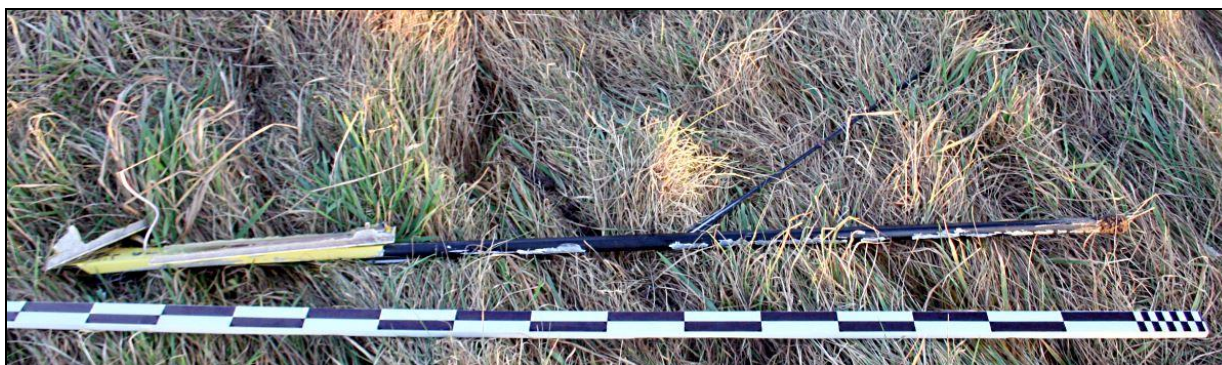
20 – Końcowe żebro prawego skrzydła ze wskaźnikiem położenia dla pilota [foto: KMP Koszalin]
