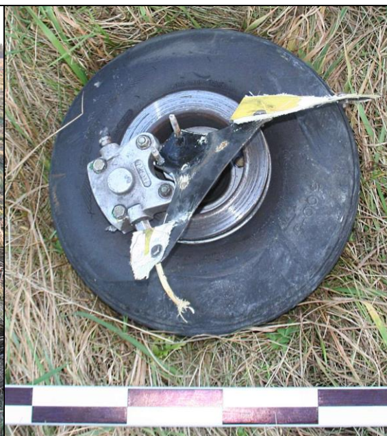
19 – Oderwane lewe koło podwozia głównego [foto: KMP Koszalin]
