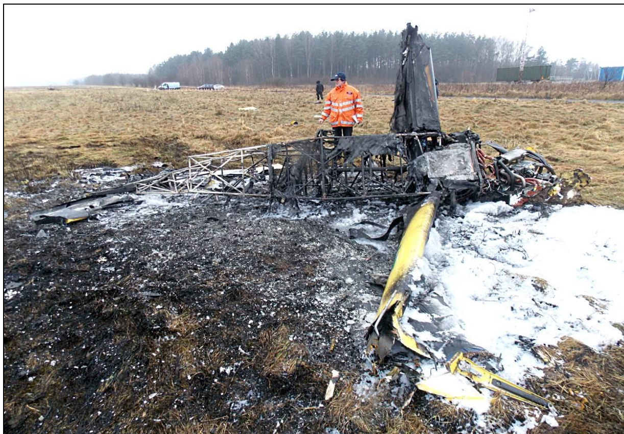
28 – Wrak samolotu, widok w kierunku przeciwnym do kierunku lotu. Kadłub został odwrócony z pozycji plecowej podczas akcji ratowania pilota.
