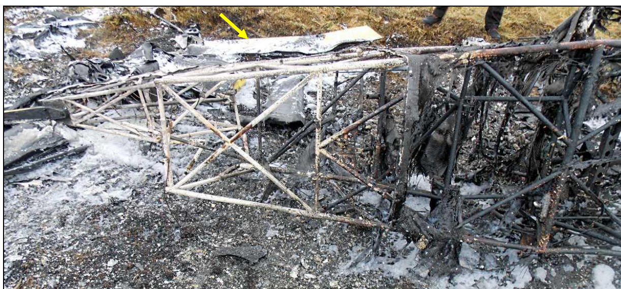
35 – Widok na spód kratownicy tylnej części kadłuba. Widoczne szczątki usterzenia. Strzałką wskazana oderwana lotka skrzydła.
