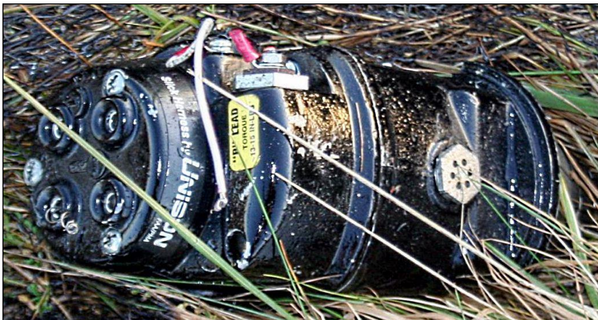
48 – Oderwany iskrownik [foto: KMP Koszalin]
