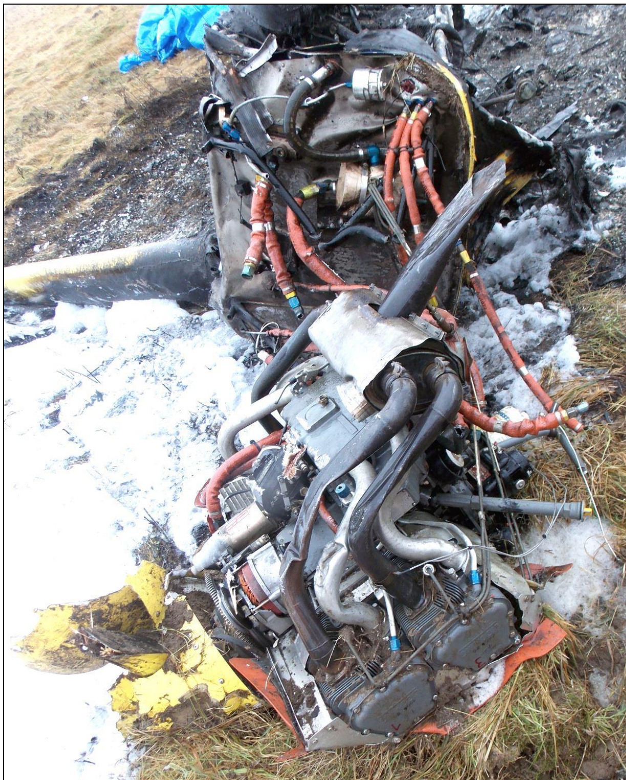
40 – Zespół napędowy oderwany od kadłuba – zbliżenie.
