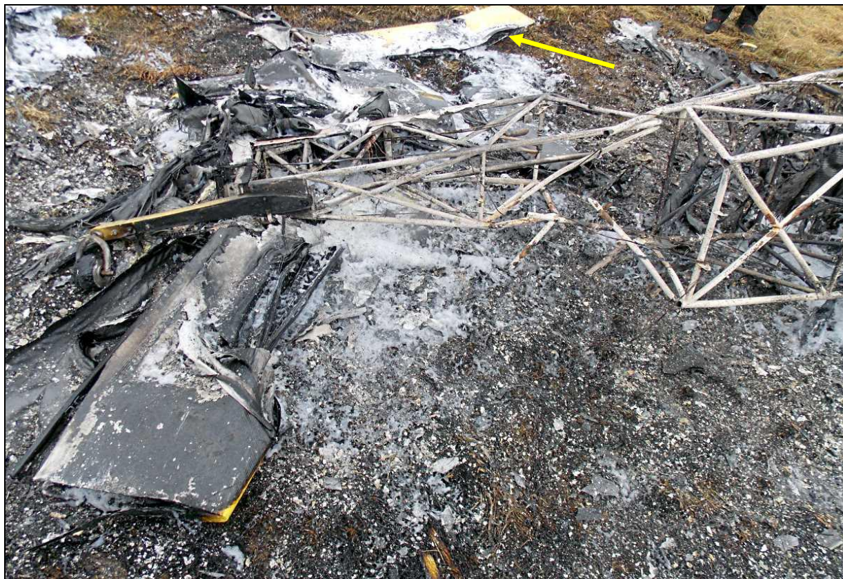
34 – Widok na spód i prawy bok kratownicy tylnej części kadłuba. Widoczne szczątki usterzenia. Strzałką wskazana oderwana lotka skrzydła.
