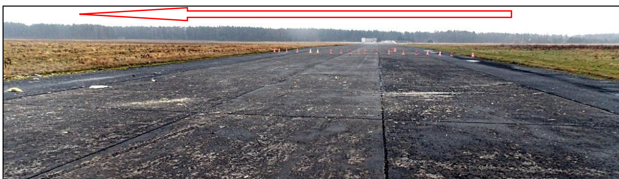
8 – Ślady zderzenia z ziemią, widoczne rozsypane drobne szczątki łopat śmigła i dolnej osłony silnika. Widok w kierunku w przybliżeniu prostopadłym do kierunku lotu, wskazanego strzałką.
