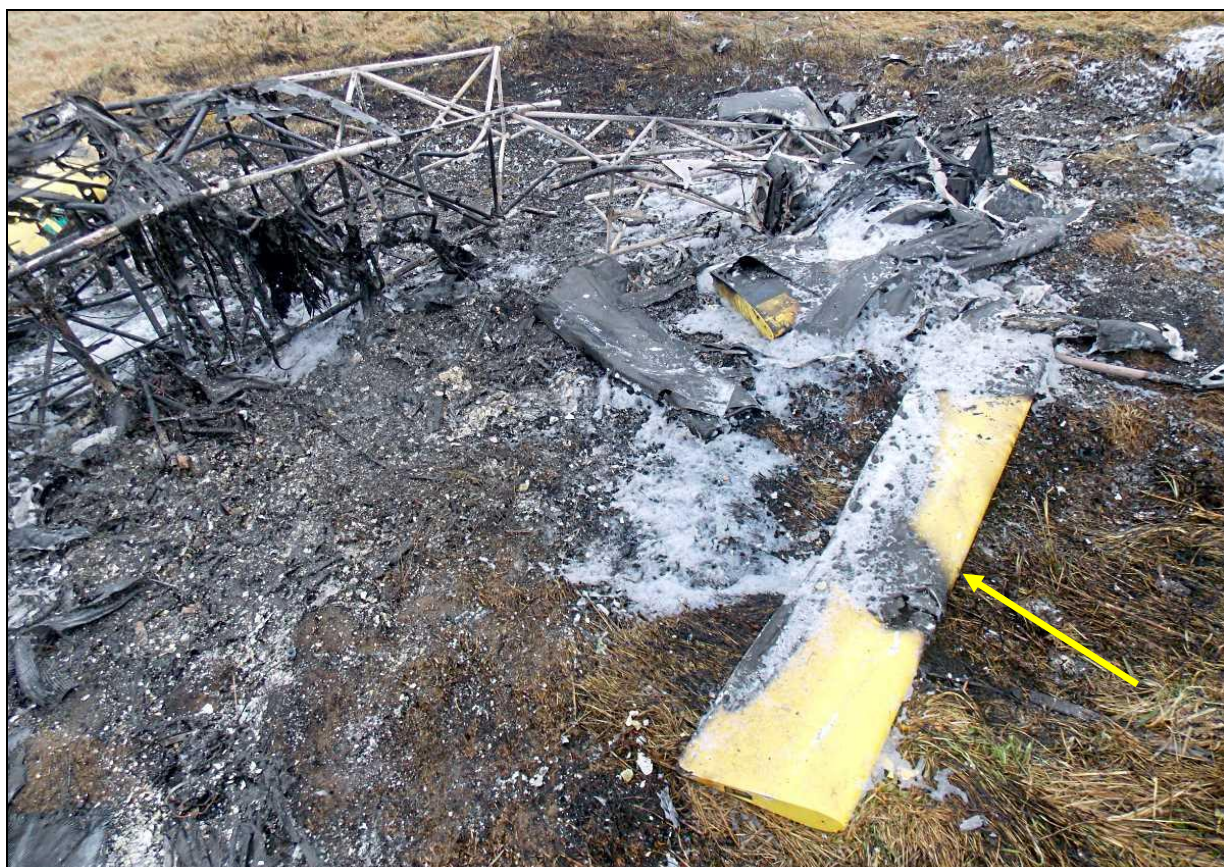
33 – Widok na grzbiet i prawy bok kratownicy tylnej części kadłuba. Widoczne szczątki usterzenia. Strzałką wskazana oderwana lotka skrzydła.
