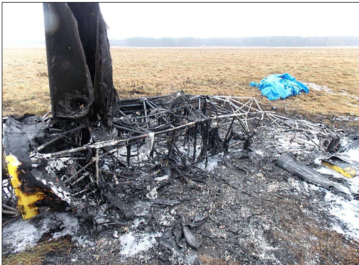
30 – Widok na grzbiet i prawy bok kratownicy kadłuba, z prawej strony kadru zniszczone usterzenie.
