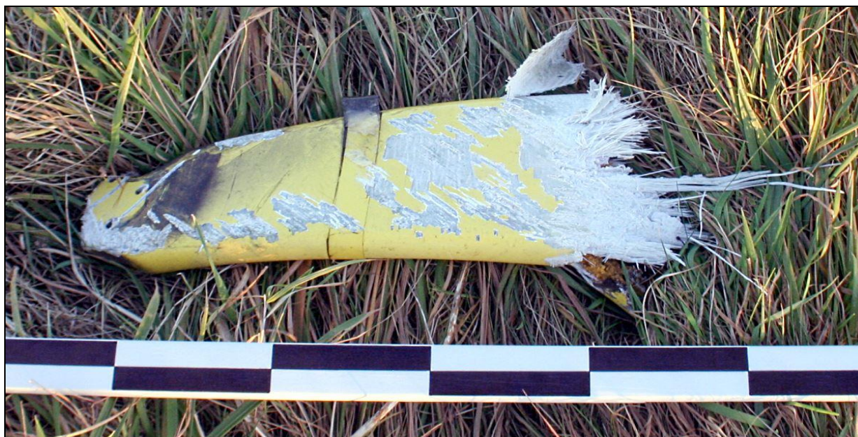
17 – Odłamany dolny fragment lewej goleni podwozia głównego [foto: KMP Koszalin]
