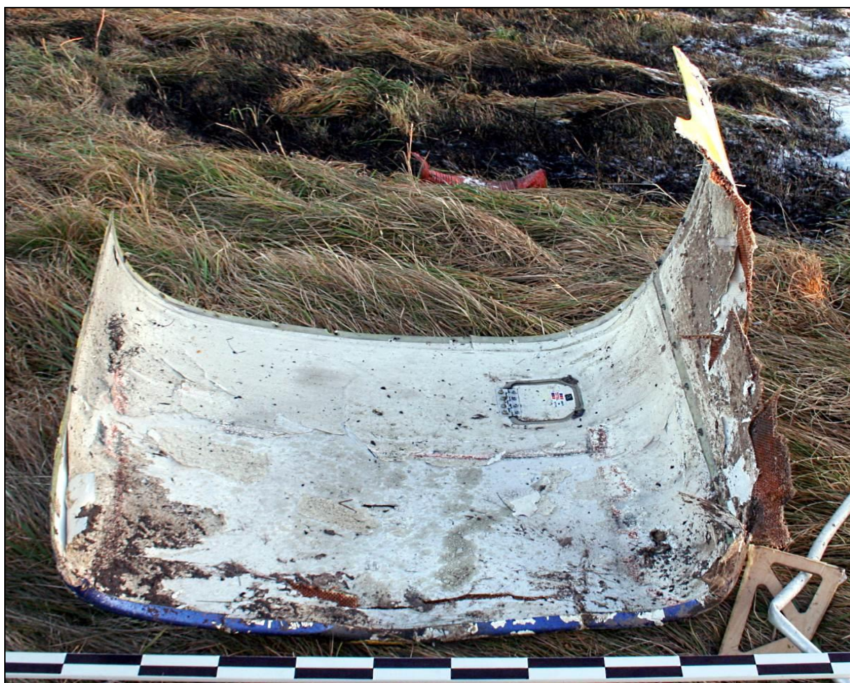
45 – Górna osłona silnika [foto: KMP Koszalin]
