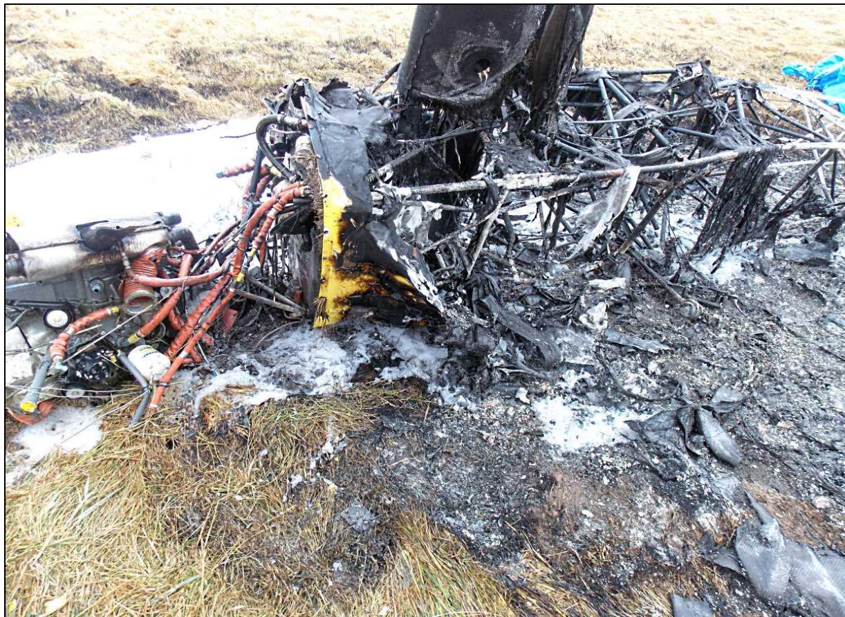
29 – Widok na zespół napędowy oraz grzbiet i prawy bok kratownicy przedniej części kadłuba.
