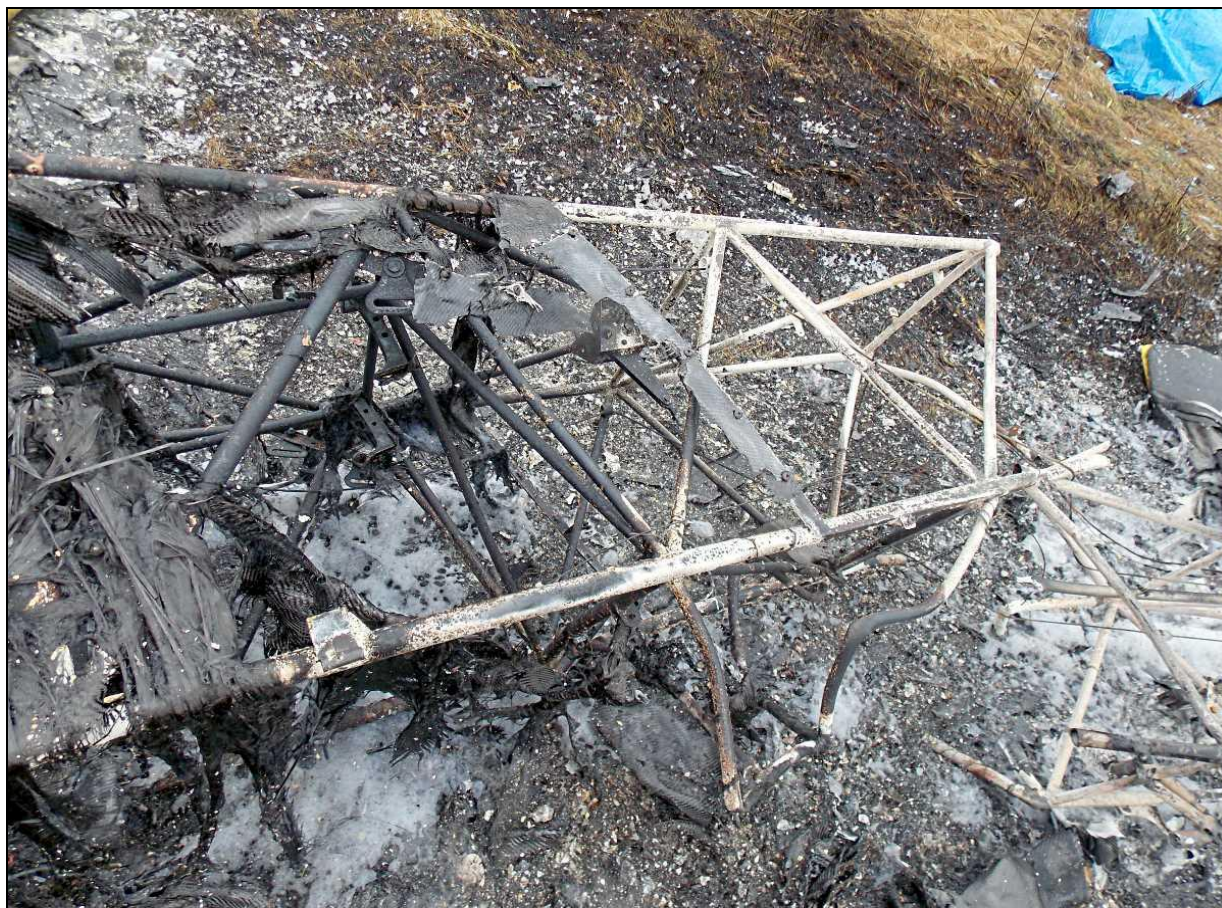
43 – Prawy bok kratownicy tylnej części kadłuba – zbliżenie.
