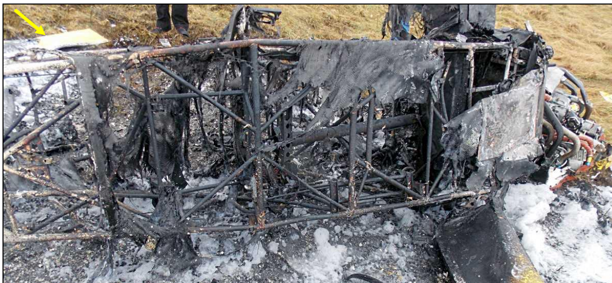
36 – Widok na spód kratownicy środkowej i przedniej części kadłuba. Strzałką wskazana oderwana lotka skrzydła.
