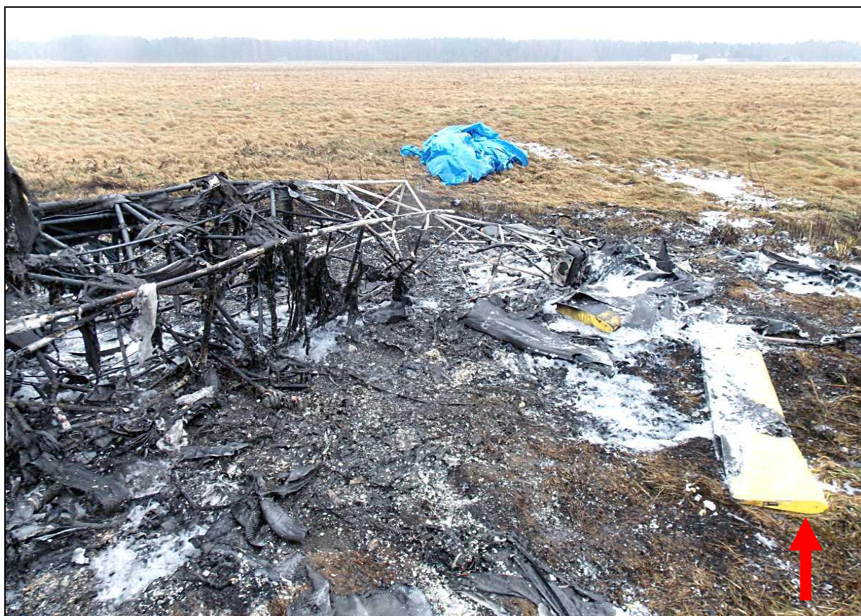
31 – Widok na grzbiet i prawy bok kratownicy tylnej części kadłuba. Widoczne szczątki usterzenia. Strzałką wskazana oderwana lotka skrzydła.
