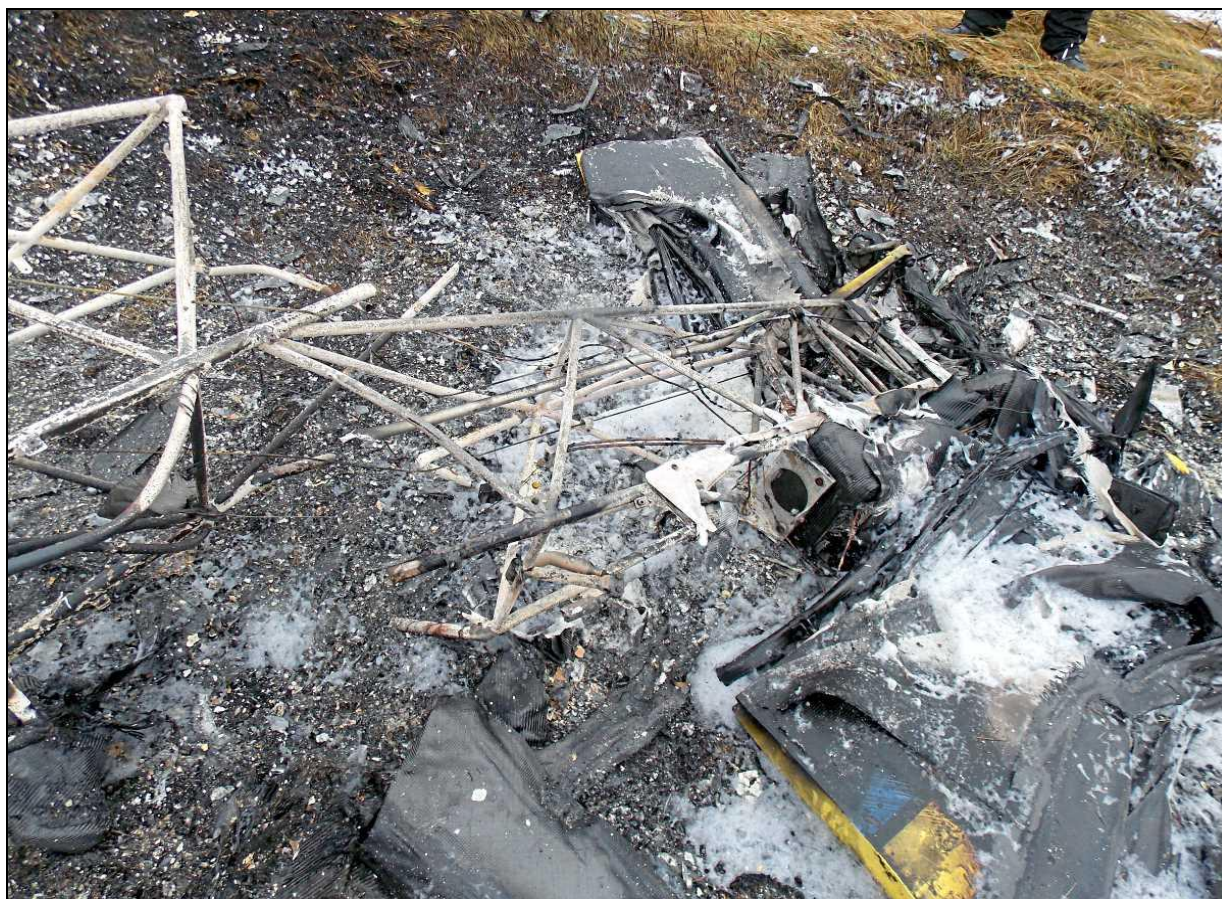
44 – Odłamany fragment tylnej części kratownicy kadłuba i szczątki usterzenia – zbliżenie.
