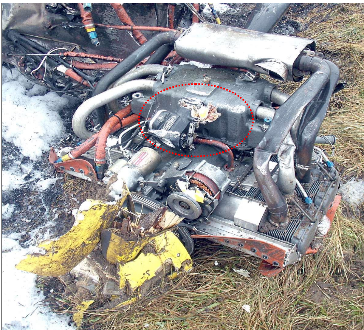
39 – Zespół napędowy. Zaznaczone ślady kontaktu silnika z twardym podłożem.
