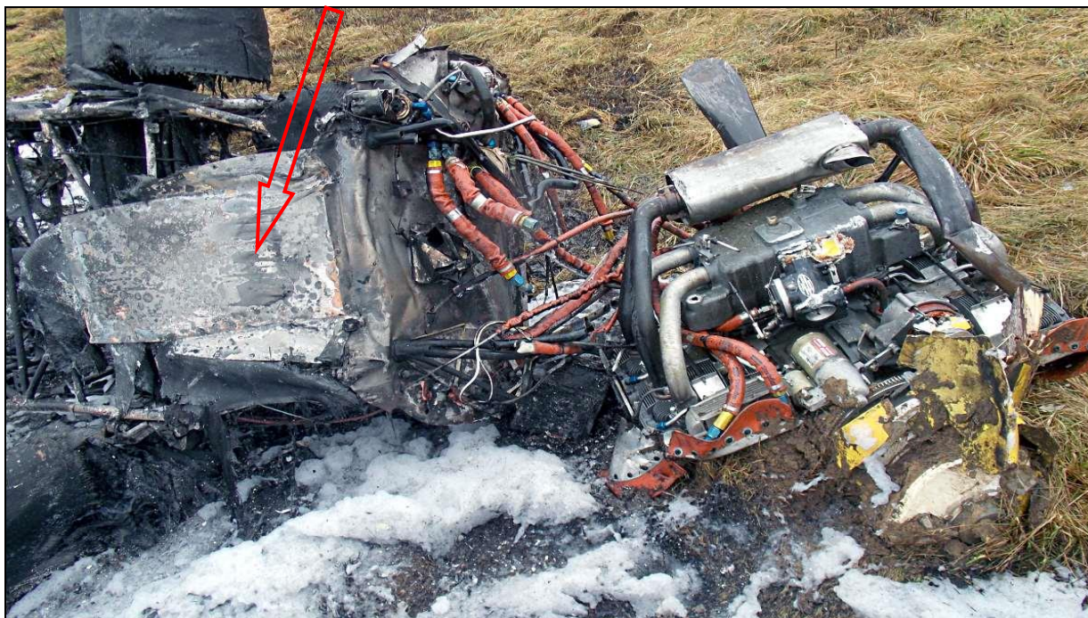
38 – Widok na spód kratownicy przedniej części kadłuba i zespół napędowy. Strzałką wskazane ślady kontaktu konstrukcji kadłuba z twardym podłożem.
