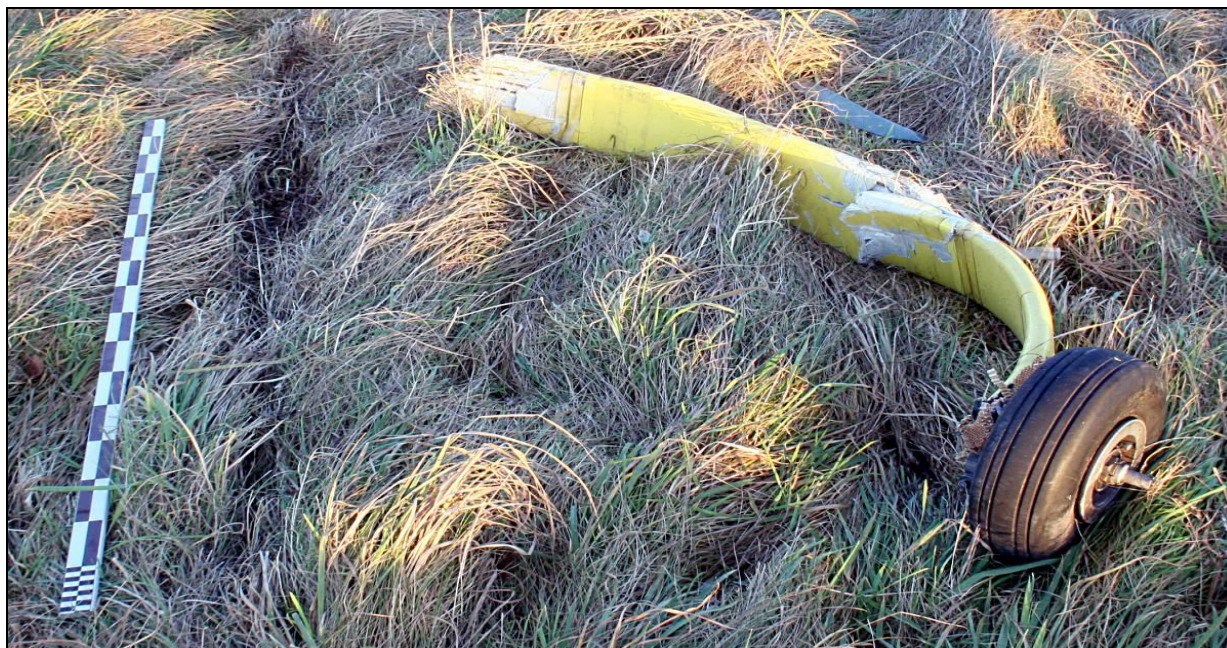
15 – Odłamana goleń prawego podwozia głównego z kołem [foto: KMP Koszalin]
