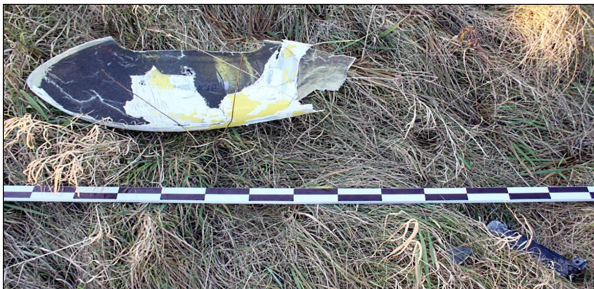
13 – Zniszczona owiewka lewego koła podwozia głównego [foto: KMP Koszalin]
