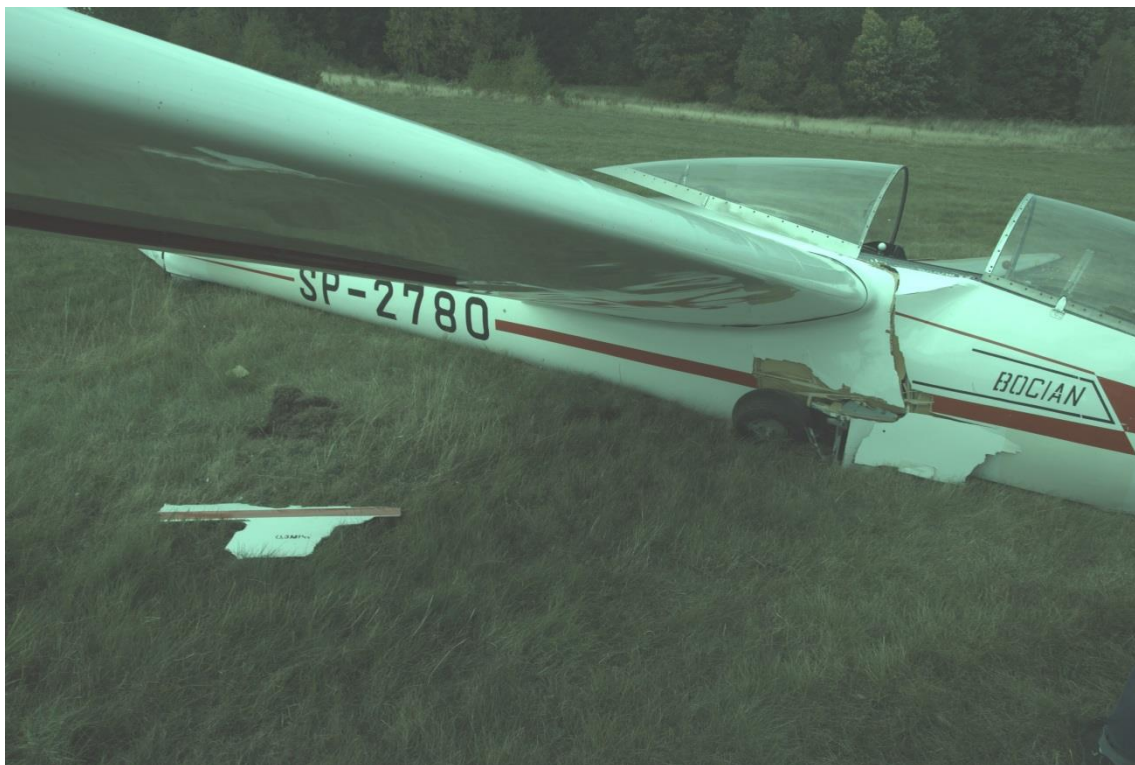
Fot. 1 Uszkodzenia podwozia i kadłuba szybowca(zdjęcie przesłane przez Aeroklub Jeleniogórski)
