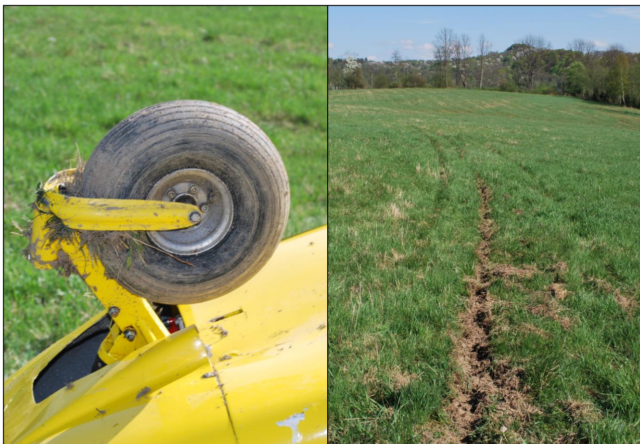
Ilustracja 2. Złamany widelec koła przedniego i bruzda w gruncie na końcu dobiegu. [foto Policja]
