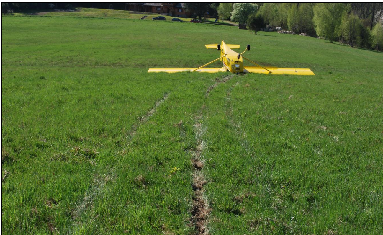
Ilustracja 3. Ślady końcowej fazy dobiegu i widok samolotu po kapotażu. [foto Policja]
