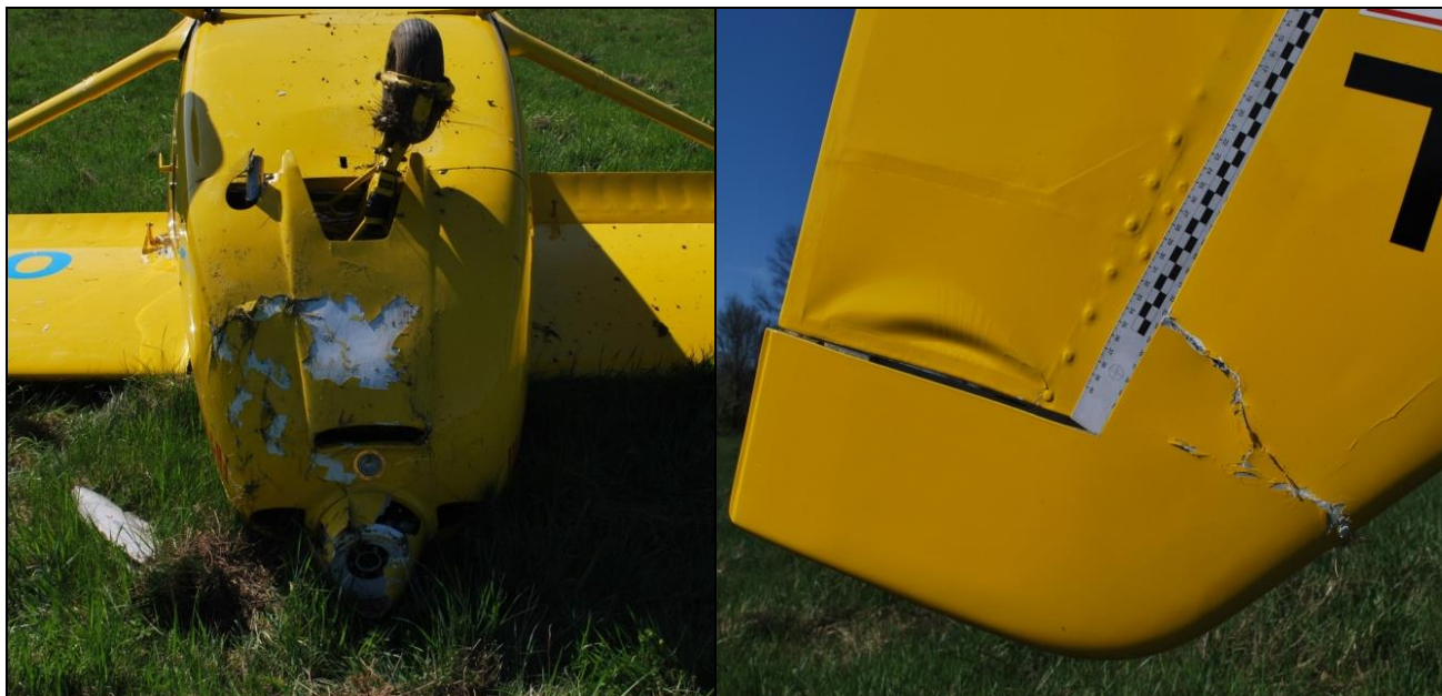
Ilustracja 5. Zdjęcie po lewej - uszkodzenia nosowej części samolotu. Widoczne zniszczenie zespołu śmigła, uszkodzenia dolnej osłony silnika oraz przedniej goleni. Zdjęcie po prawej - uszkodzenia statecznika pionowego i steru kierunku). [foto Policja]
