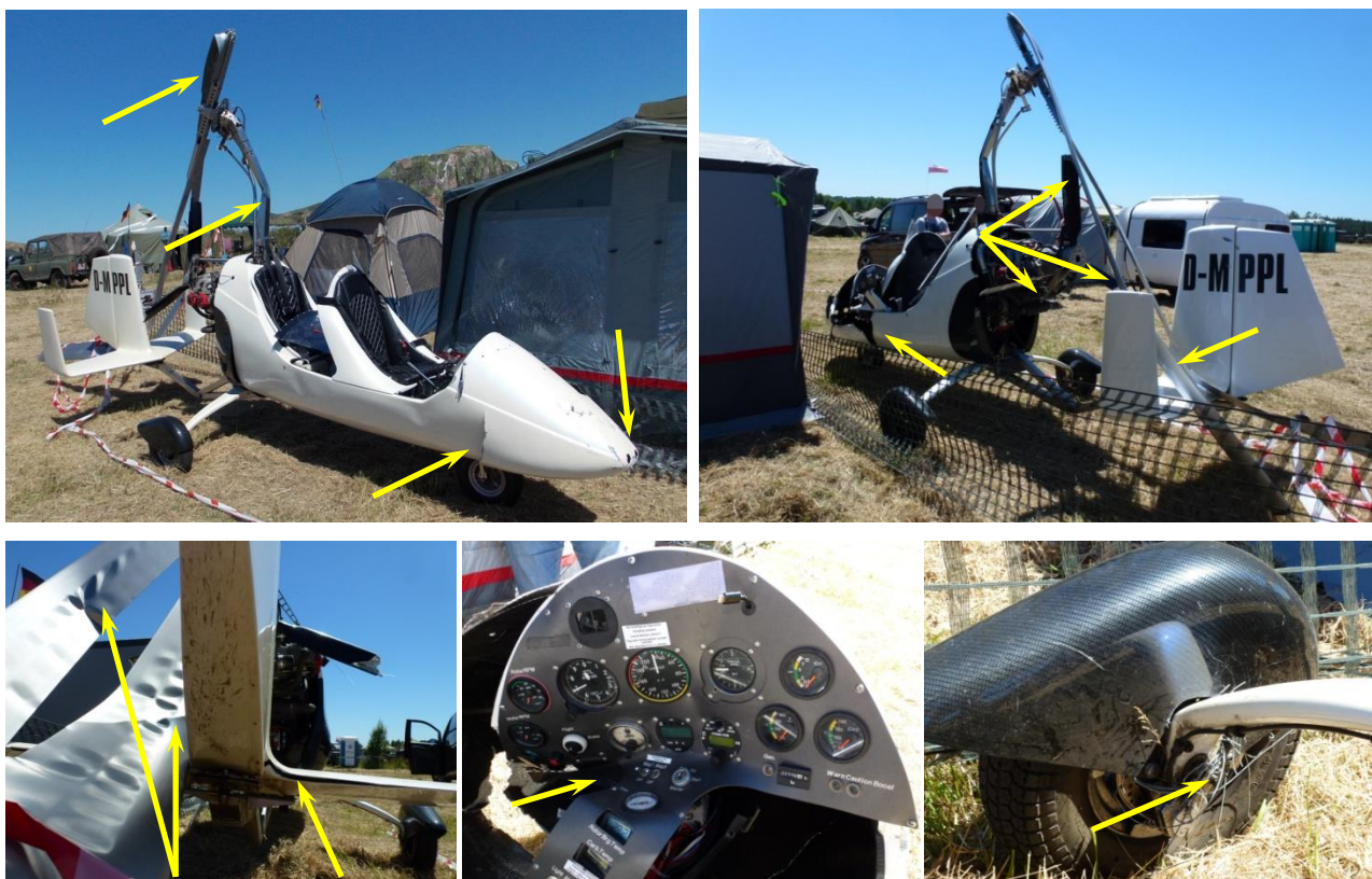
Fot. 3, 4, 5, 6, 7. Uszkodzenia wiatrakowca MT-03 D-MPPL [zdjęcia: PKBWL].
