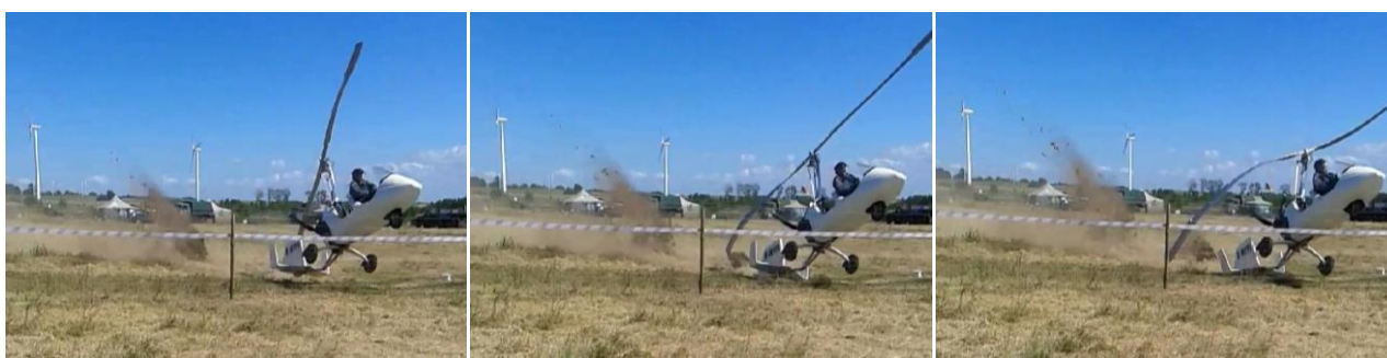
Fot. 12. Dalsza deformacja łopatkami wirnika nośnego i usterzenia wiatrakowca
