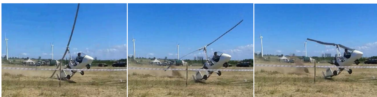
Fot. 11. Zaczepienie łopatkami wirnika nośnego o nawierzchnię terenu
