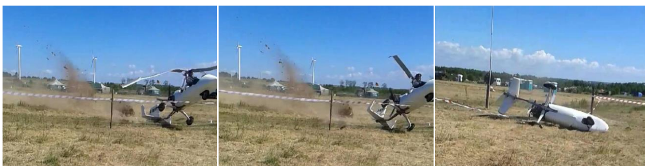
Fot. 13. Kapotaż wiatrakowca [fot. 9-13, zdjęcia poklatkowe z zapisu video, autor Michał Terlikowski]
