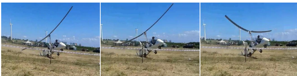
Fot. 10. Gwałtowne zadarcie kadłuba wiatrakowca – zaczepienie belką ogonową o nawierzchnię terenu
