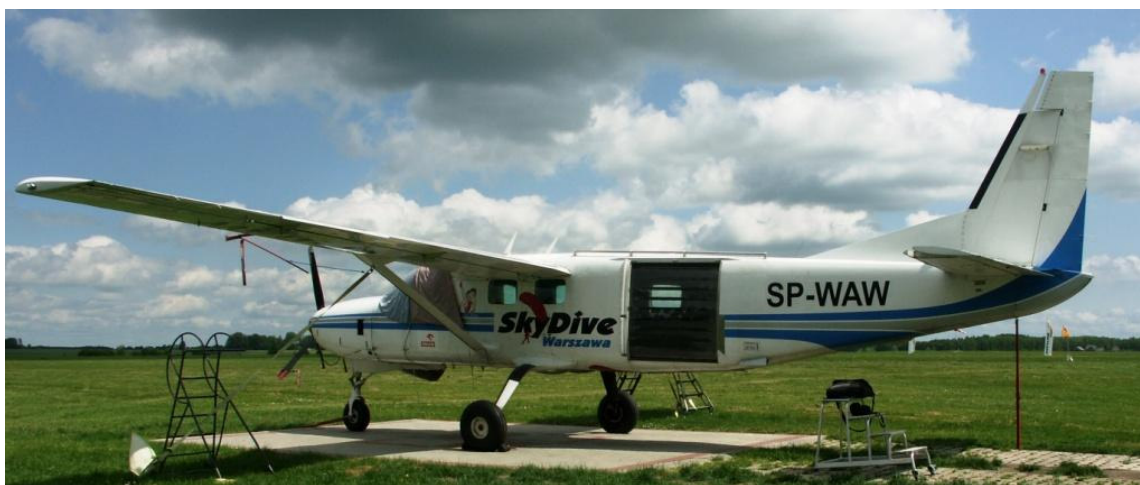
Fot.1. Widok samolotu Cessna 208B. Widoczny wykrój drzwi, przez który skoczkowie opuszczali pokład samolotu. (fot. PKBWL)
