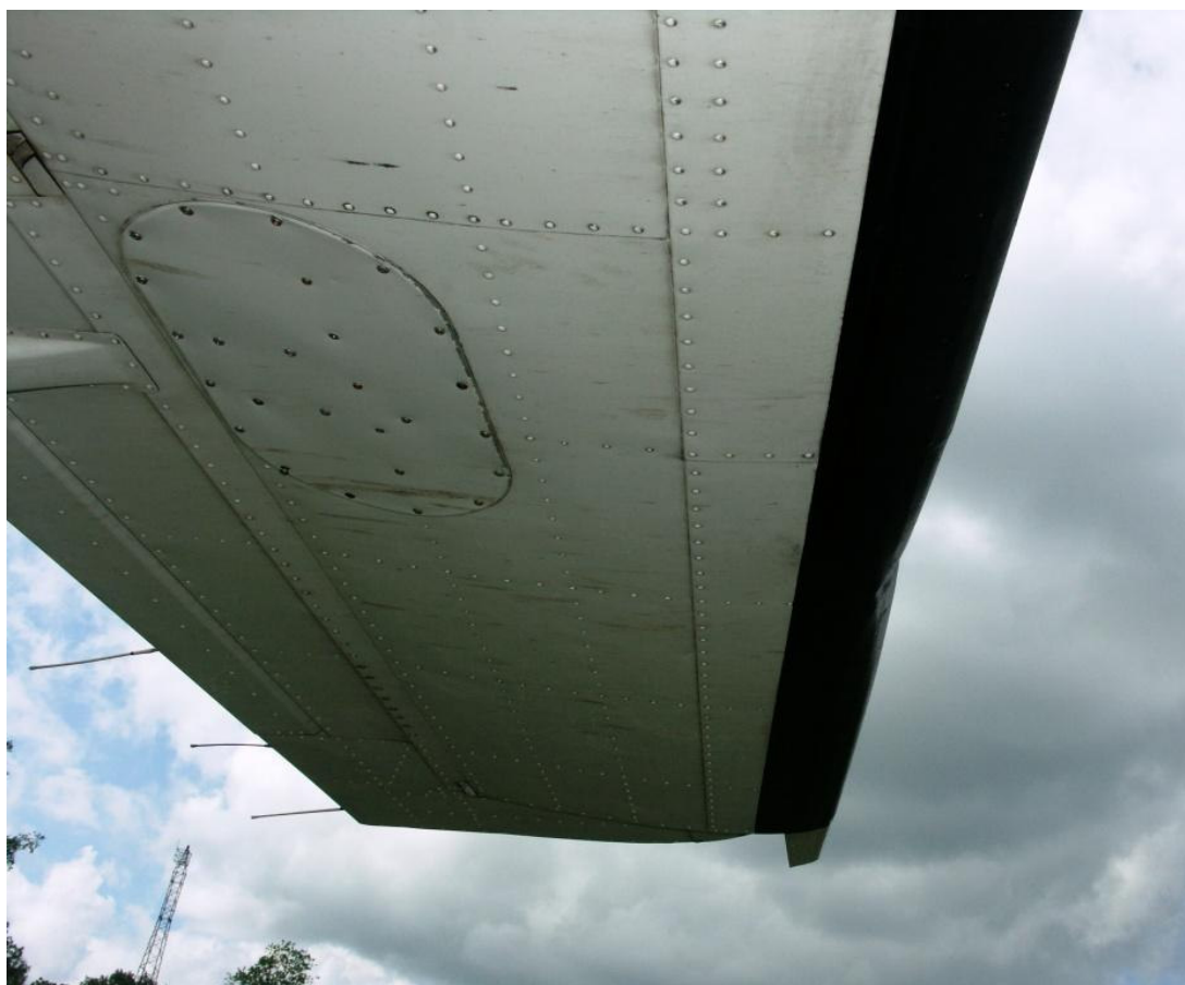
Fot.3 Uszkodzenie lewego statecznik poziomego, widok od dołu. (fot. PKBWL)
