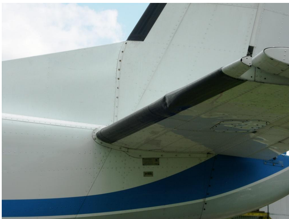
Fot.2 Widok uszkodzenia krawędzi natarcia lewego statecznika poziomego. (fot. PKBWL)
