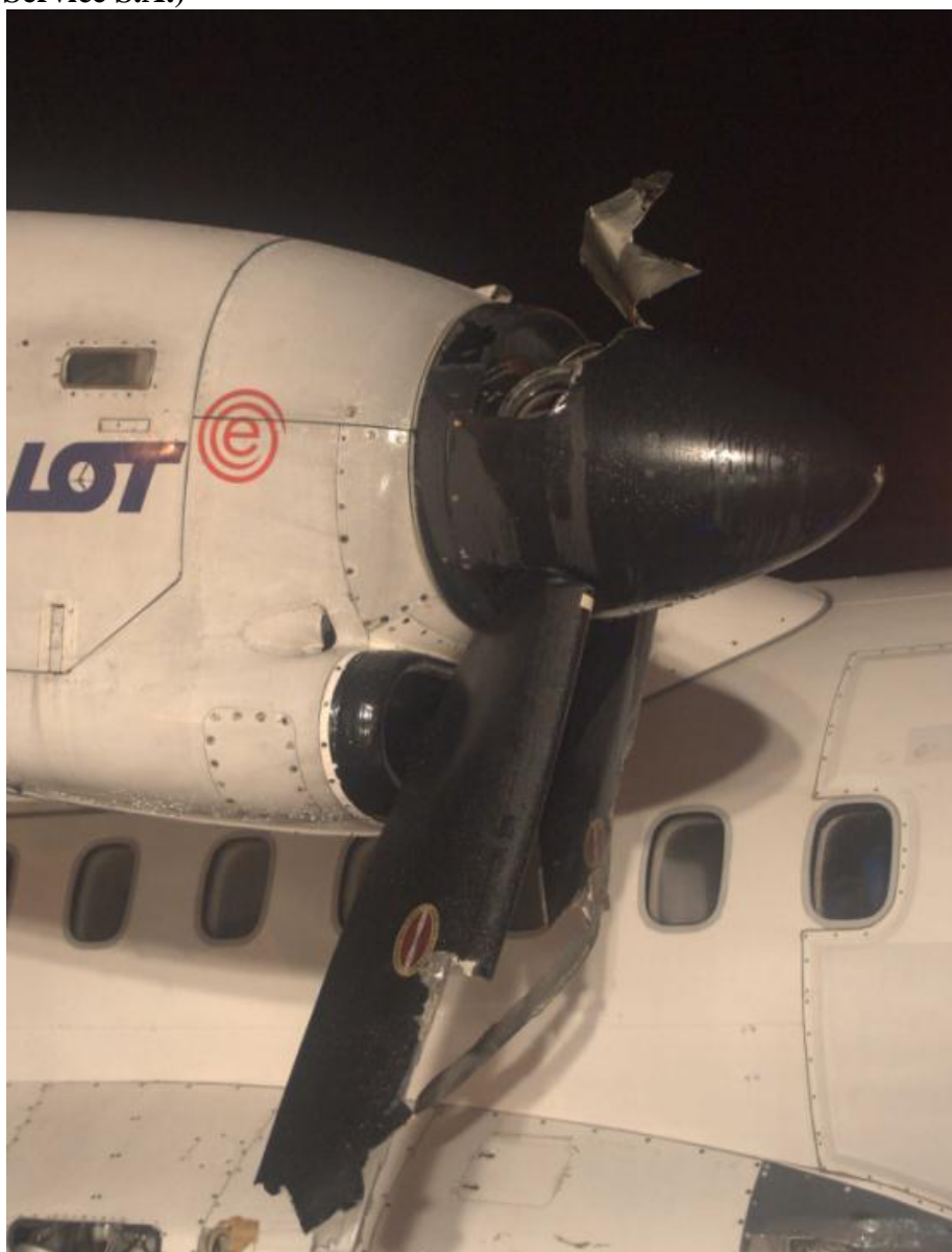
Zdjęcie 4. Uszkodzone śmigło. (zdjęcie LS Airport Service S.A.)
