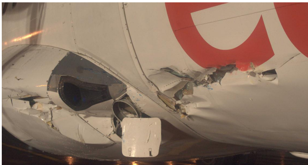
Zdjęcie 3. uszkodzona gondola podwozia oraz poszycie kadłuba. (zdjęcie LS Airport Service S.A.)
