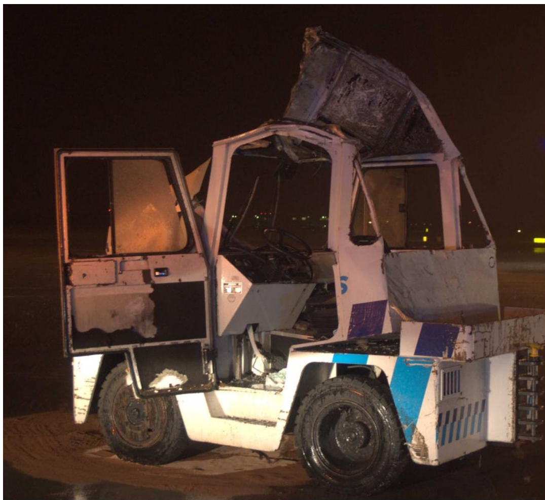
Zdjęcie 8. Uszkodzona przez śmigło tylna pokrywa (zdjęcie LS Airport Service S.A.)
