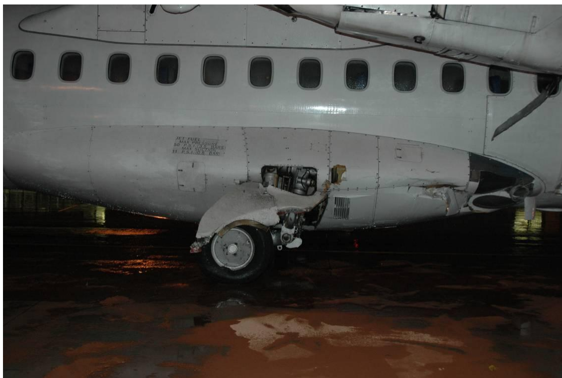
Zdjęcie 5. Uszkodzona gondola prawego podwozia głównego. (zdjęcie P.P. „Porty Lotnicze”)
