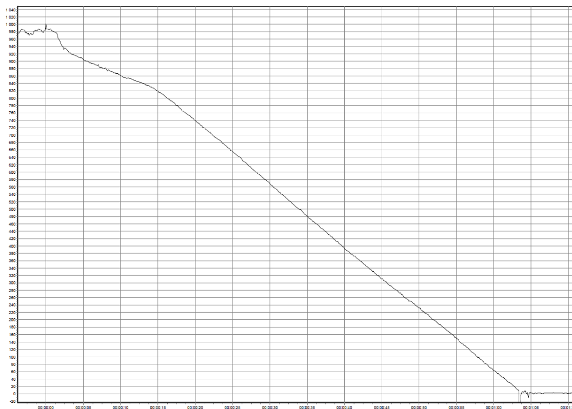
Wykres 2 (wysokość w funkcji czasu) na podstawie danych zawartych w pamięci automatu spadochronowego MPAAD, przedstawiający przebieg skoku ucznia-skoczka od momentu krótko przed oddzieleniem się od samolotu do zderzenia z ziemią. Wykres wykonany przez MarS a.s.
