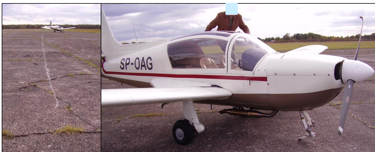
1, 2 – Ślad lądowania na betonie i samolot po zatrzymaniu – zwraca uwagę brak przedniego koła i uszkodzone śmigło. Fot. T. Dunajski.
