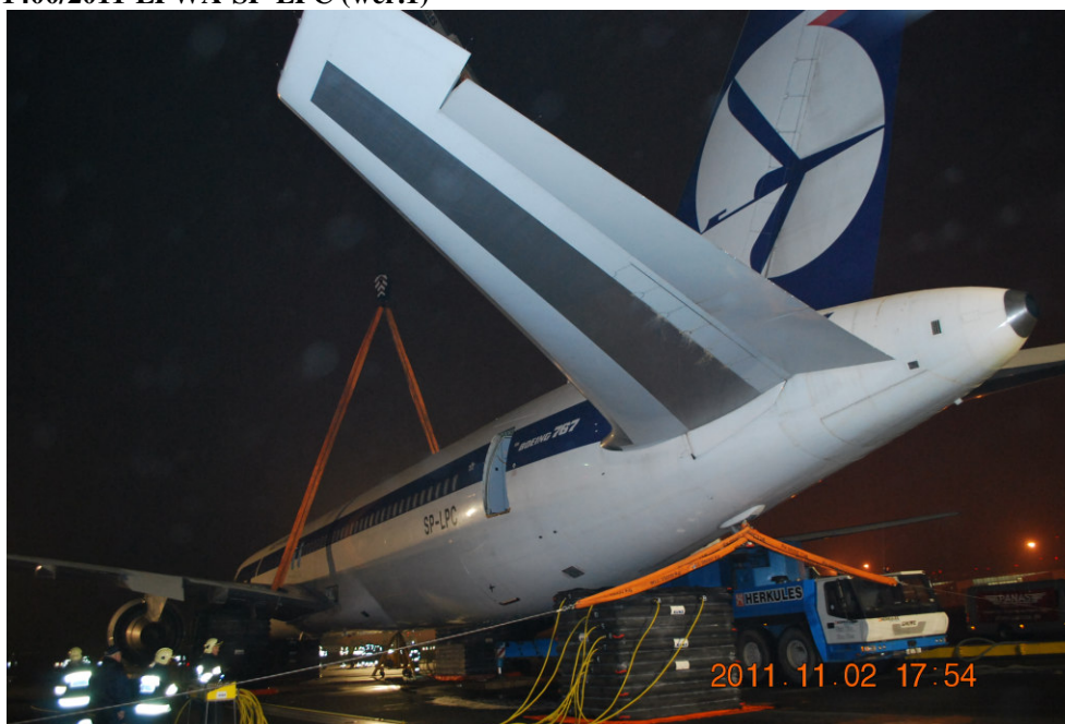
Fot. 10 Samolot SP-LPC uniesiony w górę za pomocą dźwigu i poduszek powietrznych.
