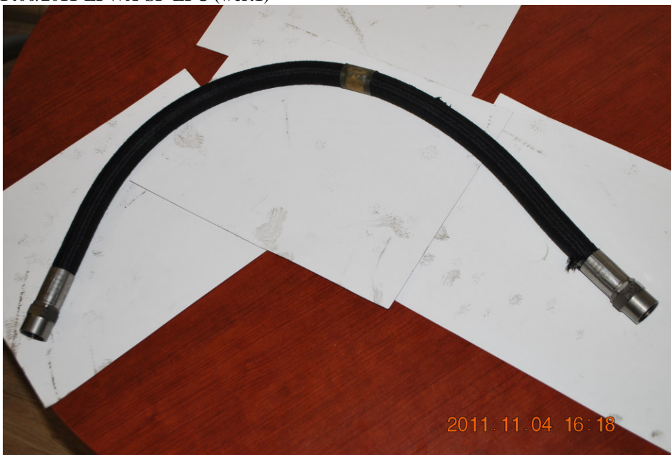
Fot. 13 Uszkodzony przewód hydrauliczny wypuszczania podwozia samolotu SP-LPC.
