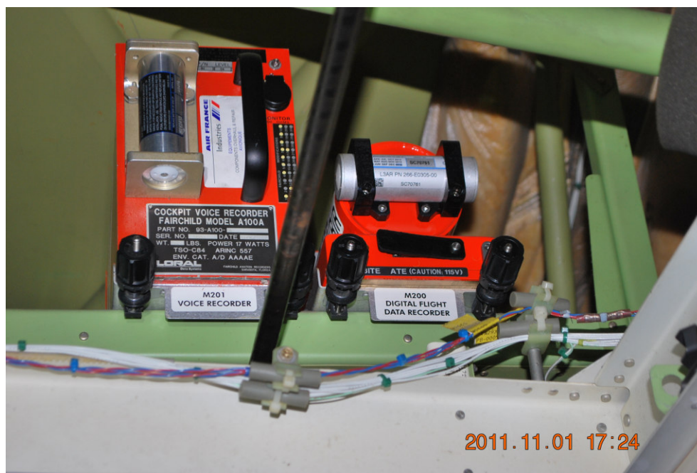
Fot. 6 Pokładowe rejestratory parametrów lotu (FDR) i rozmów w kabinie (CVR) samolotu SP-LPC.
