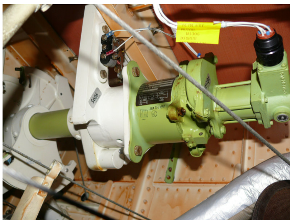
Fot. 18 Silnik elektryczny alternatywnego systemu wypuszczania podwozia.
