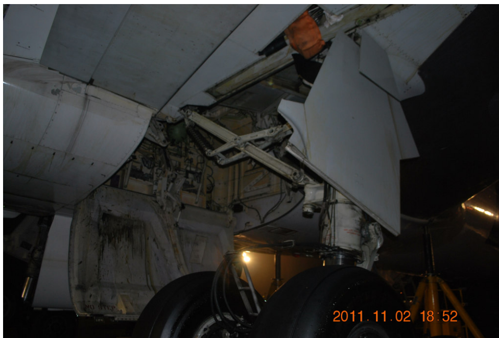
Fot. 11 Wypuszczone prawe główne podwozie samolotu SP-LPC po podniesieniu samolotu.
