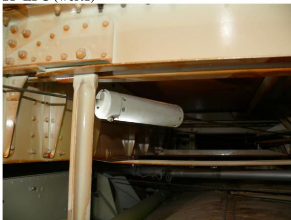
Fot. 17 Ogranicznik przeciążeniowy alternatywnego systemu wypuszczania prawego podwozia głównego.
