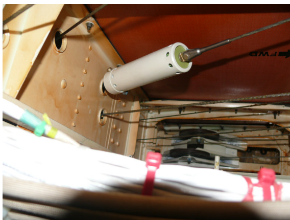
Fot. 16 Ogranicznik przeciążeniowy alternatywnego systemu wypuszczania lewego podwozia głównego.
