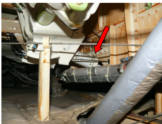
Fot. 15 Ogranicznik przeciążeniowy alternatywnego systemu wypuszczania przedniego podwozia głównego.
