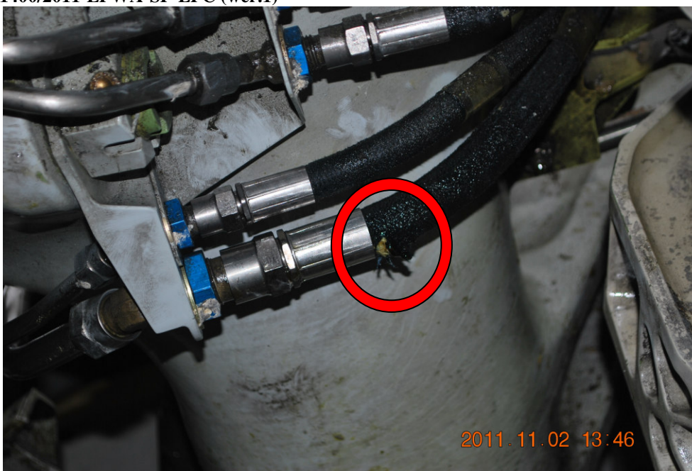
Fot. 8 Uszkodzony przewód hydrauliczny prawego podwozia głównego samolotu SP-LPC.
