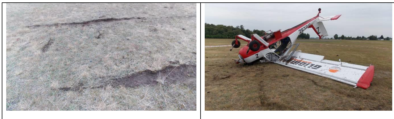
Rys.2. Miejsce pierwszego kontaktu goleni samolotu z nawierzchnią lotniska (zdjęcie po lewej) oraz samolot po kapotażu (zdjęcie po prawej) [foto PKBWL]
