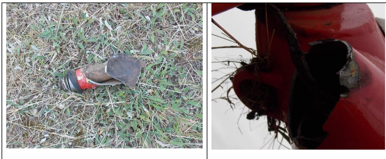
Rys.4. Wyrwany z lewej goleni czop mocowania ucha amortyzatora (zdjęcie po lewej) oraz uszkodzenia goleni w miejscu mocowania czopa [foto PKBWL]
