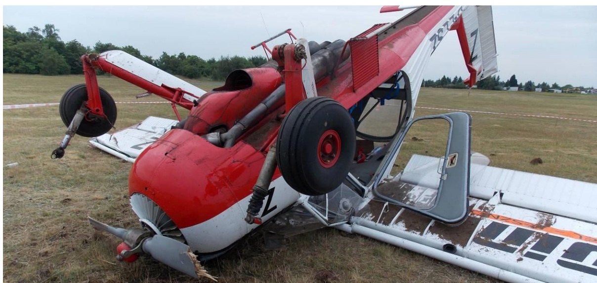
Rys. 3. Widok przedniej części samolotu po kapotażu. Na pierwszym planie uszkodzone śmigło oraz wyrwane z goleni amortyzatory wahaczy podwozia głównego [foto PKBWL]
