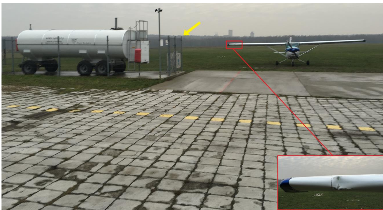
Rys.2. Samolot po zderzeniu z narożnym słupkiem ogrodzenia. Żółta strzałka wskazuje miejsce kolizji. Poniżej zbliżenie pokazujące uszkodzony keson na krawędzi natarcia. [foto Aeroklub Częstochowski]
