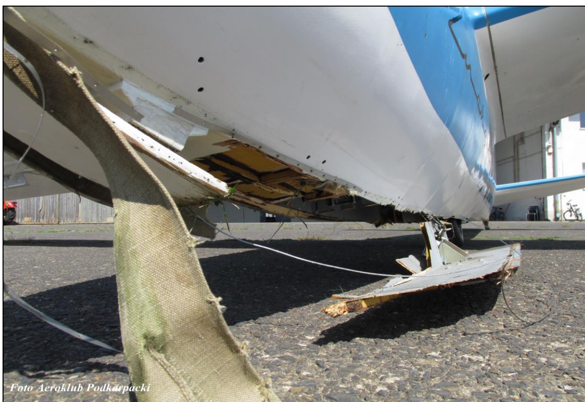
Ilustracja nr 2. Uszkodzona listwa kilowa, złamana płoza.
