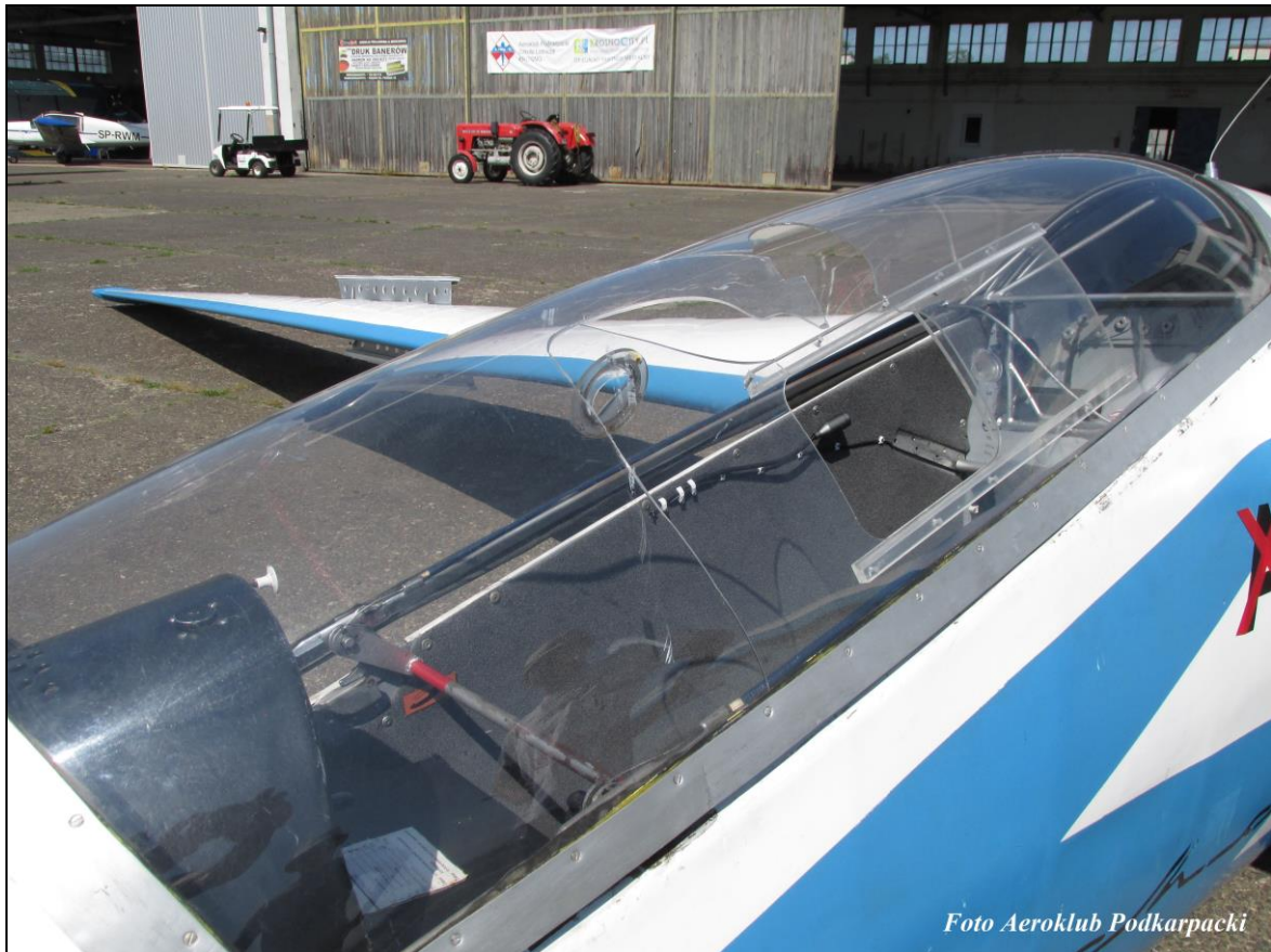
Ilustracje nr 3. Uszkodzenie oszklenia kabiny szybowca.
