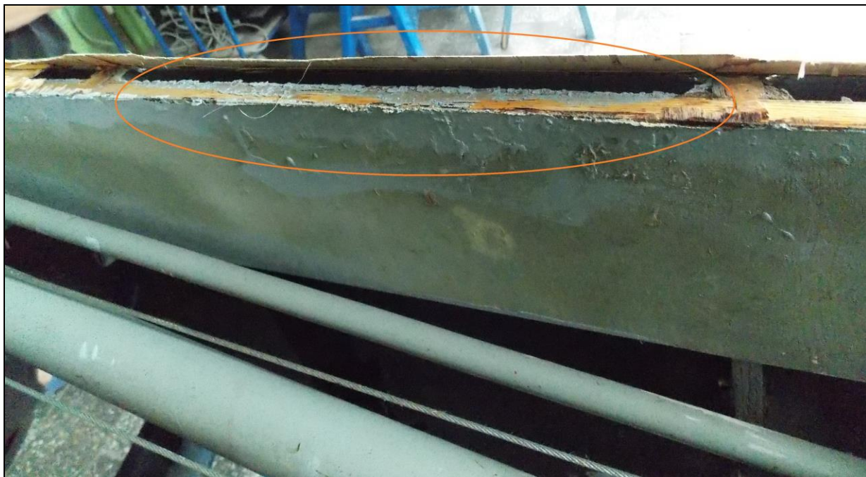
Ilustracja nr 6. Nie doklejenie podłużnicy listwy kilowej.
