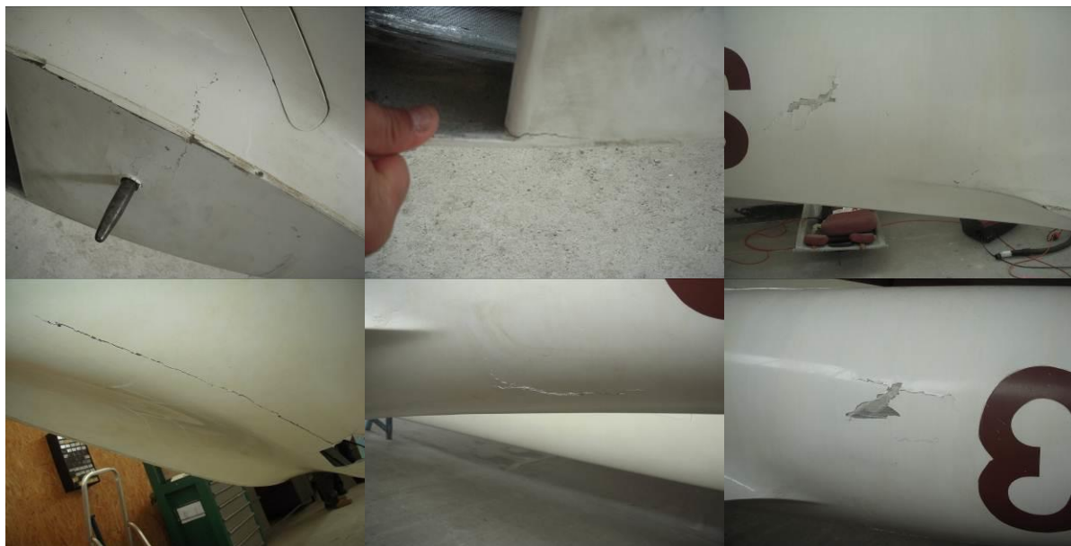
Ilustracja 3. Liczne uszkodzenia struktury kadłuba szybowca.
