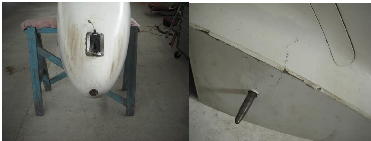
Ilustracja 2. Po lewej stronie widoczne ślady przytarcia na spodniej części przodu kadłuba, po prawej pęknięcie kadłuba w okolicy tylnego okucia zawieszenia skrzydła.
