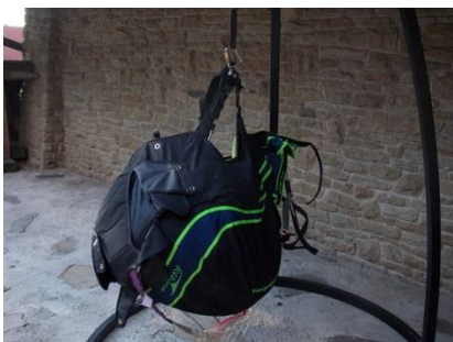
Fot. 3 Uprzęże w próbach były podwieszane. Do zablokowania wystarczył ciężar własny uprzęży.
