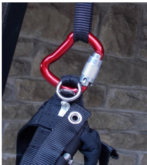
Fot. 4 Karabinek SupAir (aluminiowy) używany podczas lotu zakończonym wypadkiem. Zablokowanie procesu wyczepiania wynika z dociśnięcia kółeczka małego przez karabinek i zablokowanie ruchu kółka większego na zamku karabinka.
