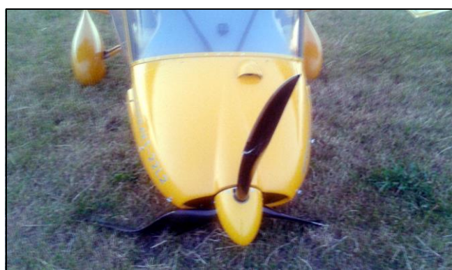
2 – Widok od przodu, widoczne połamane śmigło.
