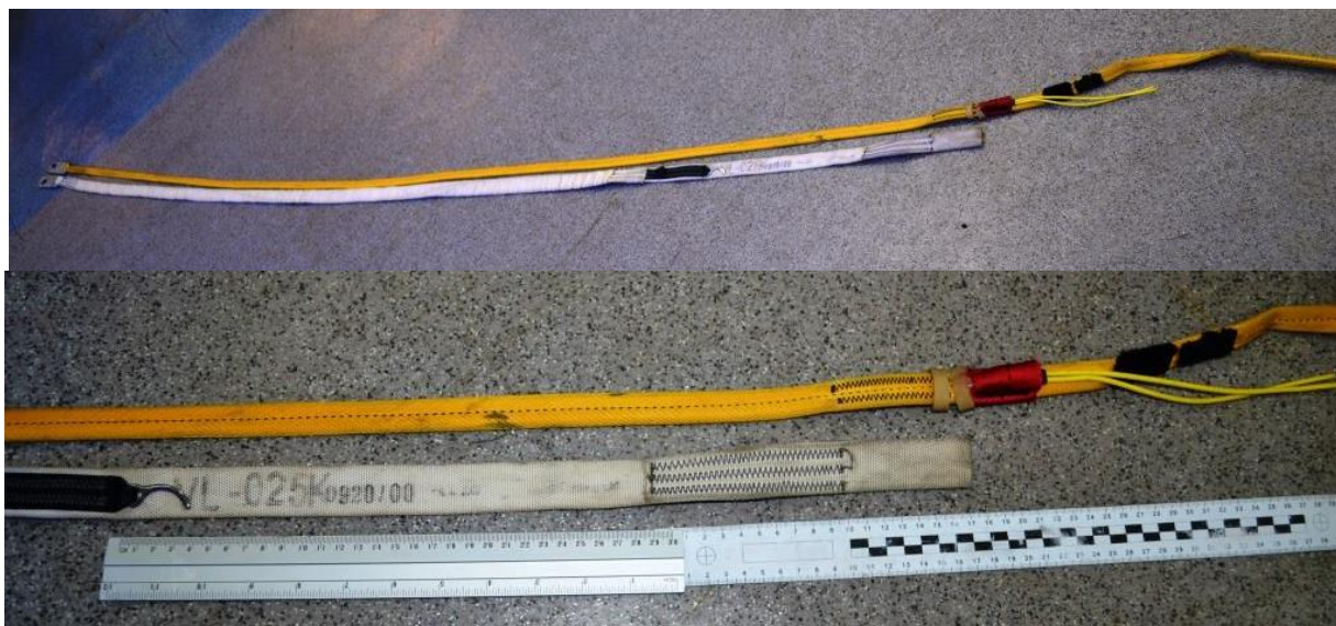
Porównanie długości lin desantowych. Biała lina jest krótsza od żółtej o 70 cm. Należy zwrócić uwagę na nietypową dla systemu uprząż/pokrowiec Telesis-2 łukowatą zawleczkę białej liny. Fot. PKBWL.
