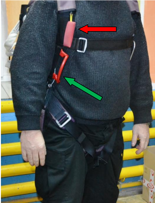
Fot. 4. Rozmieszczenie uchwytów wyczepiania zamków taśm czaszy głównej (czerwona strzałka) i otwierania czaszy głównej (zielona strzałka) w spadochronach używanych przez ucznia w poprzednich skokach. Fot. PKBWL.
