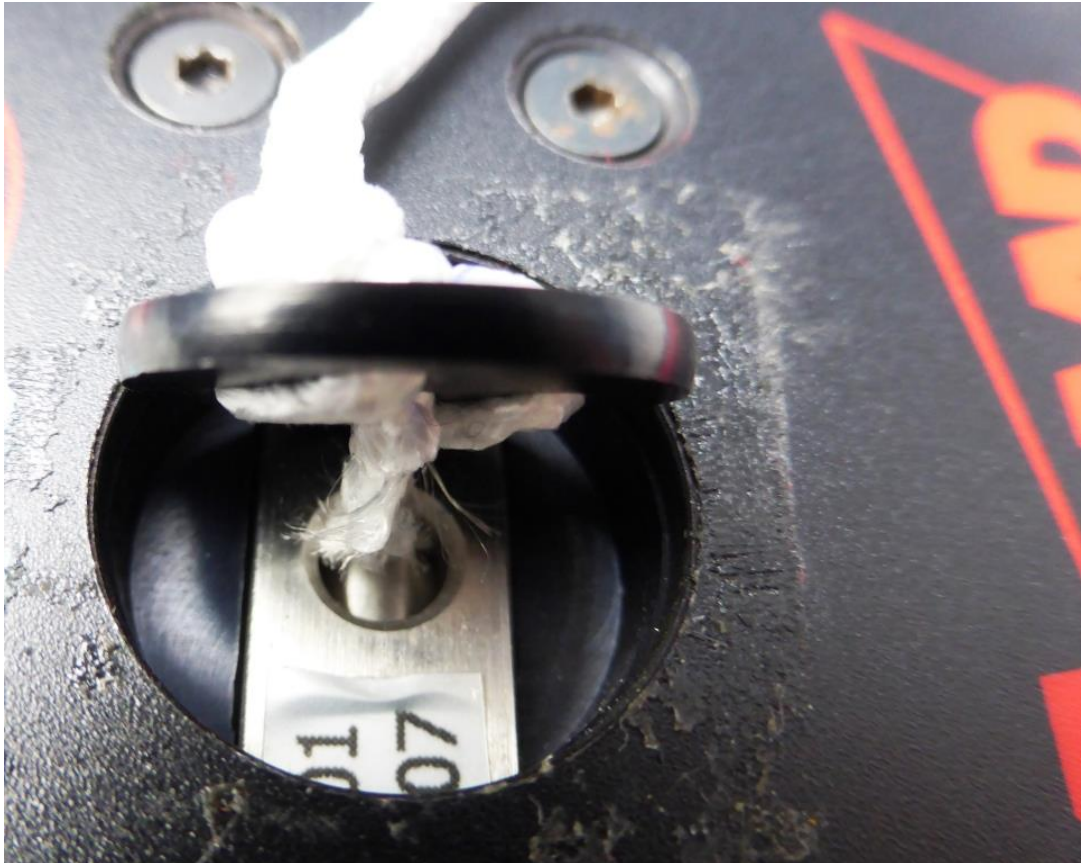
Fot.1. Widok pętli zamykające komorę czaszy zapasowej, jedynie częściowo przeciętej przez nóż końcówki tnącej automatu (cuttera). Fot. PKBWL
