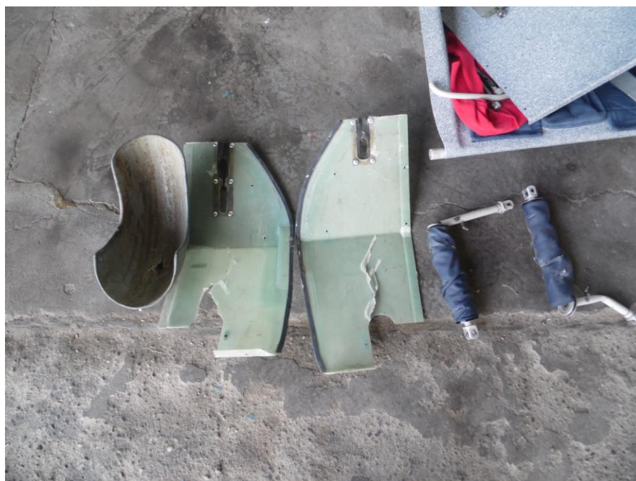
Uszkodzone elementy podwozia po zdemontowaniu.
