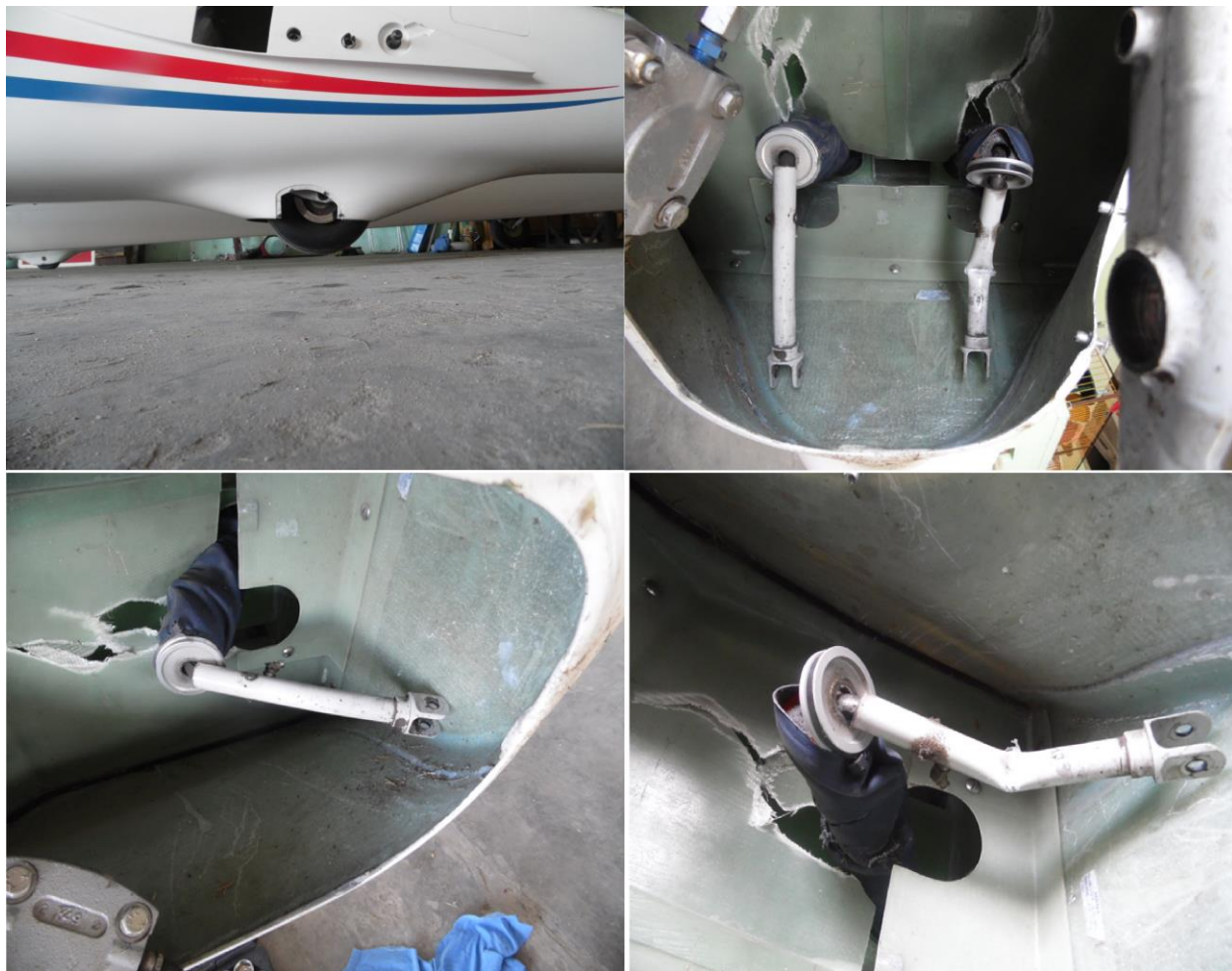
Uszkodzone podwozie szybowca.
