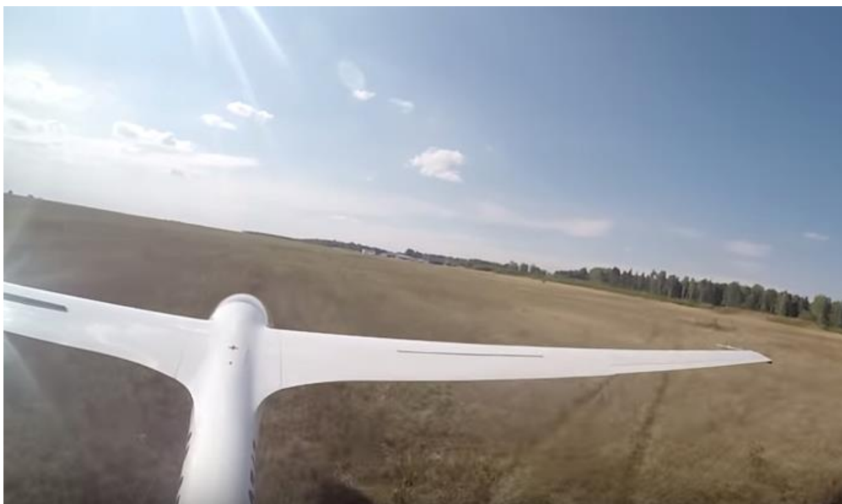
Widoczne niesymetryczne wychylenie hamulców aerodynamicznych.
