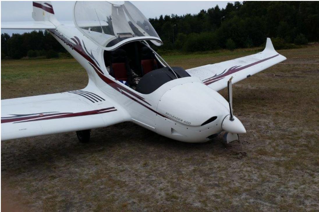
Rys.1. Samolot na miejscu zdarzenia. Widoczne uszkodzone śmigło [foto A. Klusek].
