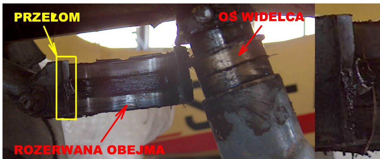
Fot.4a, 4b – Widok uszkodzeń z lewej strony, po prawej zbliżenie przełomu obejmy.
