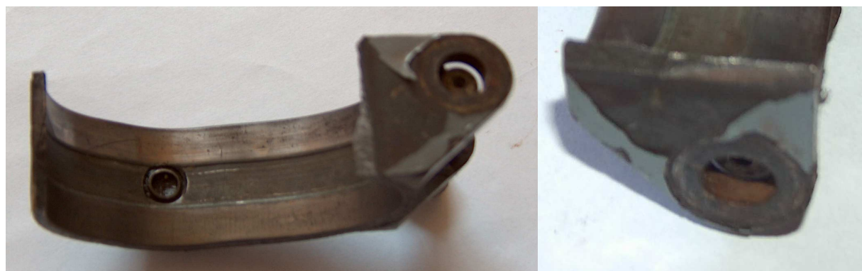
Fot.5a, 5b – Zniszczona obejma po demontażu i oczyszczeniu.
