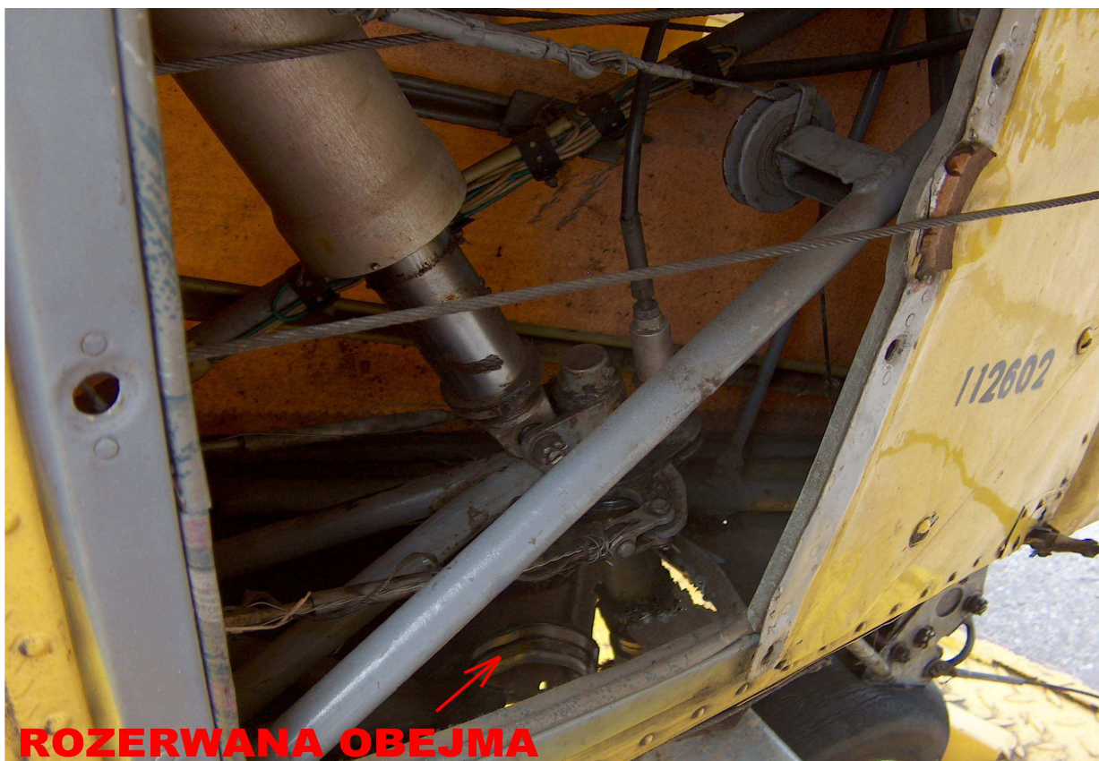
Fot.2 – Wnętrze tylnej części kadłuba po zdjęciu pokrywy.
