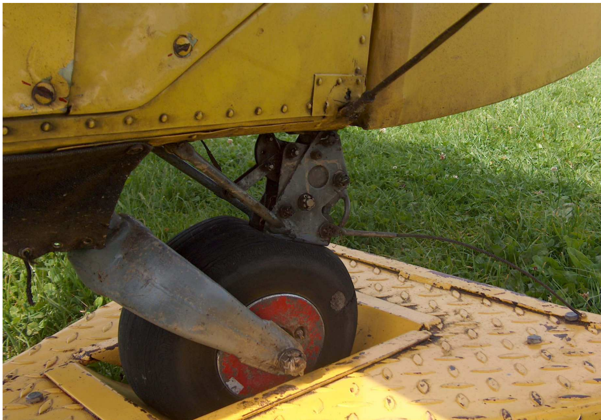
Fot.1 – Ogólny widok podwozia ogonowego i zaczepu holowniczego po wypadku.
