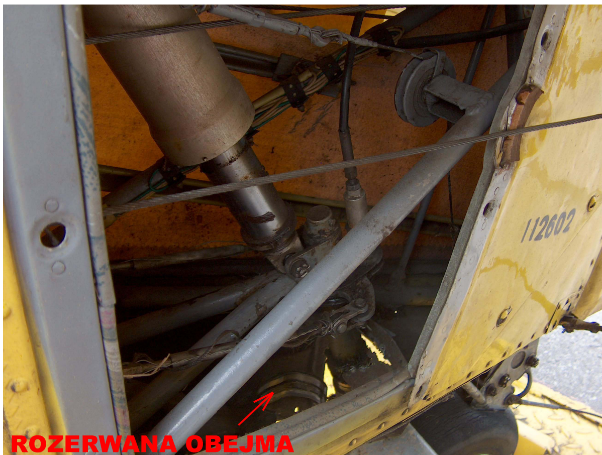
Fot.4 – Wnętrze tylnej części kadłuba po zdjęciu pokrywy.
