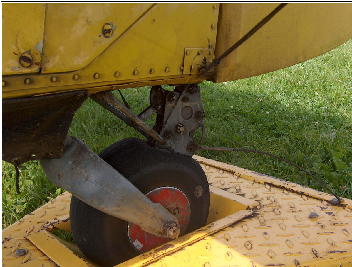
Fot.3 – Ogólny widok podwozia ogonowego i zaczepu holowniczego po wypadku.
