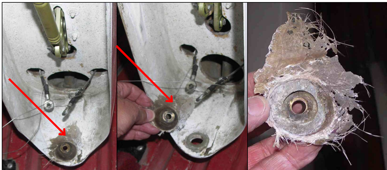
1, 2, 3 – Powyżej: Dolne łożysko steru kierunku w kadłubie po zdarzeniu. Sposób odspojenia i wygląd elementów (nie usunięta warstwa lakiernicza na fartuchu pokrycia) nie pozostawia wątpliwości co do niefachowej naprawy. 4 – Poniżej: Dolne zakończenie steru kierunku z widocznymi uszkodzeniami skorupy pokrycia w rejonie ułożyskowania.
