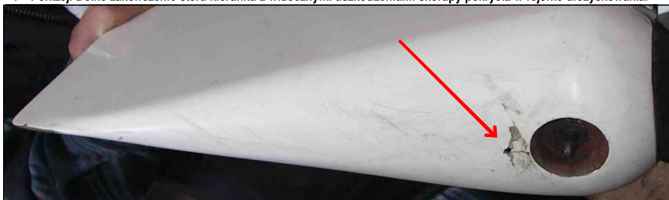
1, 2, 3 – Powyżej: Dolne łożysko steru kierunku w kadłubie po zdarzeniu. Sposób odspojenia i wygląd elementów (nie usunięta warstwa lakiernicza na fartuchu pokrycia) nie pozostawia wątpliwości co do niefachowej naprawy. 4 – Poniżej: Dolne zakończenie steru kierunku z widocznymi uszkodzeniami skorupy pokrycia w rejonie ułożyskowania.
