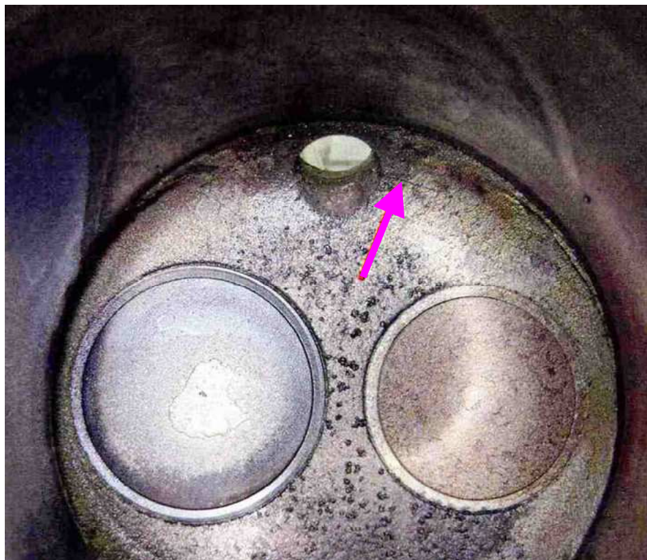
Zdj. 5. Cylinder nr 10000; strzałka wskazuje miejsce pęknięcia (zdjęcie wykonane z kierunku B wg rys. 3).
