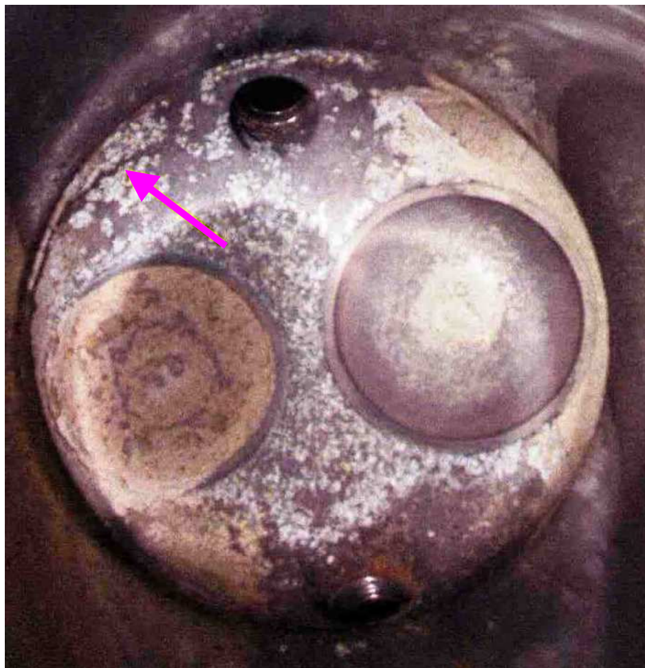
Zdj. 9. Cylinder nr 13395; strzałka wskazuje miejsce pęknięcia (zdjęcie wykonane z kierunku B wg rys. 3).
