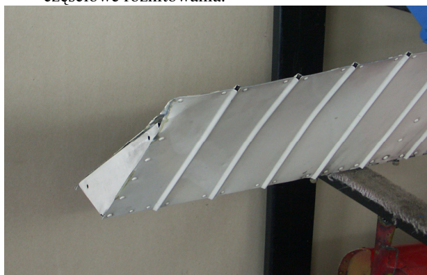
Rys.7 Widok na uszkodzoną lotkę.
