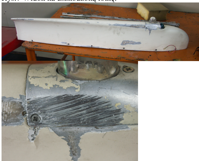
Rys. 9 Uszkodzenia odejmuwanej końcówki skrzydła.
