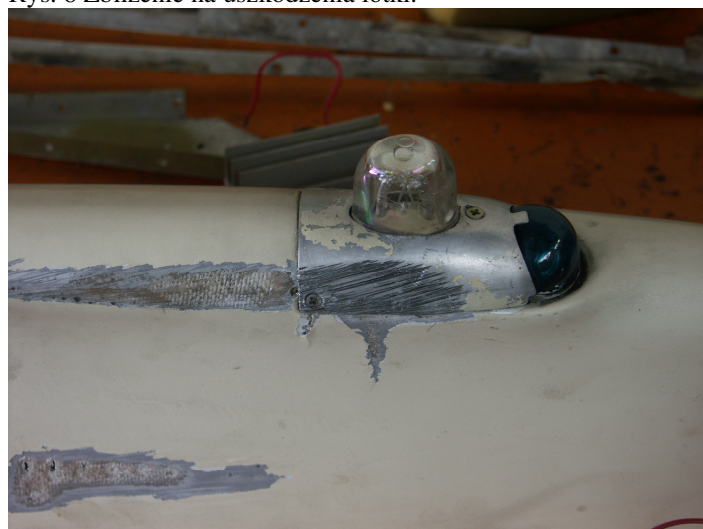
Rys. 8 Zbliżenie na uszkodzenia lotki.
