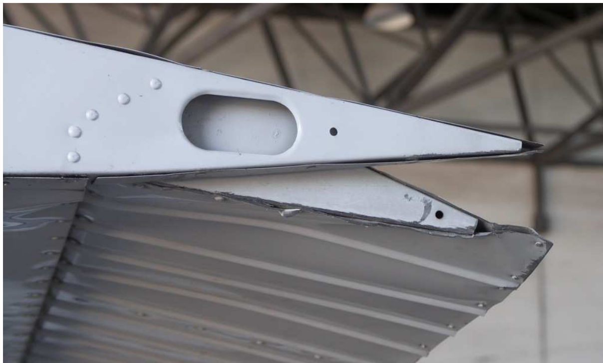
10 – Uszkodzenia lotki i końcowego fragmentu dolnego pokrycia skrzydła, lotka wychylona w dół.
