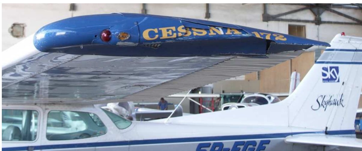
8 – Lewe skrzydło z założoną końcówką. Widoczne popalowania dolnego pokrycia przy żebrze końcowym struktury.
