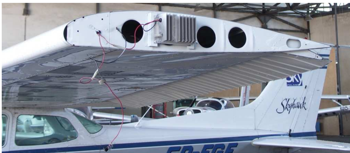
9 – Lewe skrzydło ze zdemontowaną końcówką. Widoczne popalowania dolnego pokrycia przy żebrze końcowym struktury.
