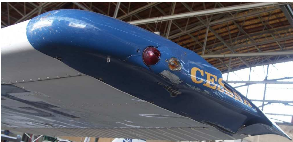
19 – Końcówka lewego skrzydła przed demontażem. Dobrze widoczne pęknięcia i zniszczenia.
