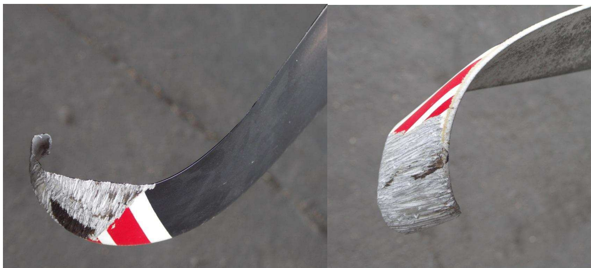
14 i 15 – Końcówki łopat zniszczonego śmigła po wykonaniu co najmniej 9 obrotów w kontakcie z betonową nawierzchnią pasa startowego.
