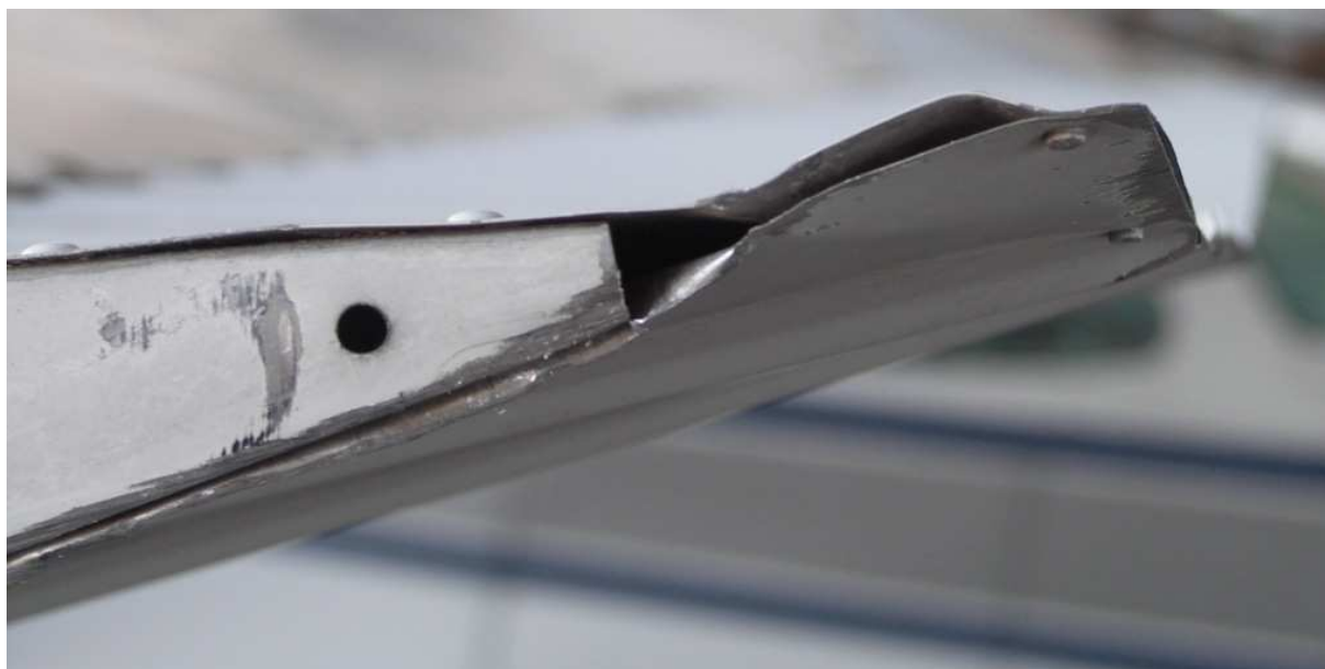
12 – Uszkodzenia końcówki lotki.
