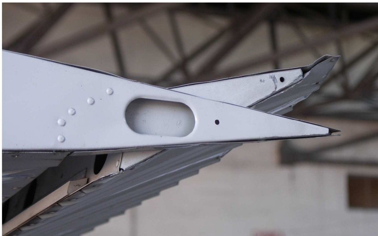
11 – Uszkodzenia lotki i końcowego fragmentu dolnego pokrycia skrzydła, lotka wychylona w górę.
