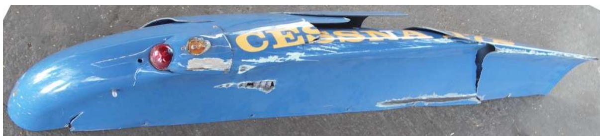
20 – Końcówka lewego skrzydła po demontażu. Dobrze widoczne pęknięcia i zniszczenia, powodujące jej rozpadnięcie się na 3 części.
