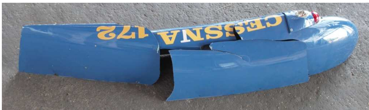
21 – Końcówka lewego skrzydła po demontażu. Dobrze widoczne pęknięcia i zniszczenia, powodujące jej rozpadnięcie się na 3 części.
