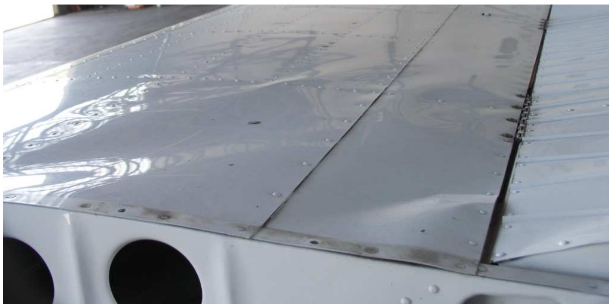
13 – Pofalowania górnego pokrycia skrzydła przy zębrze końcowym struktury i dźwigarku tylnym.
