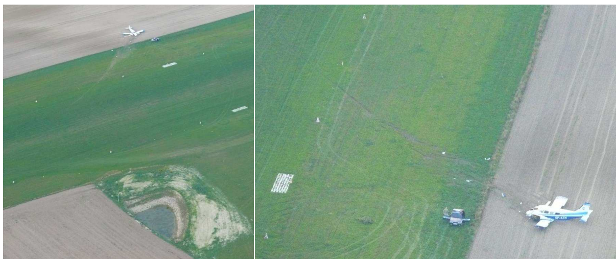
6 i 7 – Dwa ujęcia miejsca wypadku z powietrza, z dobrze widocznym śladem samolotu i szlakiem szczątków. Widoczne lampy i ograniczniki.
