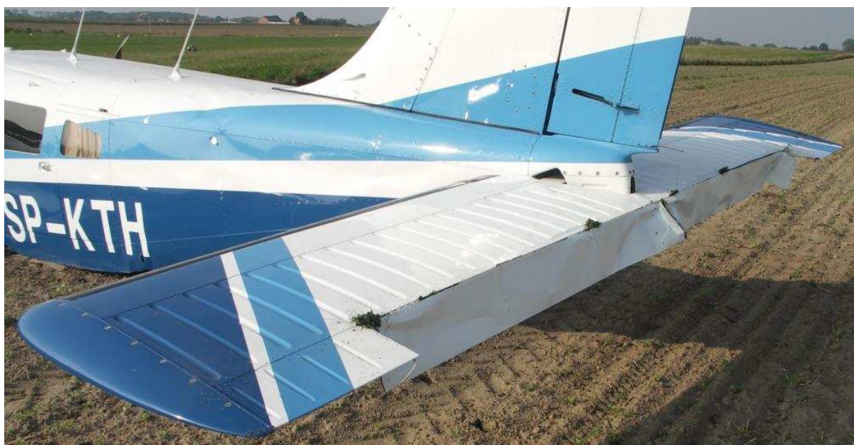
26 – Usterzenie samolotu. Widoczne zniszczenia kłapek sterujących na płycie steru wysokości.
