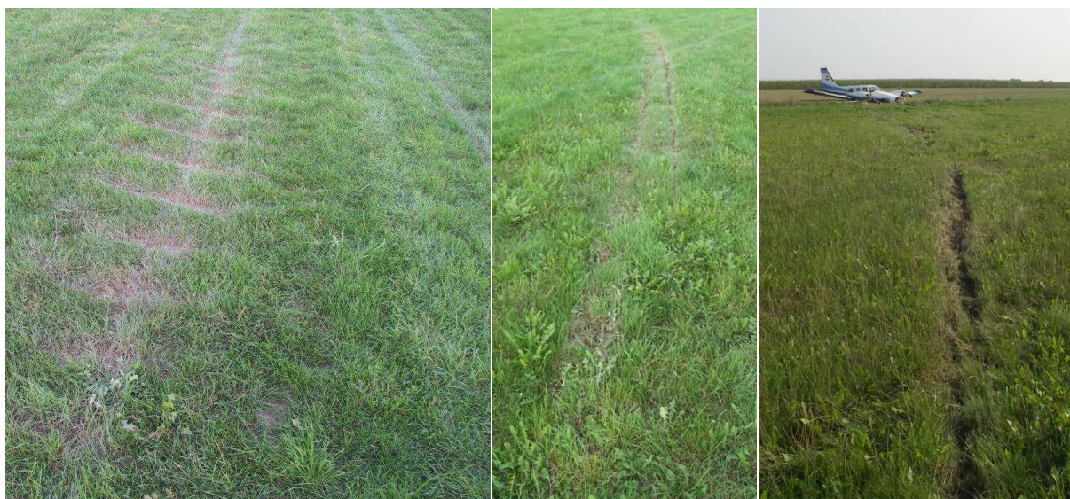
9, 10 i 11 – Ślady samolotu na nawierzchni lądowiska: ślad łopat śmigła w początkowej fazie (ok.26 m od pierwszego śladu przyziemienia), ślad uszkodzonego podwozia i zejścia z kierunku w lewo (ok.170 m od pierwszego śladu przyziemienia) oraz końcowy odcinek śladu przy lewym skraju pasa (ok.190 m od pierwszego śladu przyziemienia).
