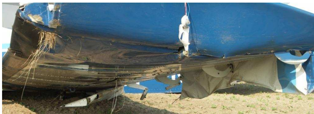
19 – Lewe skrzydło od spodu. Widoczne wyłamane lotka i kłapa.
