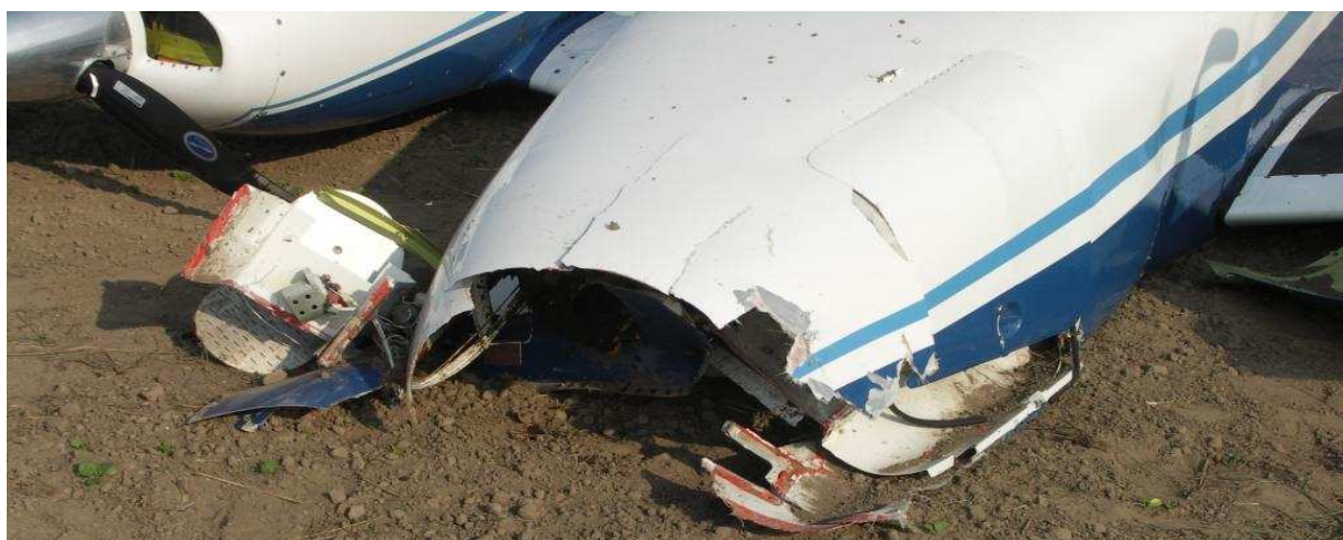
22 – Zniszczony przód kadłuba – zbliżenie. Po lewej stronie kadru, między kadłubem a prawym silnikiem widoczny zniszczony radar.
