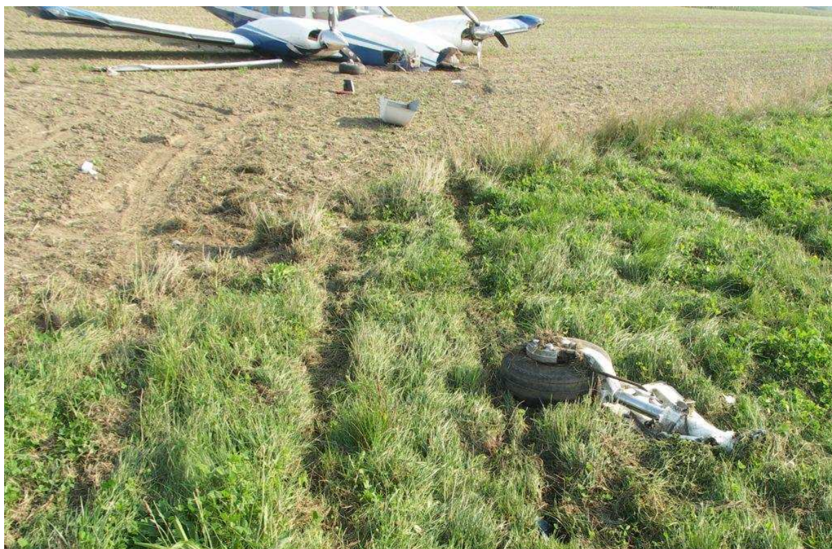
12 – Końcowy odcinek śladu samolotu i szlaku szczątków przy skraju trawiastej nawierzchni lądowiska (ok.210 m od pierwszego śladu przyziemienia). Po wpadnięciu na orne pole samolot zatrzymał się, obracając się przy tym w lewo o ok.200° i łamiąc podwozie przednie. Obrót samolotu zapoczątkowało wyłamanie lewego podwozia głównego, widocznego na pierwszym planie.
