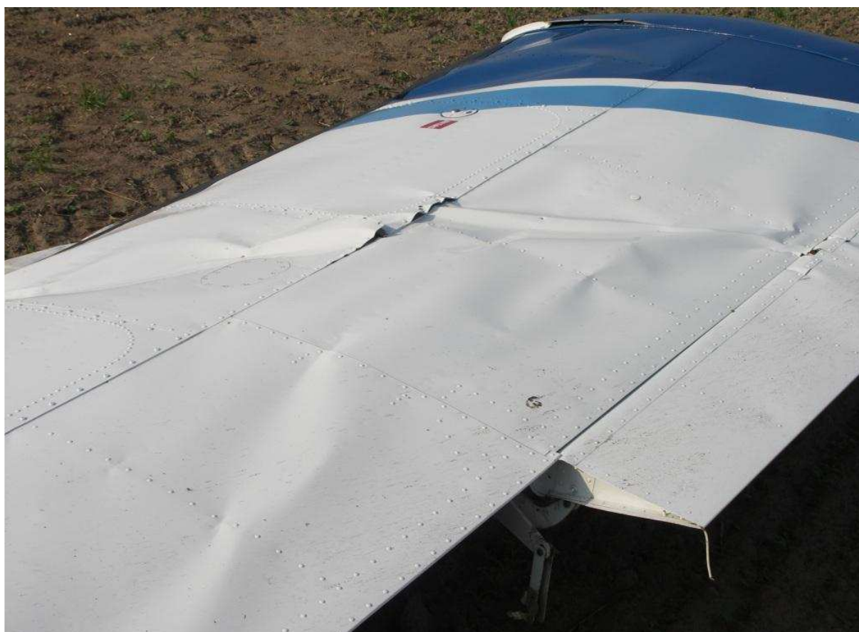
25 – Uszkodzenia prawego skrzydła w rejonie lotki – zbliżenie na górne pokrycie \frac{3}{4} od tyłu z lewej. Zwraca uwagę brak wyłamanej kłapy.
