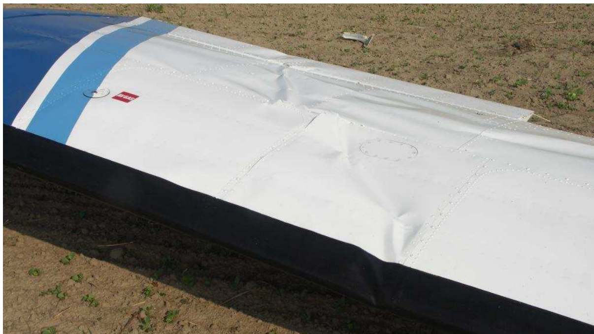
24 – Uszkodzenia prawego skrzydła w rejonie lotki – zbliżenie od przodu na górne pokrycie.
