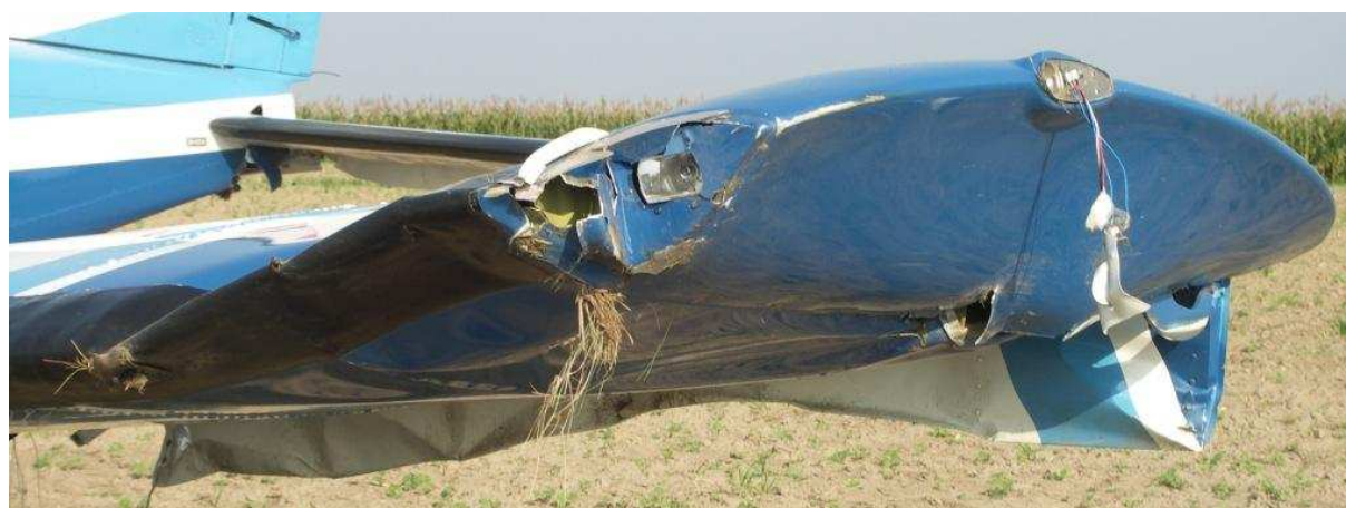
18 – Złamana końcówka lewego skrzydła w widoku ¾ od przodu z lewej strony.
