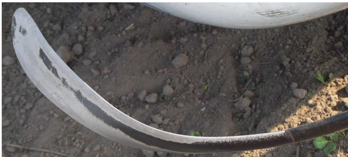
27 – Zbliżenie na zniszczoną łopate śmigła.
