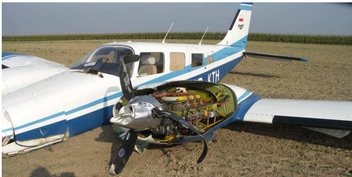
20 – Rozbity samolot w widoku ¾ od przodu z lewej strony. Dobrze widoczne zniszczone lewe śmigło.
