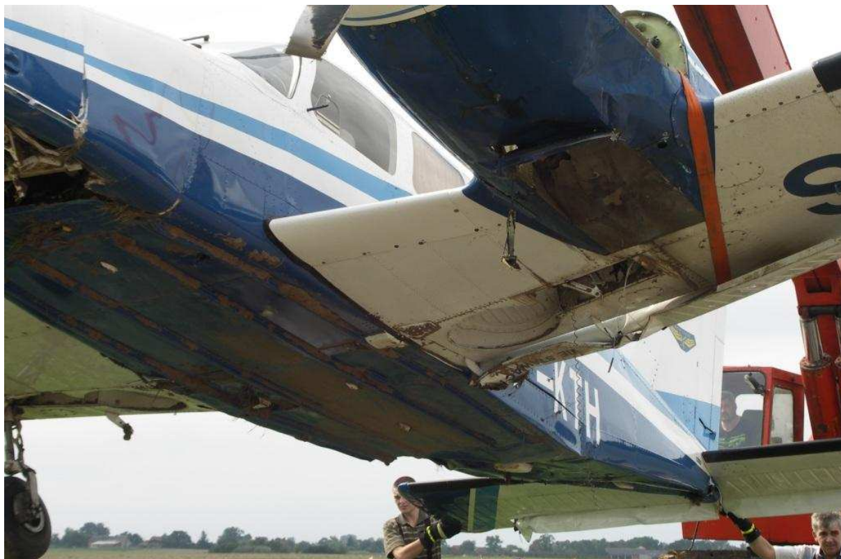
29 – Ogólny widok samolotu podczas unoszenia dźwigiem, widoczne zniszczenia i uszkodzenia dolnych powierzchni płotwca – zbliżenie.
