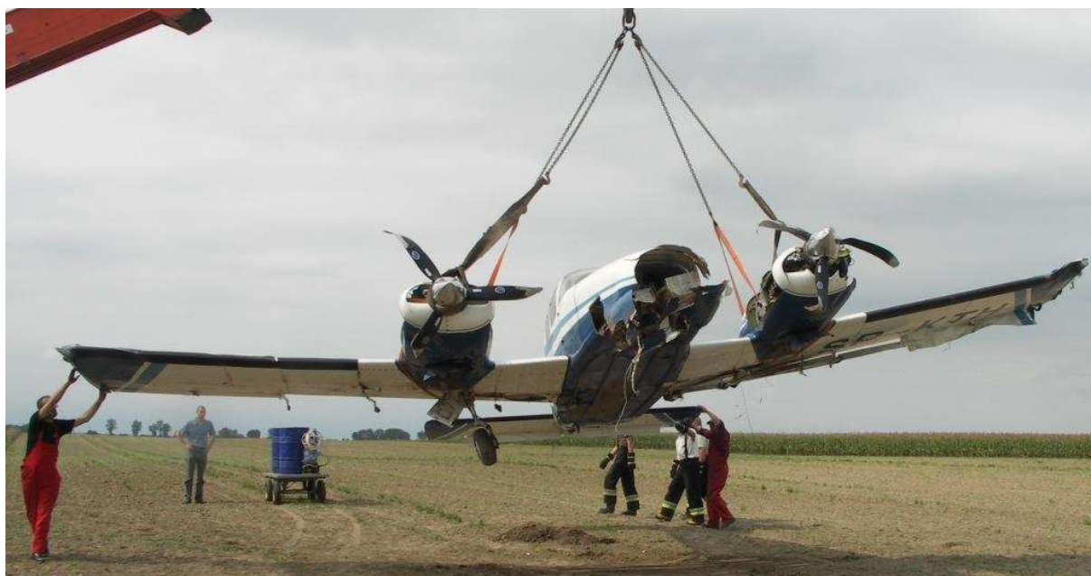
28 – Ogólny widok samolotu podczas unoszenia dźwigiem, widoczne zniszczenia i uszkodzenia dolnych powierzchni płatowca.
