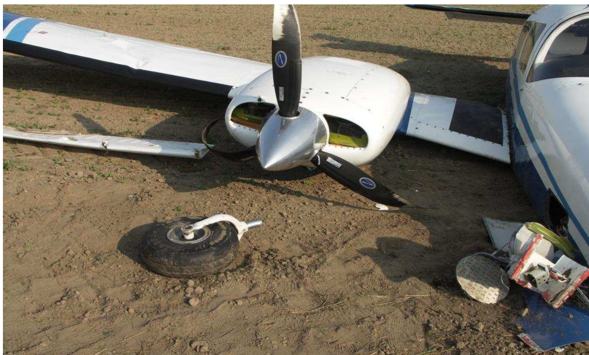
21 – Ogólny widok od przodu na prawe skrzydło samolotu. Widoczne zniszczone śmigło, wyłamane podwozie przednie i wyłamana kłapa.
