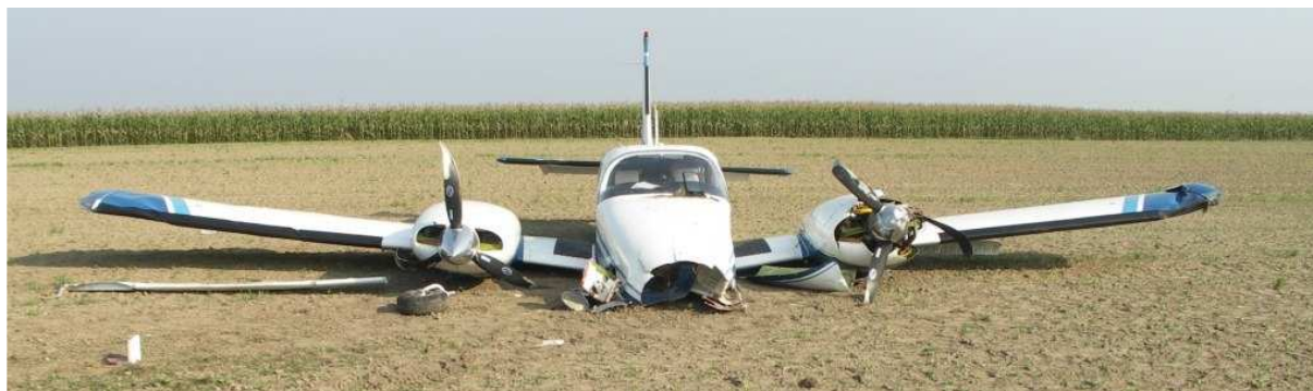
13 – Rozbity samolot, widok ogólny od przodu. Widoczny zniszczony nosek kadłuba, wyrwana prawa kłapa, podwozie przednie i osłona lewego silnika oraz zniszczone śmigła.
