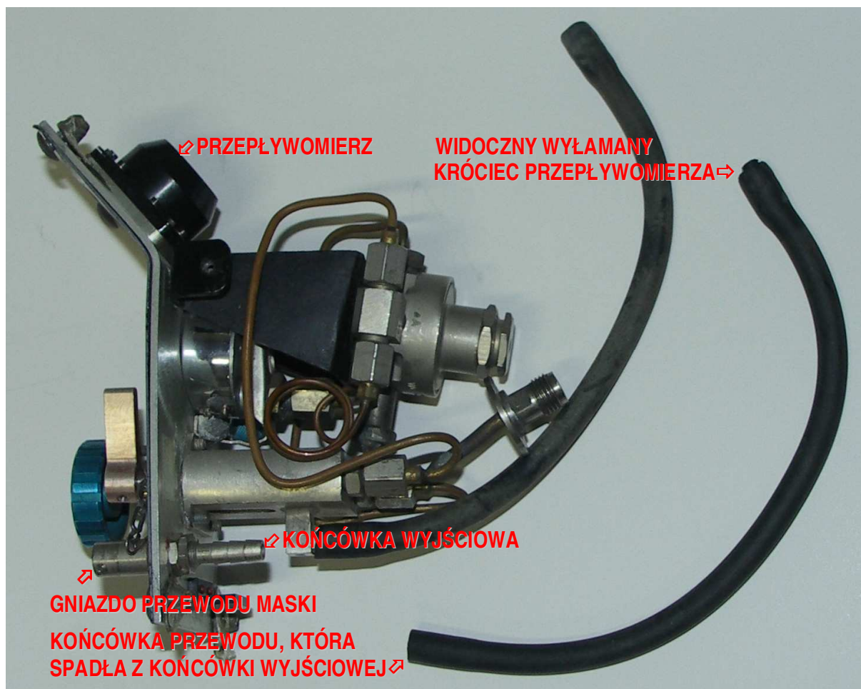
19 – Regulator tlenu w stanie takim, w jakim go odnaleziono (tzn. stan przewodów giętkich taki, jaki stwierdzono po zdjęciu obudowy). Oznaczono i opisano elementy istotne dla przebiegu zdarzenia.
