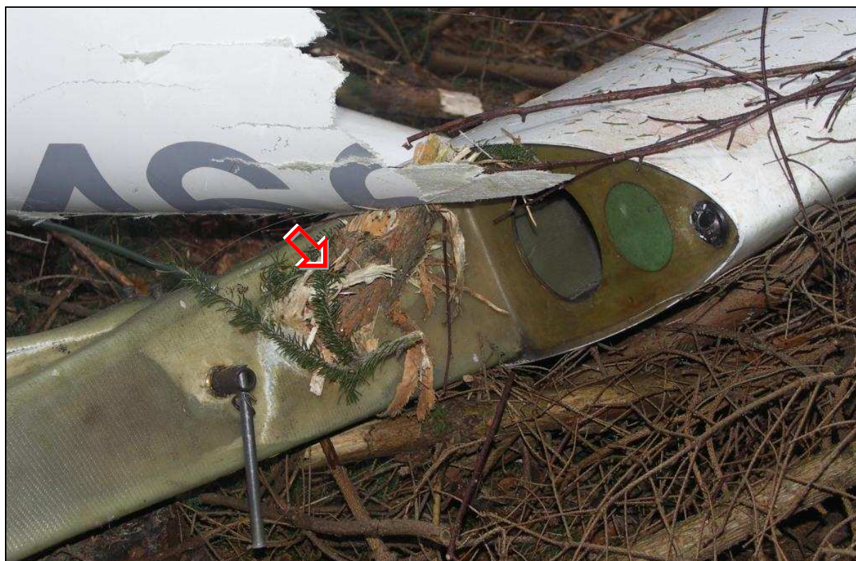
8 – Końcówka dźwigara lewego skrzydła, połączona z odłamana końcówka dźwigara prawego skrzydła – widoczne przebicie obu dźwigarów na wylot przez pień drzewa [wskazane strzałką].
