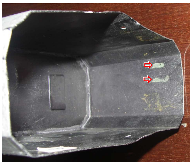
14 – Wnętrze obudowy regulatora tlenu – widoczne ślady kontaktu z króćcami przepływomierza (strzałki) – rozstaw śladów jest taki, jak rozstaw króćców „W” i „K” na ilustracji 15.
