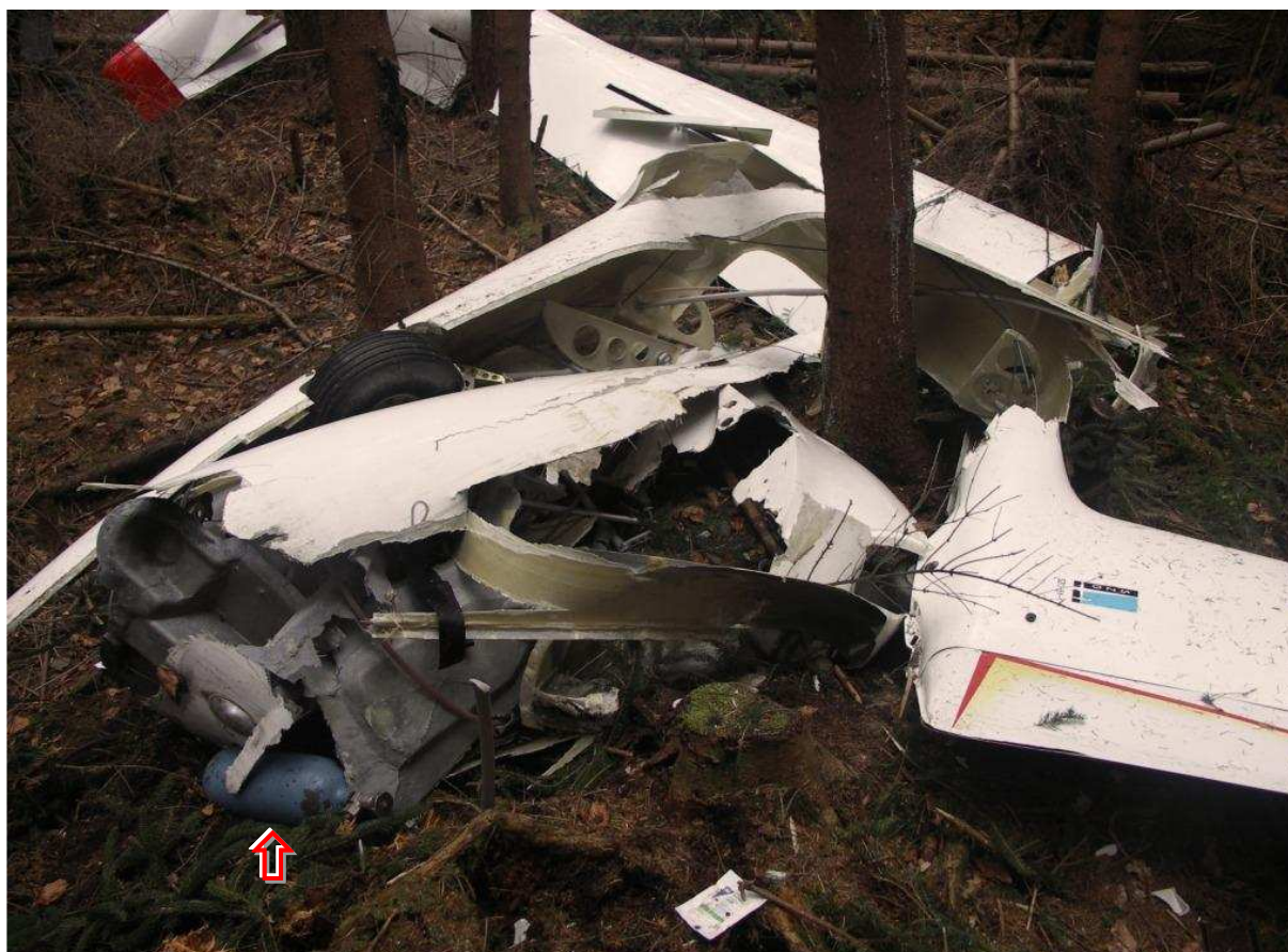
7 – Szczątki przedniej części kadłuba, po prawej stronie zakończenie belki ogonowej ze statecznikiem pionowym. W lewym dolnym rogu kadru widoczna niebieska butla instalacji tlenowej (wskazana strzałką). Na dalszym planie zniszczone lewe skrzydło.
