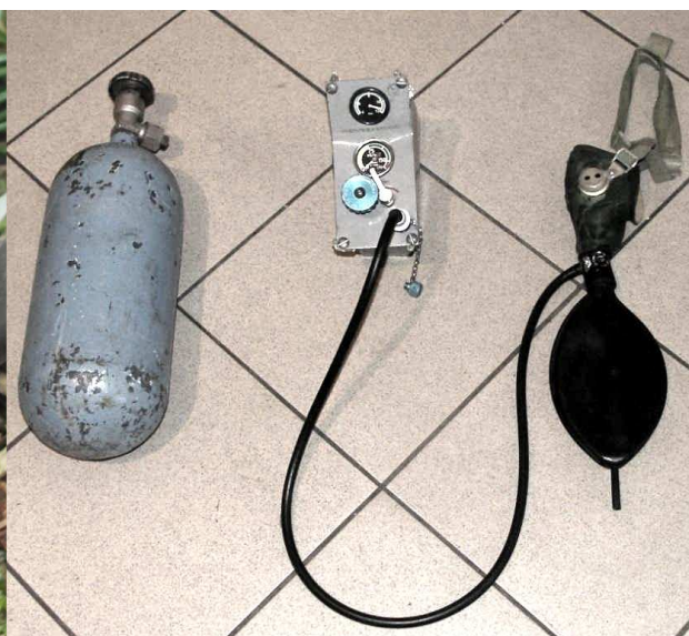
13 - Elementy instalacji tlenowej – butla i regulator tlenu z rozbitego, a przewód maski i maska z innego szybowca.
