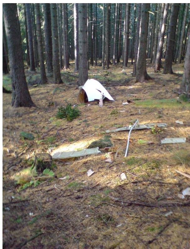
9 – Oderwane prawe skrzydło i jego szczątki, odnalezione ok. 2750 m od wraku rozbitego szybowca.
