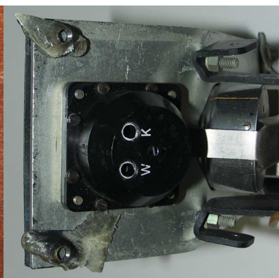
15 – Fragment zgiętej płyty montażowej regulatora tlenu – widoczne gniazda po wyłamanych króćcach przepływomierza („W” i „K”).
