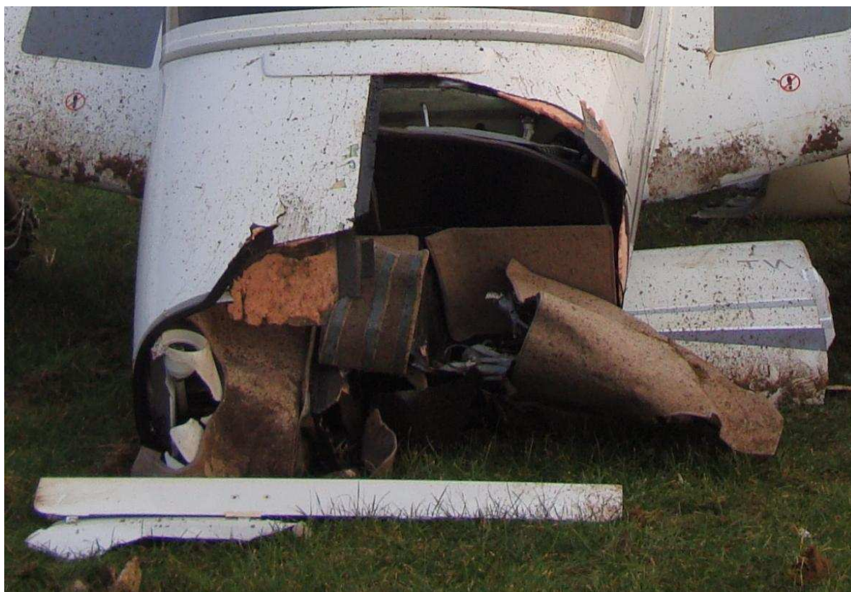
12 – Zniszczona przednia część kadłuba – zbliżenie.
