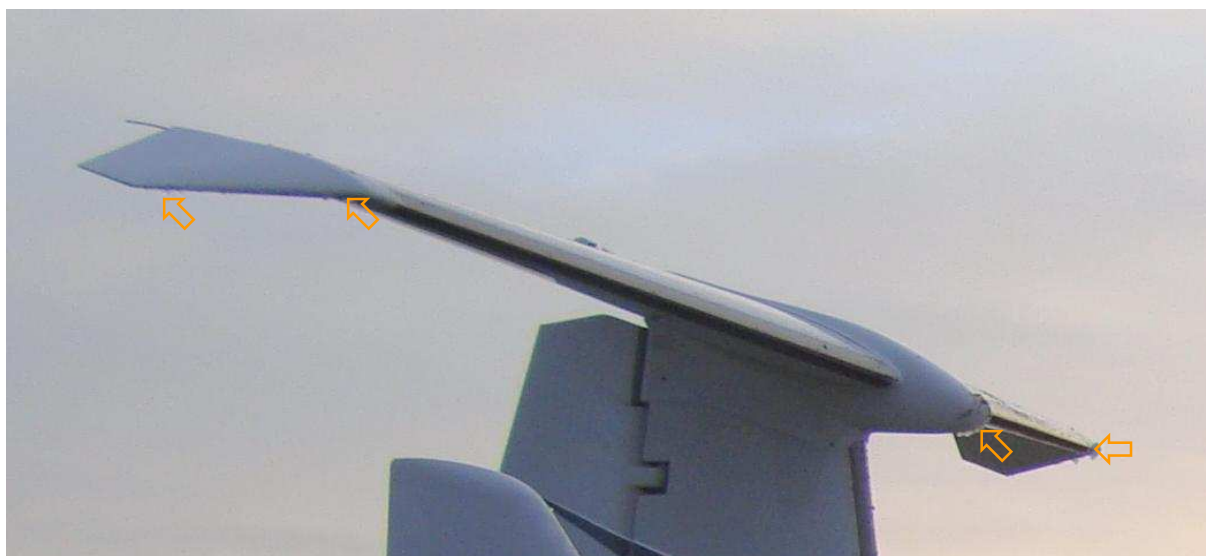
21 – Oblodzenie elementów samolotu na zdjęciach wykonanych tuż po wypadku – usterzenie poziome, widok z prawej strony.
