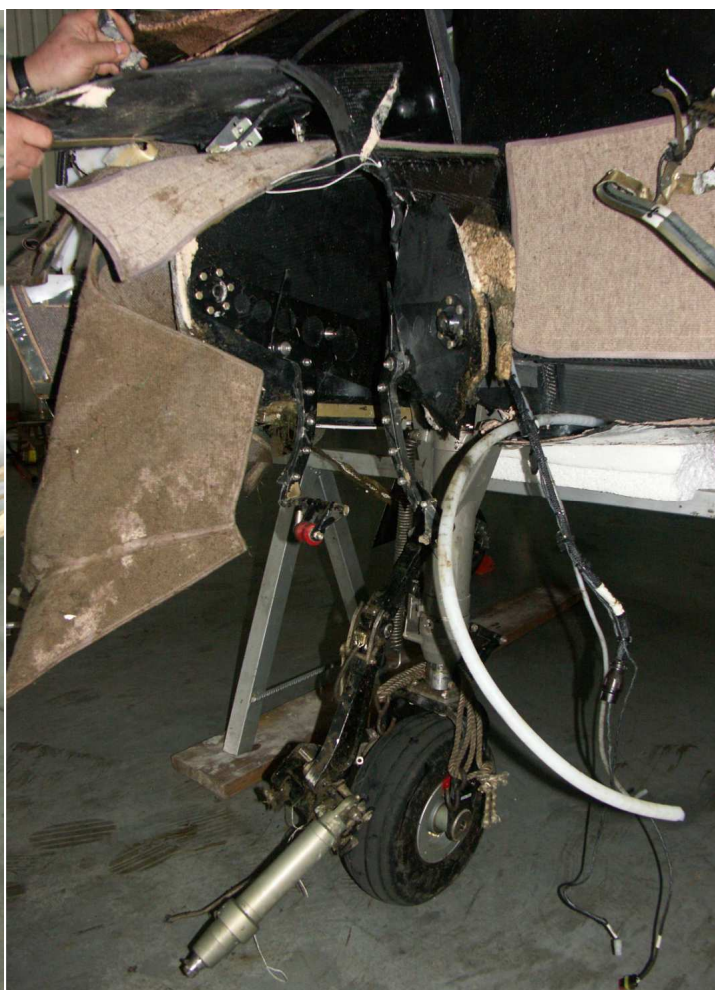
28 – Widok z lewej strony na zniszczoną przednią część kadłuba i podwozie przednie.
