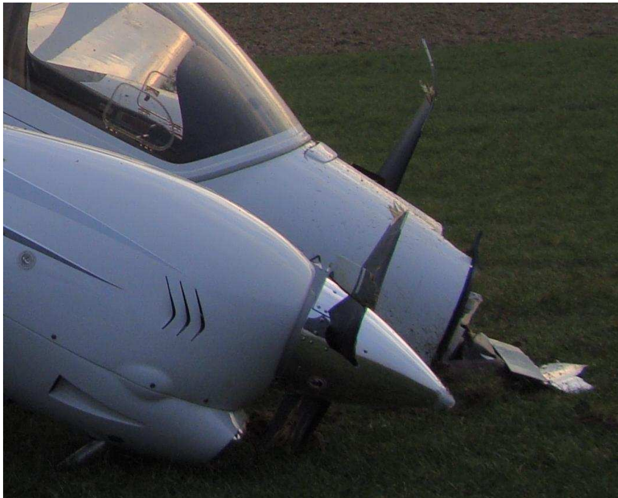
15 – Zniszczone śmigła i przednia część kadłuba – zbliżenie.
