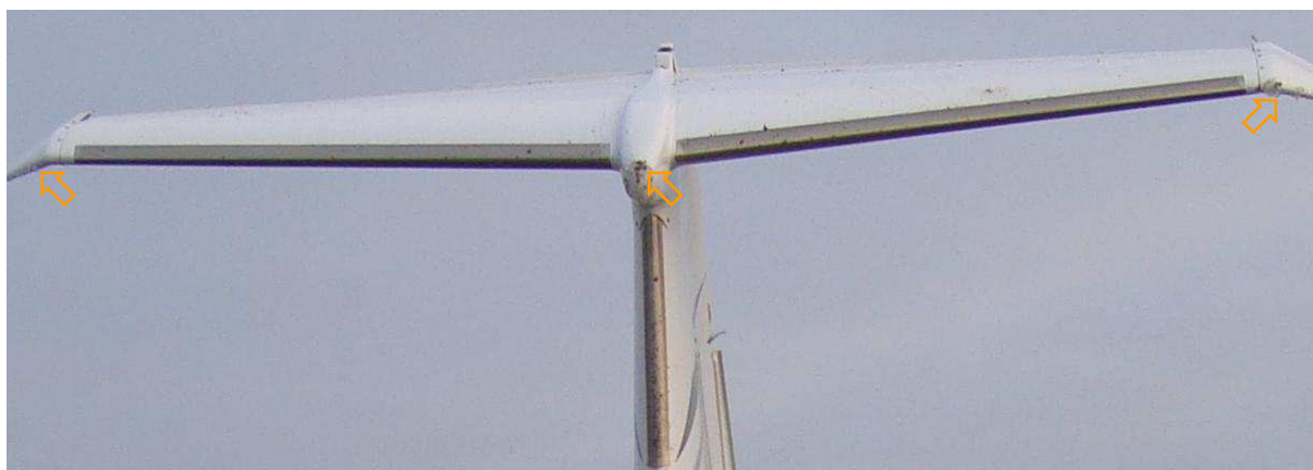
22 – Oblodzenie elementów samolotu na zdjęciach wykonanych tuż po wypadku – usterzenie poziome, widok od przodu.
