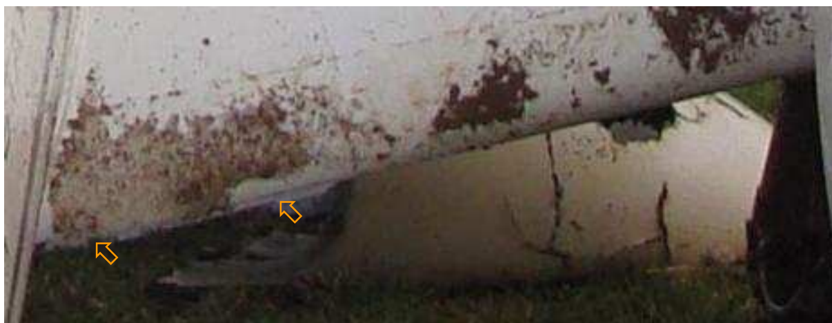
20 – Oblodzenie elementów samolotu na zdjęciach wykonanych tuż po wypadku – nosek lewego skrzydła przy kadłubie.
