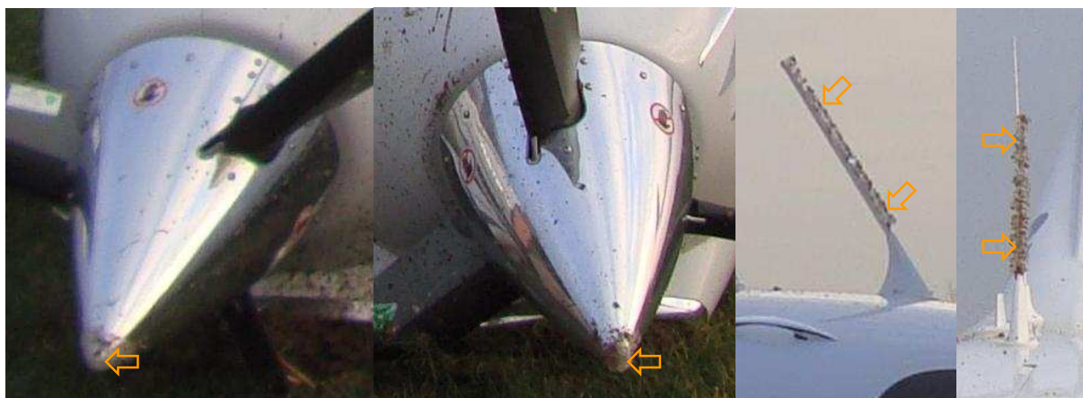
23 i 24 – Oblodzenie elementów samolotu na zdjęciach wykonanych tuż po wypadku – noski kołpaków śmigieł.
