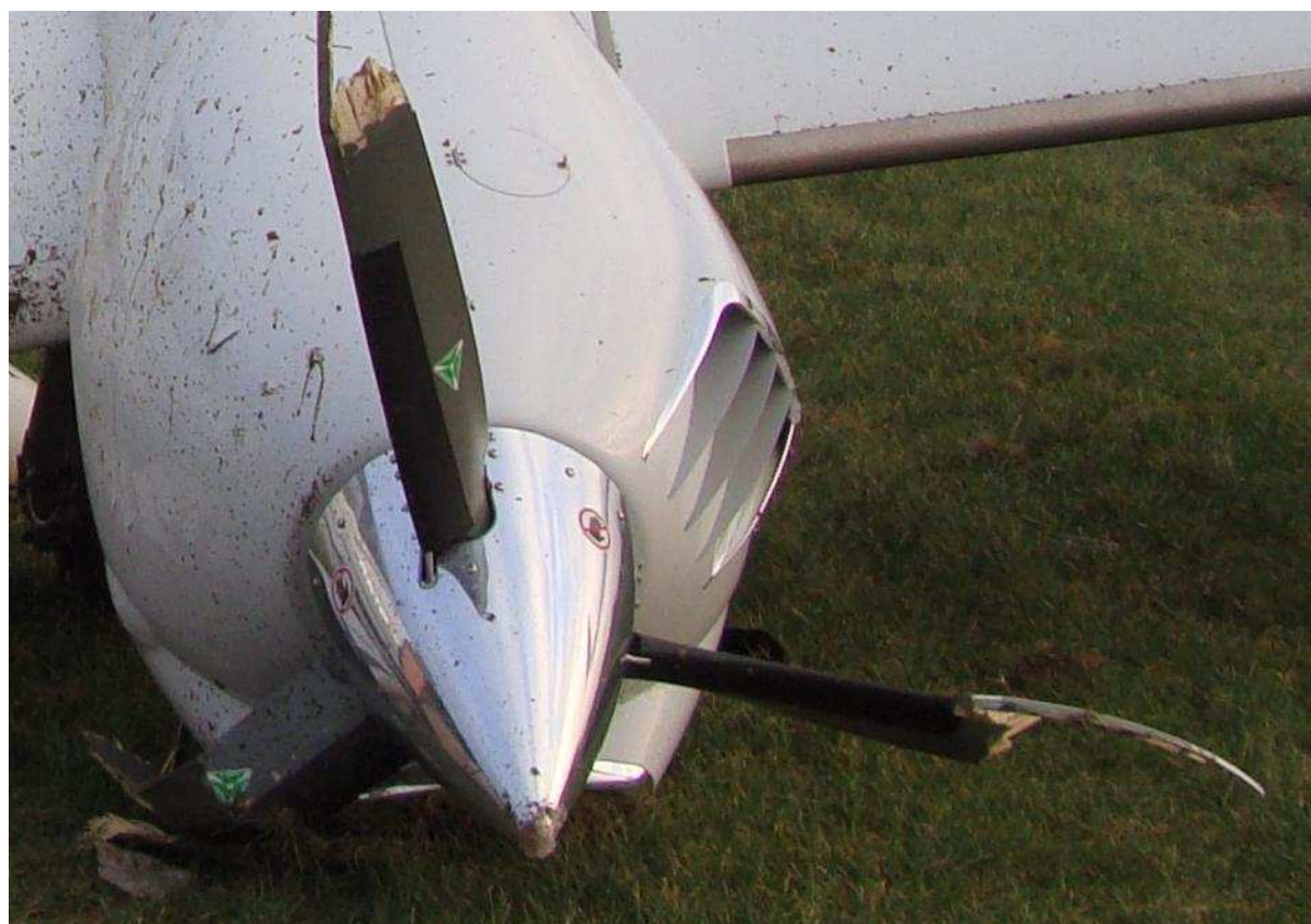
14 – Zniszczone lewe śmigło.
