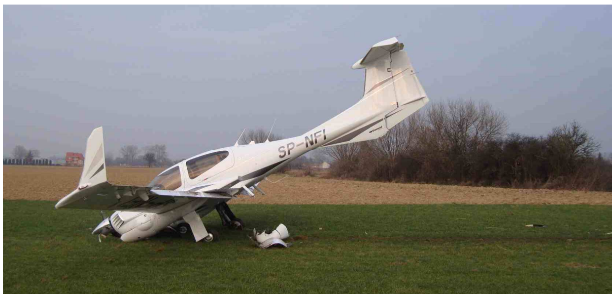
9 – Ogólny widok samolotu na miejscu wypadku, lewa strona. Dobrze widoczny ślad pozostawiony przez samolot na ziemi.
