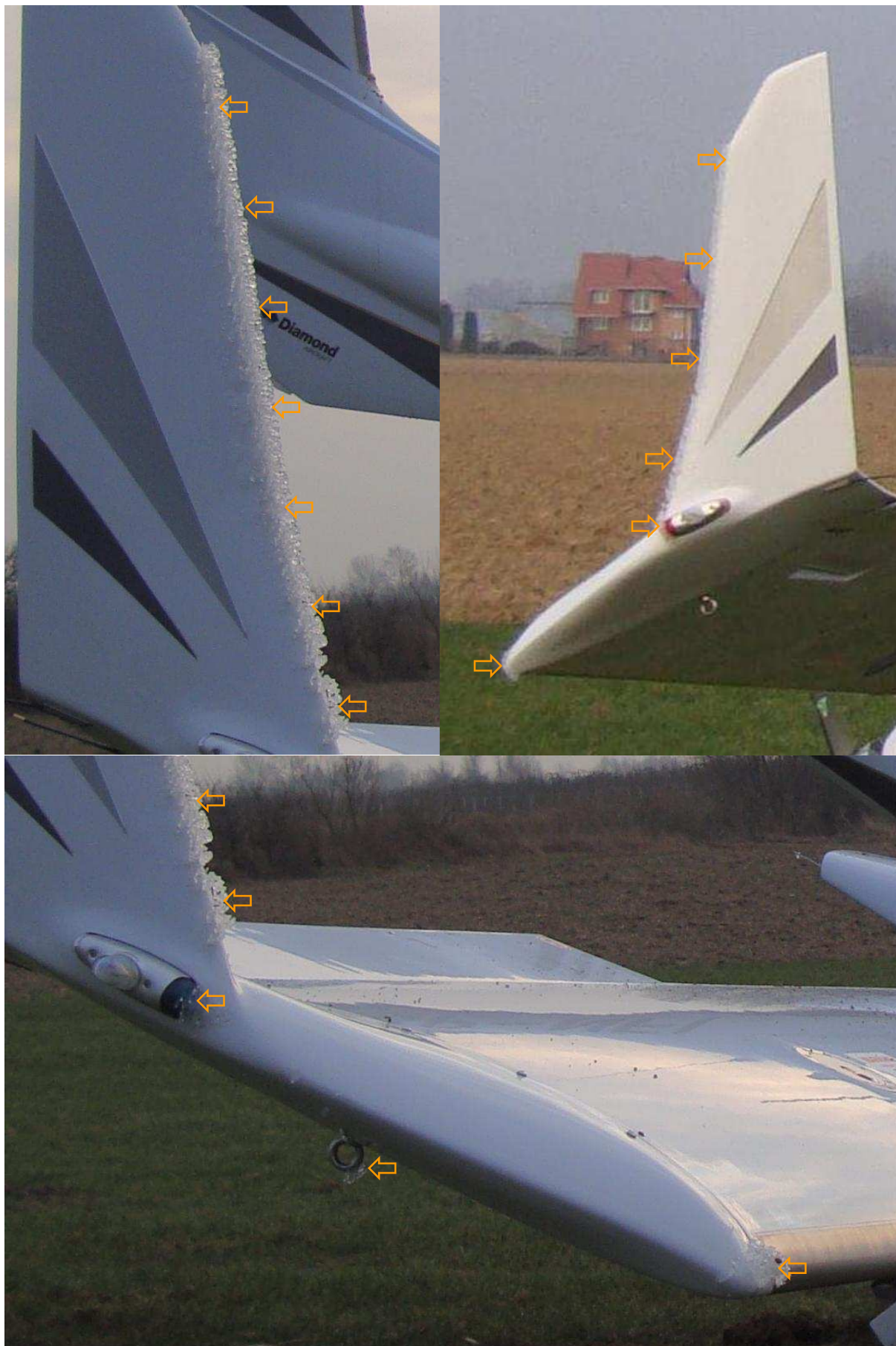
17, 18, 19 – Oblodzenie elementów samolotu na zdjęciach wykonanych tuż po wypadku – winglety i końcówki skrzydeł.
