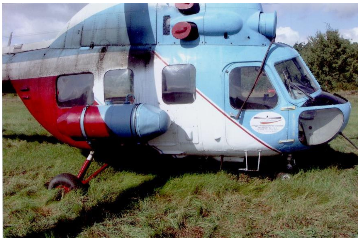
5 – Gondola kadłuba na miejscu wypadku. Widoczne znaczne zagłębienie koła prawego podwozia głównego w nawierzchnię gruntu.
