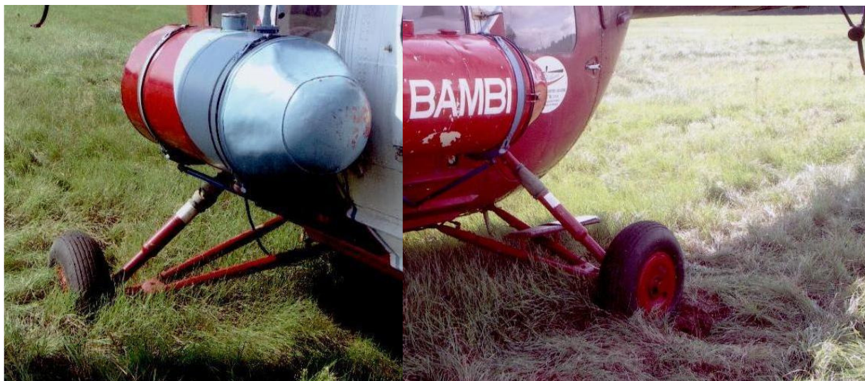
6 i 7 – Porównanie zagłębienia kół podwozia w nawierzchnię gruntu – widoczne większe zagłębienie koła prawego podwozia głównego.
