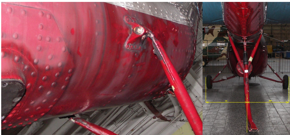
8 – Odształcenia pokrycia końcowego odcinka belki ogonowej w rejonie zamocowania płozy.
