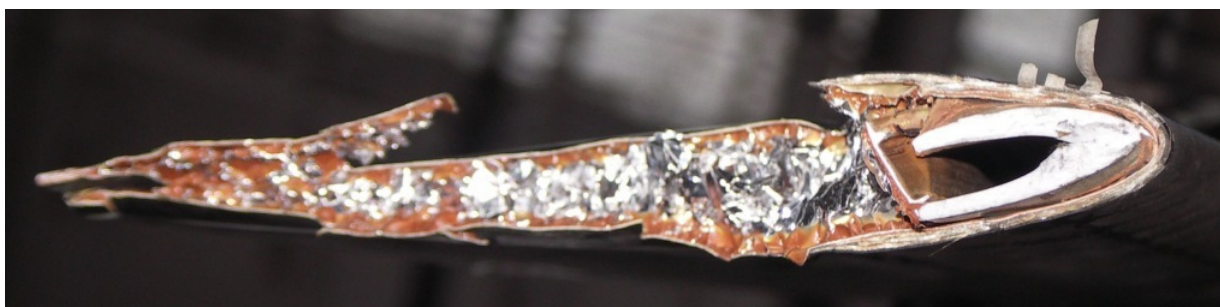
11 – Przetłoczenie jednej z łopat wirnika ogonowego.
