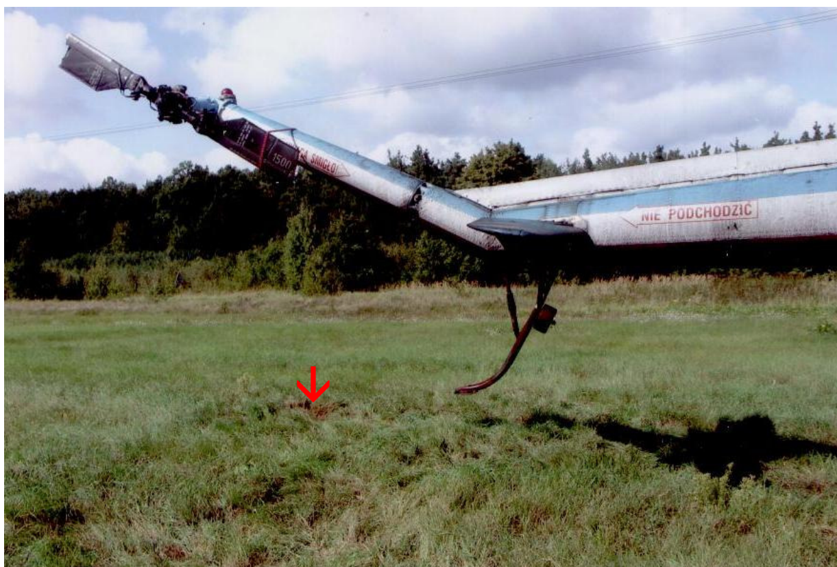
4 – Tylna część kadłuba po wypadku. Widoczny ślad płozy ogonowej na trawie i zniszczony wirnik ogonowy.
