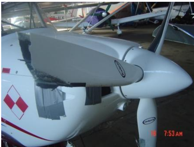
3, 4 – Uszkodzenia łopaty śmigła.
