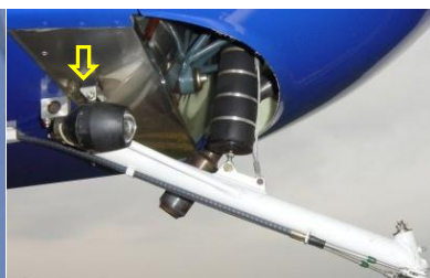
7 i 8 – Mocowanie goleni przedniego podwozia - ułożyskowanie czopów poprzeczki goleni w panewkach mocowanych sworzniami do kadłuba. [fot.8 – z innego samolotu].
