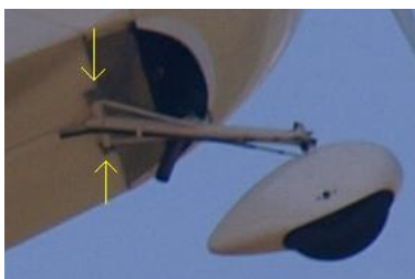
7 i 8 – Mocowanie goleni przedniego podwozia - ułożyskowanie czopów poprzeczki goleni w panewkach mocowanych sworzniami do kadłuba. [fot.8 – z innego samolotu].
