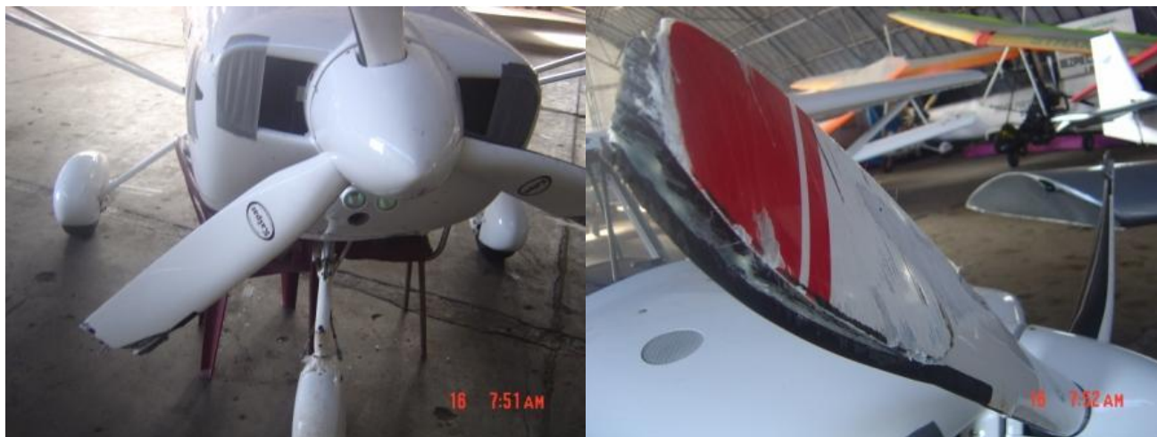
1, 2, 3, 4 – Uszkodzenia łopat śmigła [zdjęcia od 1 do 6 i 9: T.Depta, Aeroklub Ziemi Pilskiej].
