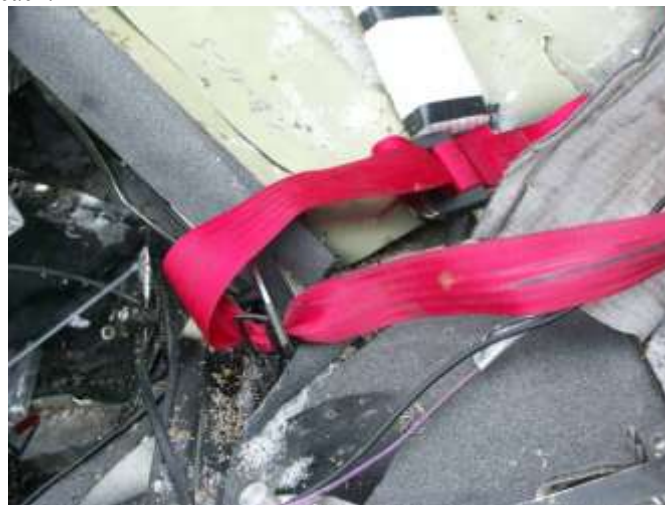
Rys. 17 Pasy pilota. Widoczne ciemne otarcia na pasie.
