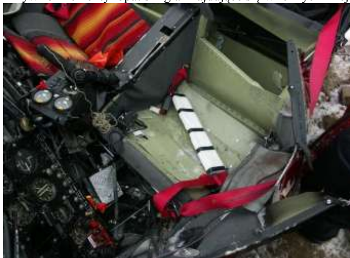
Rys. 16 Pasy pilota. Widoczne nienaruszone zamocowanie okuć do konstrukcji.
