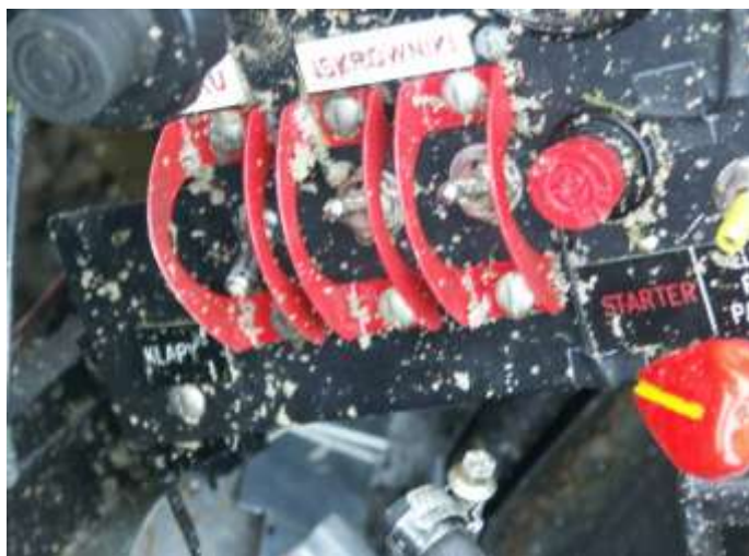
Rys. 18 Położenie głównych przełączników elektrycznych: od lewej strony akumulator wyłączony, oba iskrowniki włączone.
