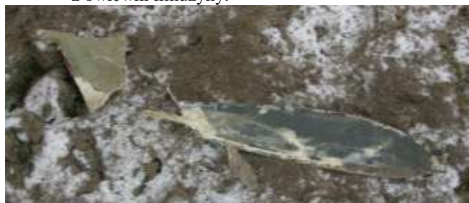
Rys. 13 Widok na elementy samolotu od strony wraku. Po prawej stronie na dole fotografii widoczna jest część ze szkła organicznego, pochodząca z owiewki limuzyny.
