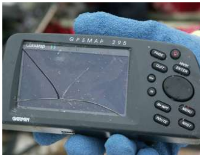
Rys. 14 Odbiornik lotniczy GPS znaleziony poza samolotem. Widoczne uszkodzenie szyby wyświetlacza.
