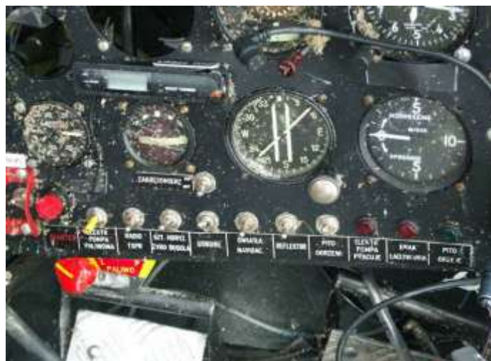
Rys. 19 Położenie pozostałych przełączników elektrycznych: pompa paliwa, radio TXPR, światła nawigacyjne i reflektor - wyłączony, sztuczny horyzont żyrobusola, światła stroboskopowe i ogrzewanie Pitota - włączone
