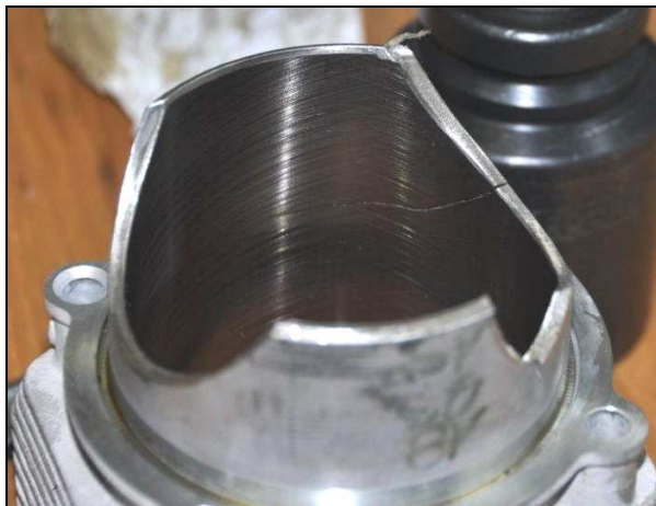
34 – Zniszczona głowica cylindra nr 1 silnika Rotax 912UL (wtórne skutki zniszczenia korbowodu).
