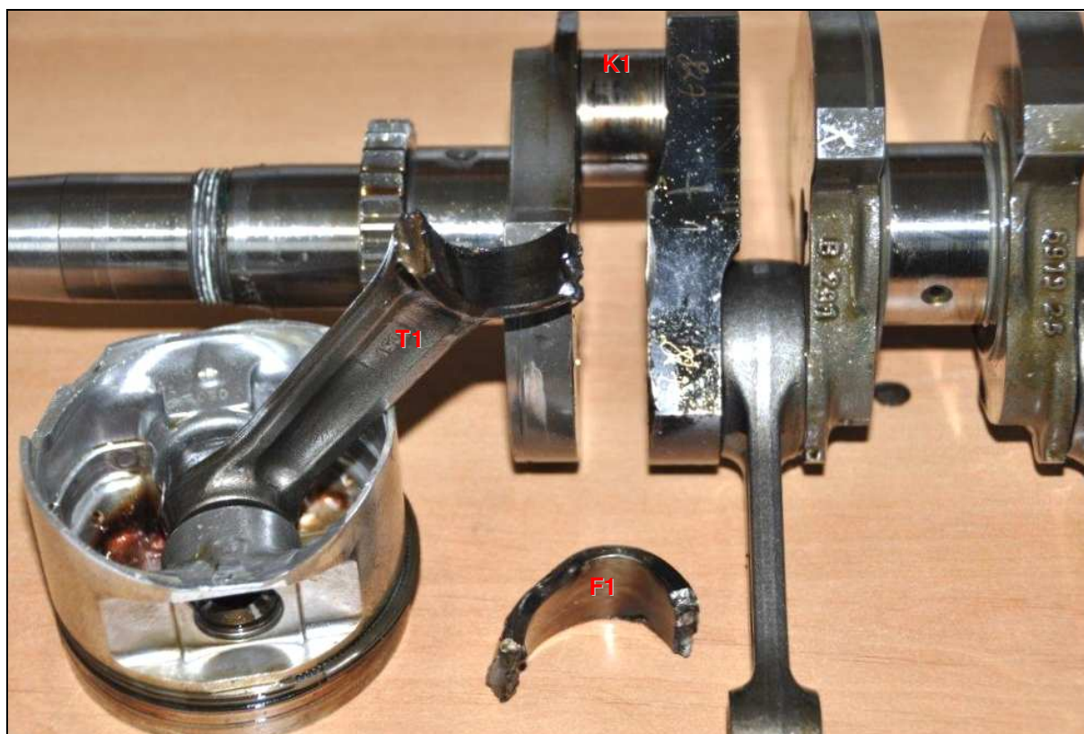
38 – Wał korbowy (z zaznaczoną korba tłoka cylindra nr 1 – K1), uszkodzony tłok cylindra nr 1 z zerwanym korbowodem (T1) i oderwany fragment korbowodu (F1).
