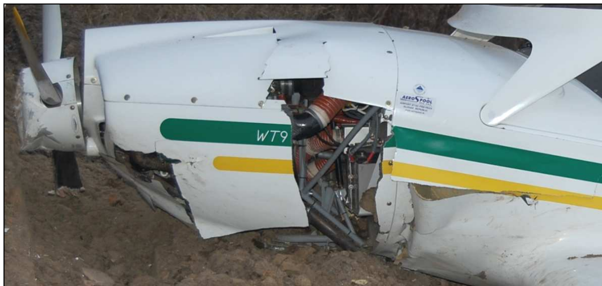
22 – Zbliżenie na uszkodzone osłony silnika i śmigło z lewej strony. Widoczne odkształcenie przegrody ogniowej i uszkodzenie skorupy strukturalnej przedniej części kadłuba za przegrodą ogniową. Zmiana położenia osi silnika świadczy o wyraźnym odkształceniu (uszkodzeniu bądź zniszczeniu) łoża silnika.
