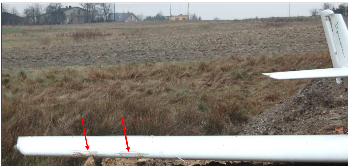
16 – Widok na prawe skrzydło od strony noska – widoczne uszkodzenia.
