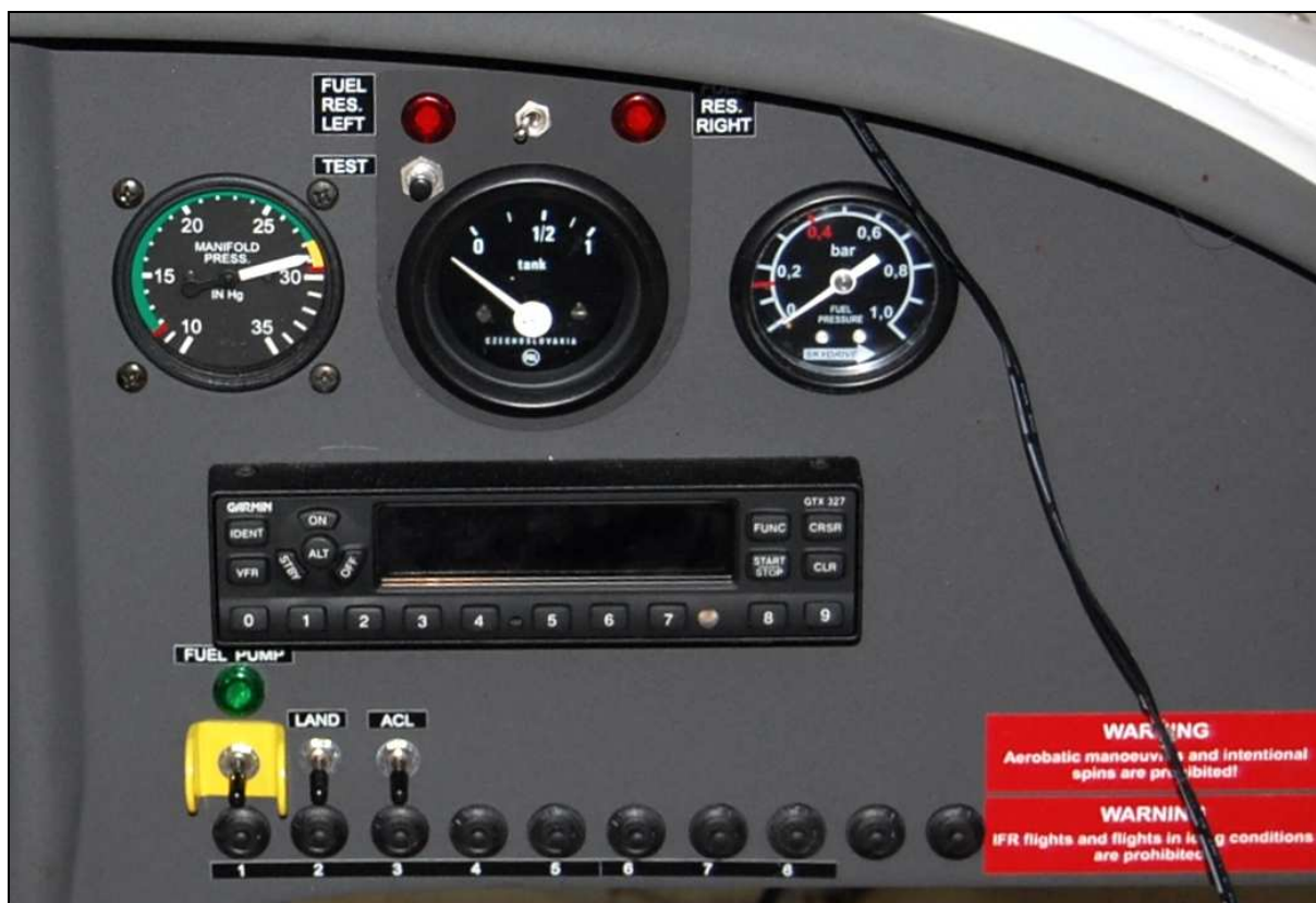
25 – Prawa część tablicy przyrządów z przyrządami kontrolnymi instalacji silnikowych i radiostacją oraz bezpiecznikami.
