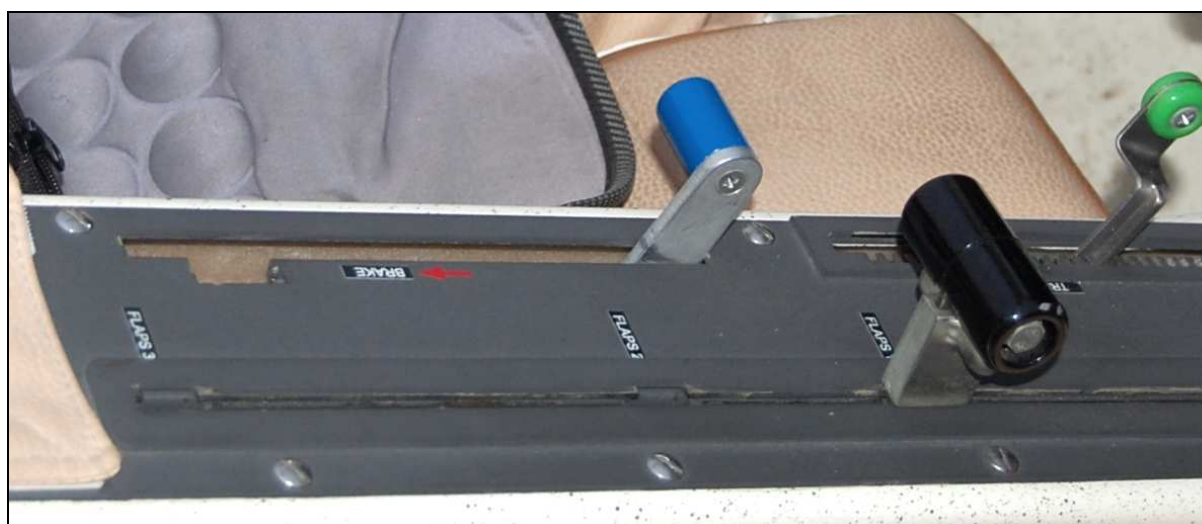
28 – Centralny pulpit poziomy między fotelami z dźwignią sterowania kłap (czarny uchwyt), dźwignią hamulców (niebieski uchwyt) i dźwignią sterowania położeniem podwozia (zielony uchwyt). Kłapy w położeniu „1”.
