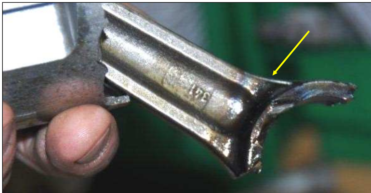
37 – Zniszczony tłok cylindra nr 1 z zerwanym korbowodem. Na korbowodzie widoczne przebarwienie spowodowane zmianami termicznym materiału wskutek znacznego przegrzania w wyniku tarcia z powodu braku doprowadzenia właściwej ilości oleju pod odpowiednim ciśnieniem do pary kinematycznej korbówód-korba cylindra nr 1.
