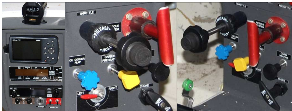
26 – Środkowa część tablicy z busolą, GPS, przyrządem FLYdat i ICOM.
