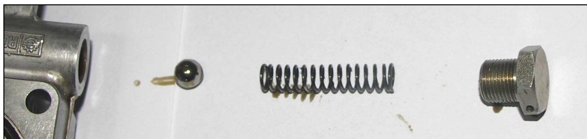
31 – Kulka, sprężynka i wkręt regulacyjny zaworu ciśnieniowego zespołu pompy olejowej silnika Rotax 912UL.
