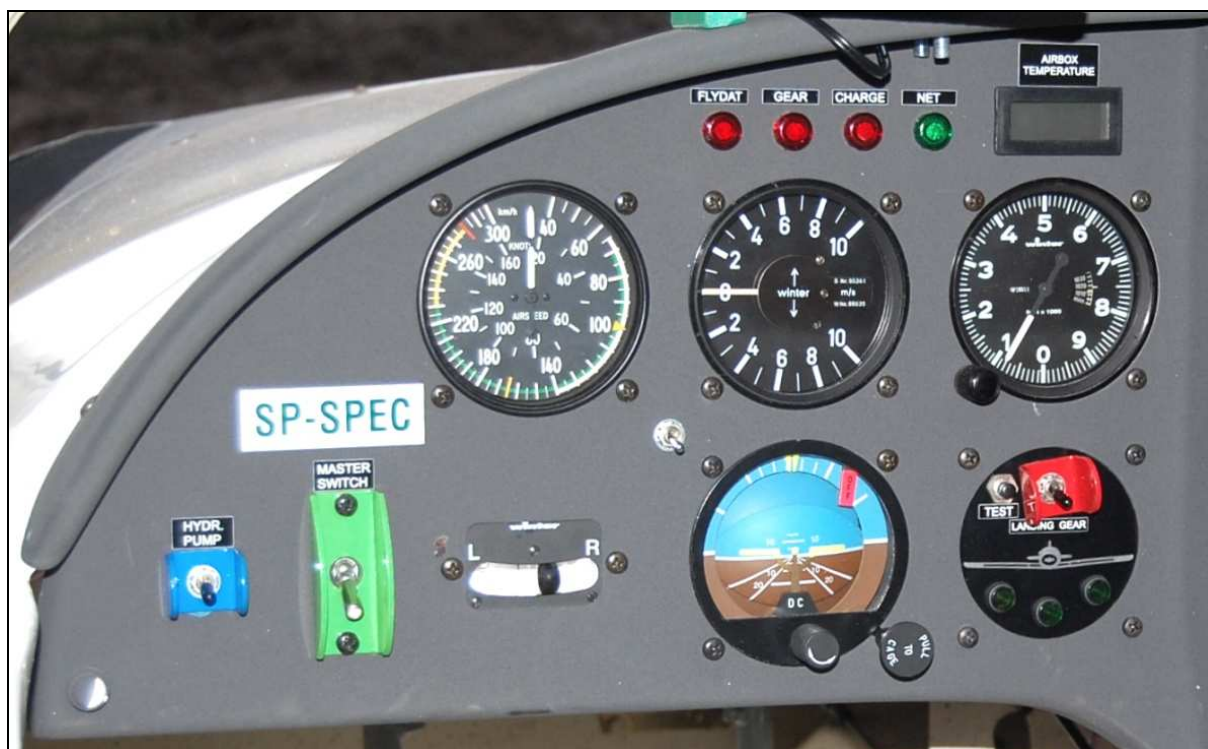
24 – Lewa część tablicy przyrządów z przyrządami pilotażowo-nawigacyjnymi.
