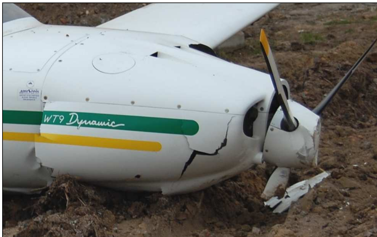
20 – Zbliżenie na uszkodzone osłony silnika i śmigło z prawej strony.
