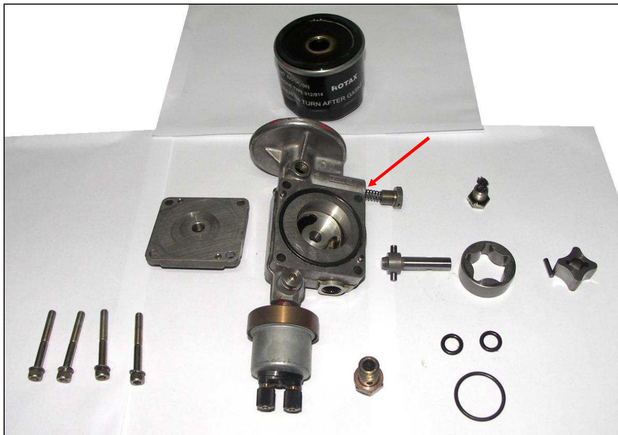
30 – Rozmontowana pompa hydrauliczna silnika Rotax 912UL. Strzałką wskazany kulkowy zawór ciśnieniowy.
