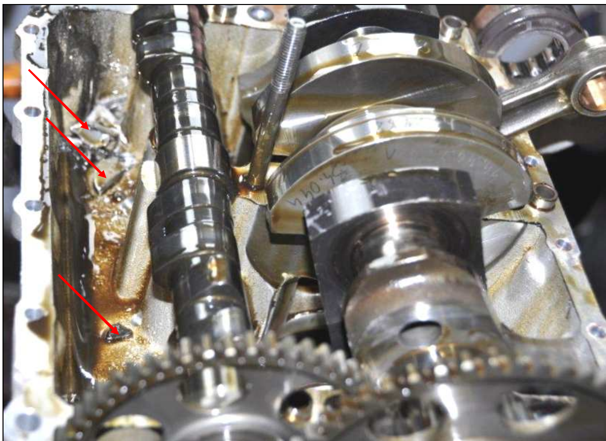
36 – Dolna część skrzyni korbowej z wałem korbowym i wałkiem rozrządu. Z lewej strony kadru widoczne odłamki zniszczonego tłoka cylindra nr 1, które wpadły do skrzyni korbowej.
