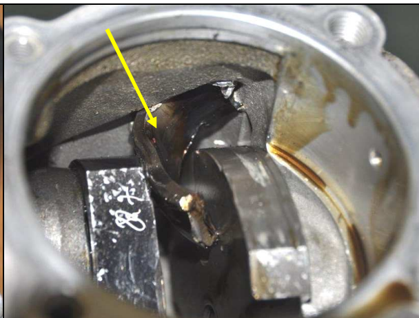
35 – Wał korbowy z korwą cylindra nr 1 (po demontażu cylindra nr 1) – widoczny odłamek korbowodu tłoka.
