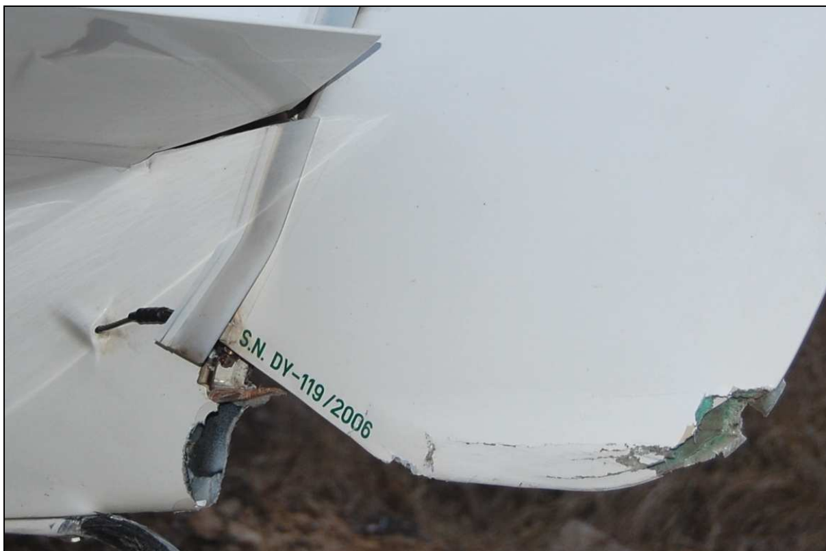
19 – Uszkodzenia dolnej części steru kierunku i zakończenia kadłuba.
