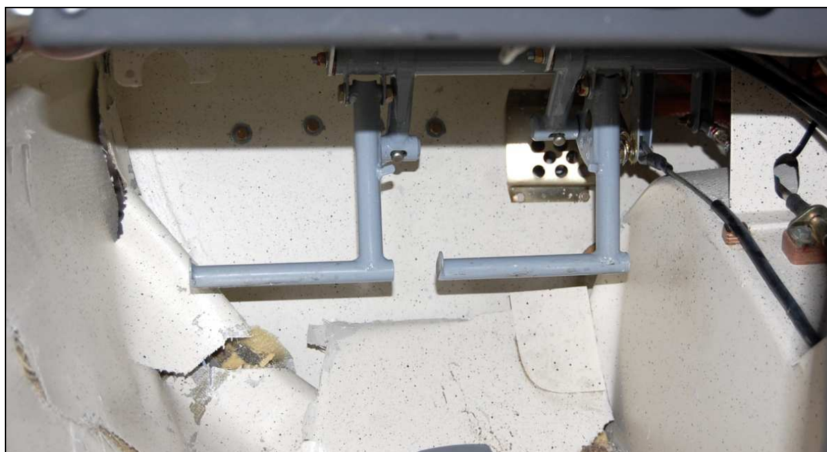
29 – Sterownice nożne lewego fotela – widoczne uszkodzenia struktury kadłuba w ich sąsiedztwie.
