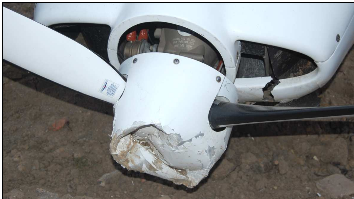
21 – Zbliżenie na osłony silnika i śmigło z kołpakiem od przodu.
