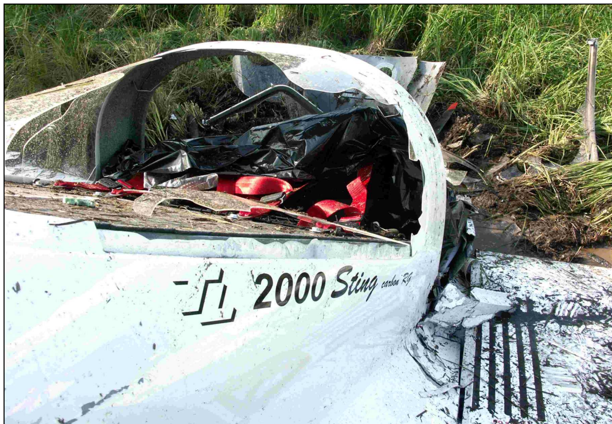
20 – Zniszczone tylne oszklenie kabiny.
