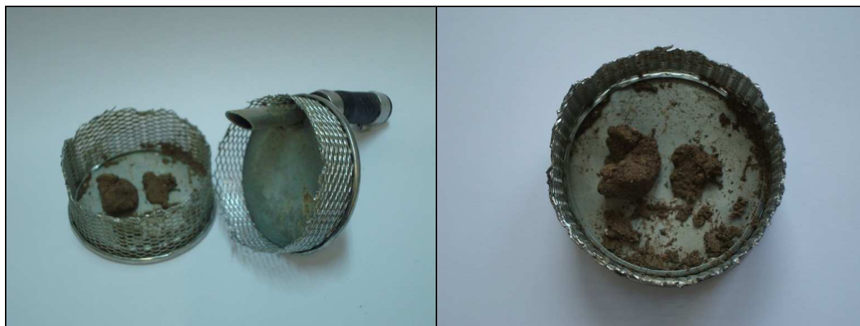
39, 40 – Filtr siatkowy paliwa po rozcięciu – bardzo dobrze widoczne grudki zanieczyszczeń [foto: ITWL].
