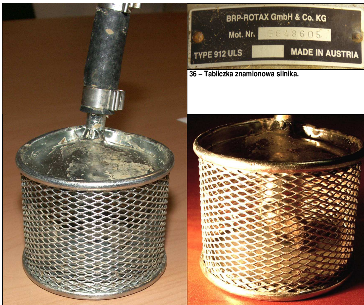
37, 38 – Filtr siatkowy paliwa, po prawej dobrze widoczna grudka zanieczyszczeń na metalowej nakrętce, która znalazła się wewnątrz filtra i powodowała utrudnienie w dopływie paliwa do silnika.
