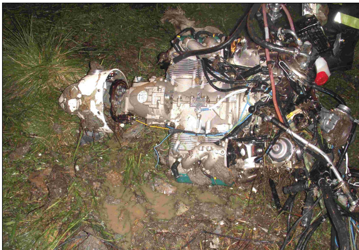
34 – Silnik po wyciągnięciu z bagna na miejscu wypadku, widok od góry.
