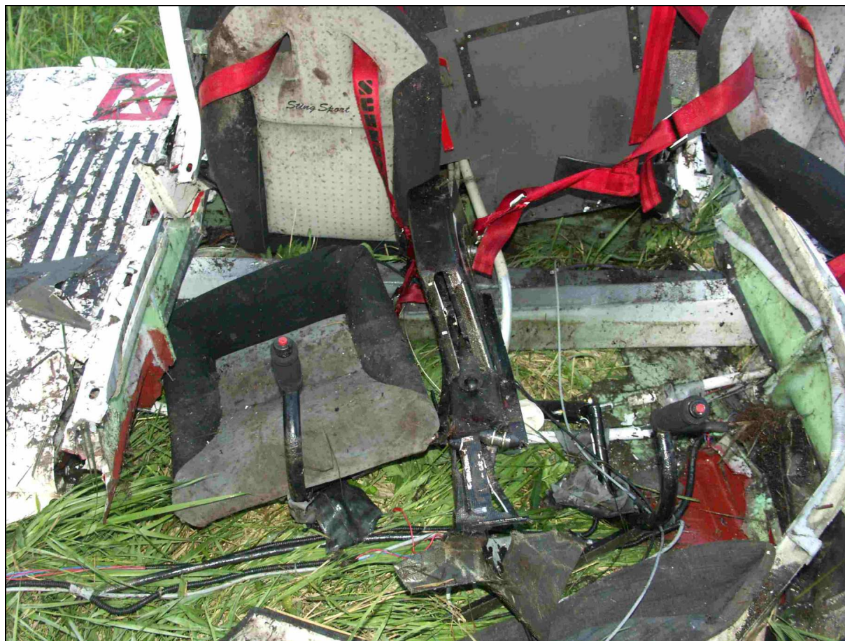
25 – Wnętrze kabiny od przodu (samolot po ewakuacji z miejsca wypadku).
