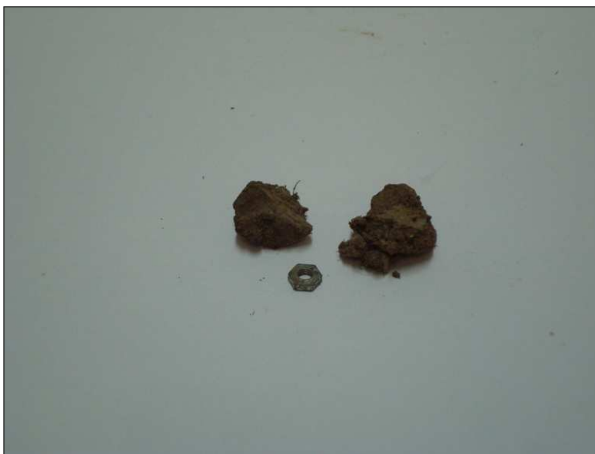
41 – Zanieczyszczenia filtra siatkowego paliwa – w jednej z grudek stwierdzono obecność widocznej na zdjęciu nakrętki M3 [foto: ITWL].
