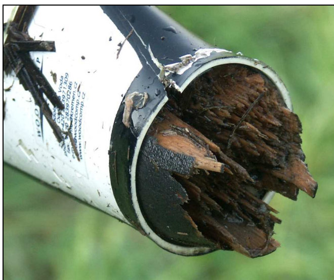
29 – Złamanie nasady jednej z łopat śmigła.
