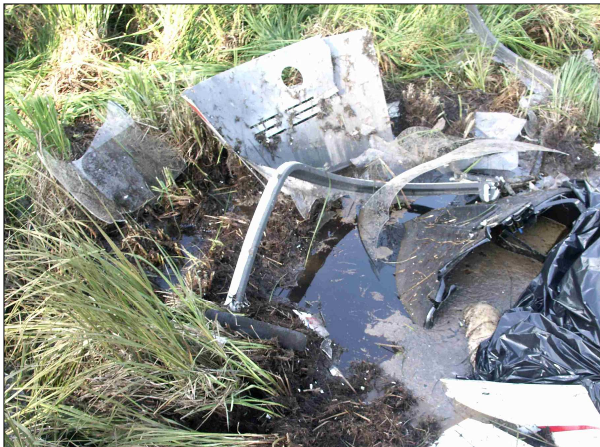
21 – Szczątki przedniej części kadłuba, widoczna górna osłona silnika i rama oszklenia.
