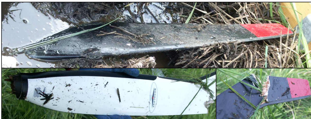
26, 27, 28 – Łopaty zniszczonego śmigła, pokazane złamanie końcówki łopaty.
