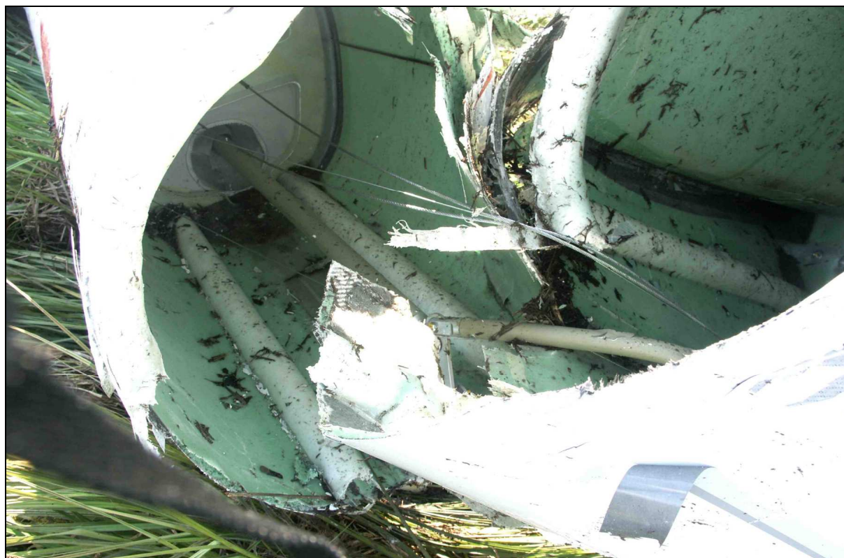
14 – Miejsce przełamania kadłuba w zbliżeniu, widoczne wewnątrz tylnej części kadłuba.
