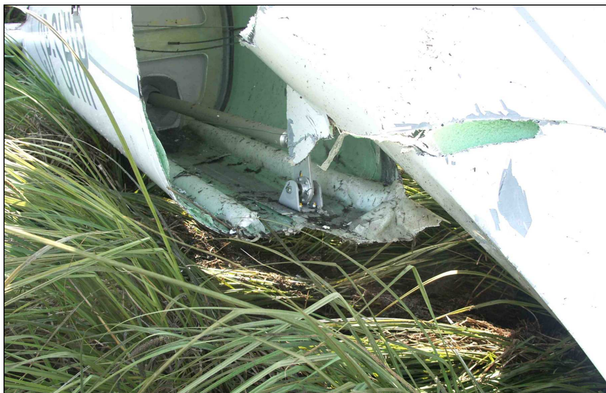
13 – Miejsce przełamania kadłuba w zbliżeniu.
