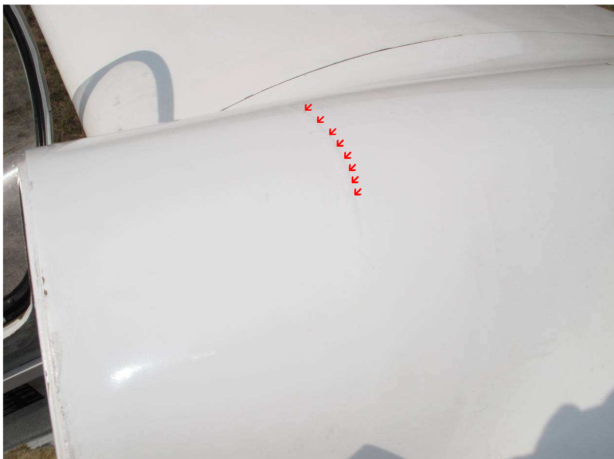
23 – Pęknięcie pokrycia na grzbiecie kadłuba za kabiną [oznaczone czerwonymi strzałkami].
