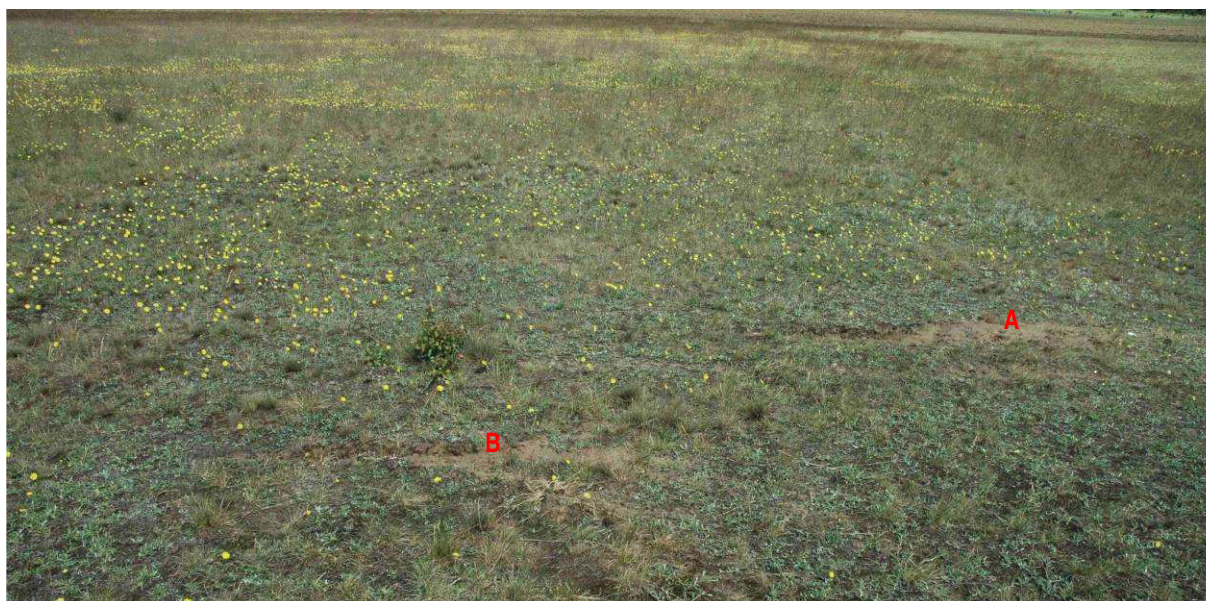
9 – Ślad przyziemienia, widok z prawej strony od linii lądowania. A – ślad przedniej części kadłuba i podwozia głównego, B – ślad podpory ogonowej. Zdjęcie wykonane 8 dni po wypadku. Ślady świadczą o przyziemieniu z wyraźnym trawersem. [foto: PKBWL]
