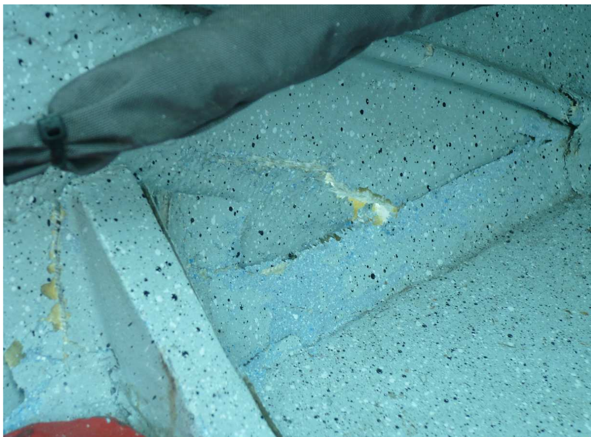
29 – Wnętrze przedniej kabiny, lewa strona. Widoczne pęknięcia i rozklejenia - zbliżenie.
