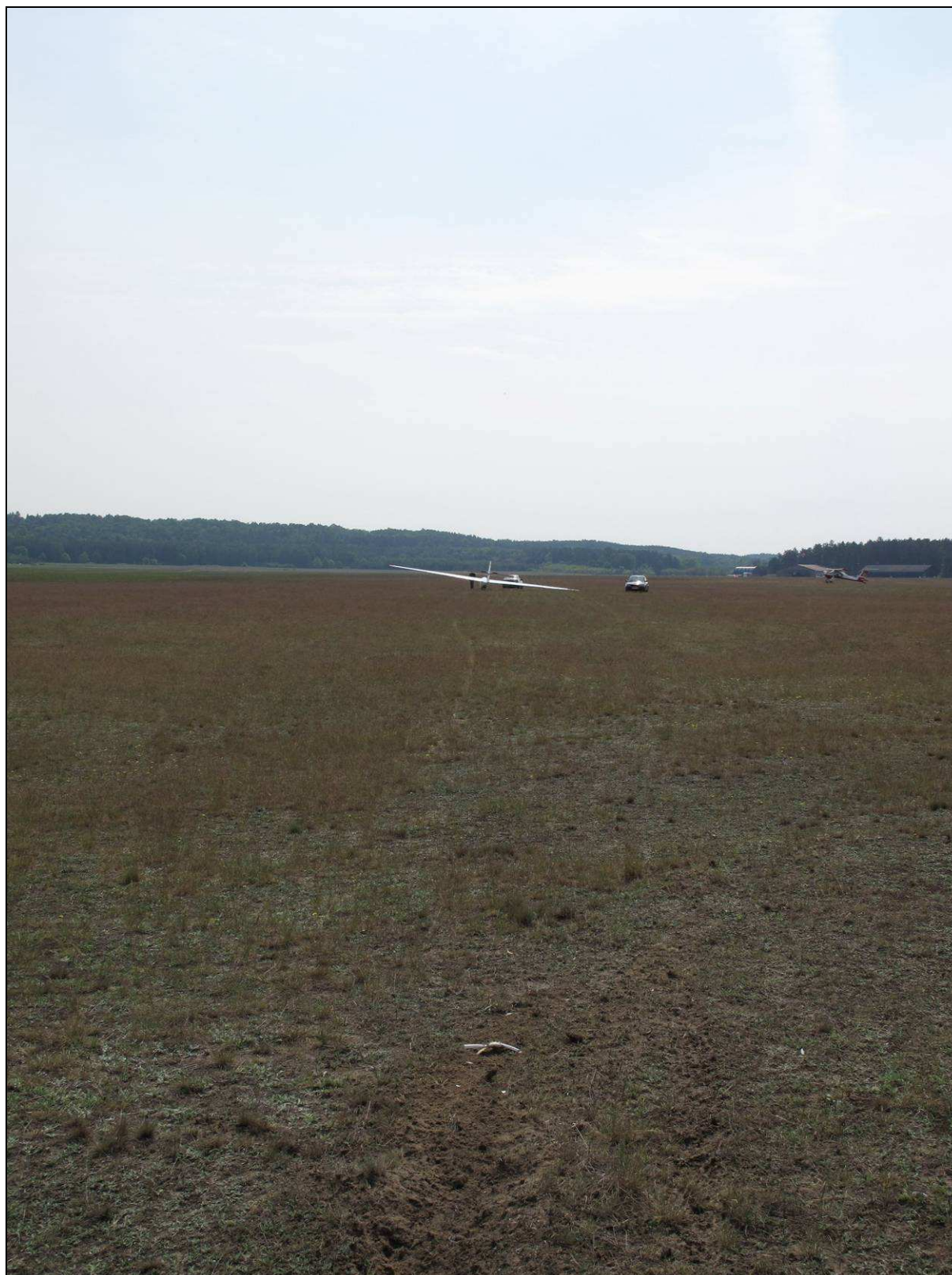
4 – Widok w kierunku lądowania szybowca. Na pierwszym planie ślad uderzenia przednią częścią kadłuba i szczątki owiewki koła przedniego, dalej wyraźnie widoczny ślad podwozia na dobiegu.
