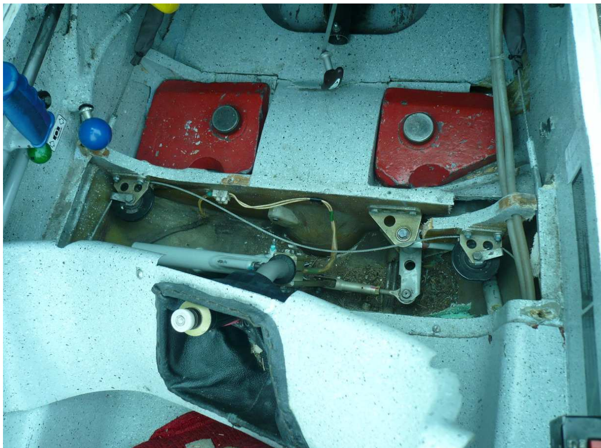
30 – Wnętrze przedniej kabiny po zdjęciu osłony układu sterowania ręcznego. Widoczne pęknięcia i rozklejenia.
