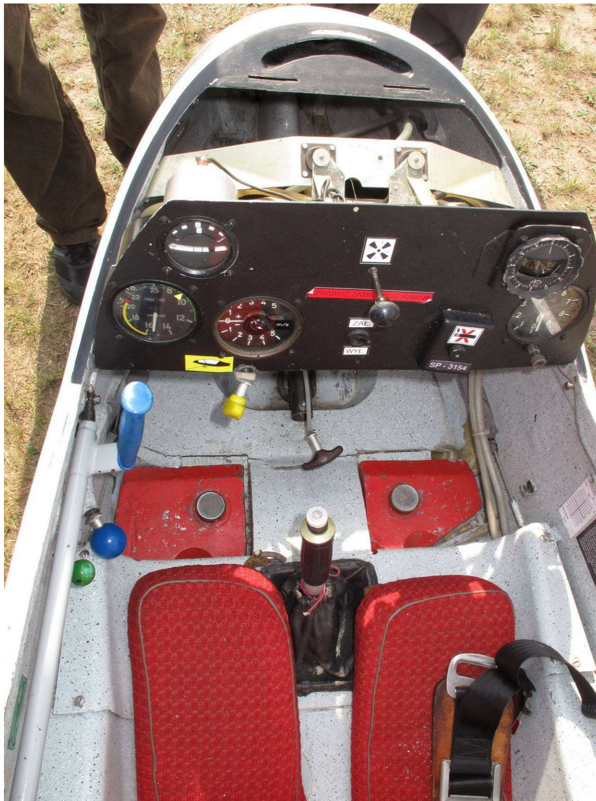
24 – Wnętrze przedniej kabiny. Widoczne pęknięcia i rozklejenia przed ciężarkami balastu.
