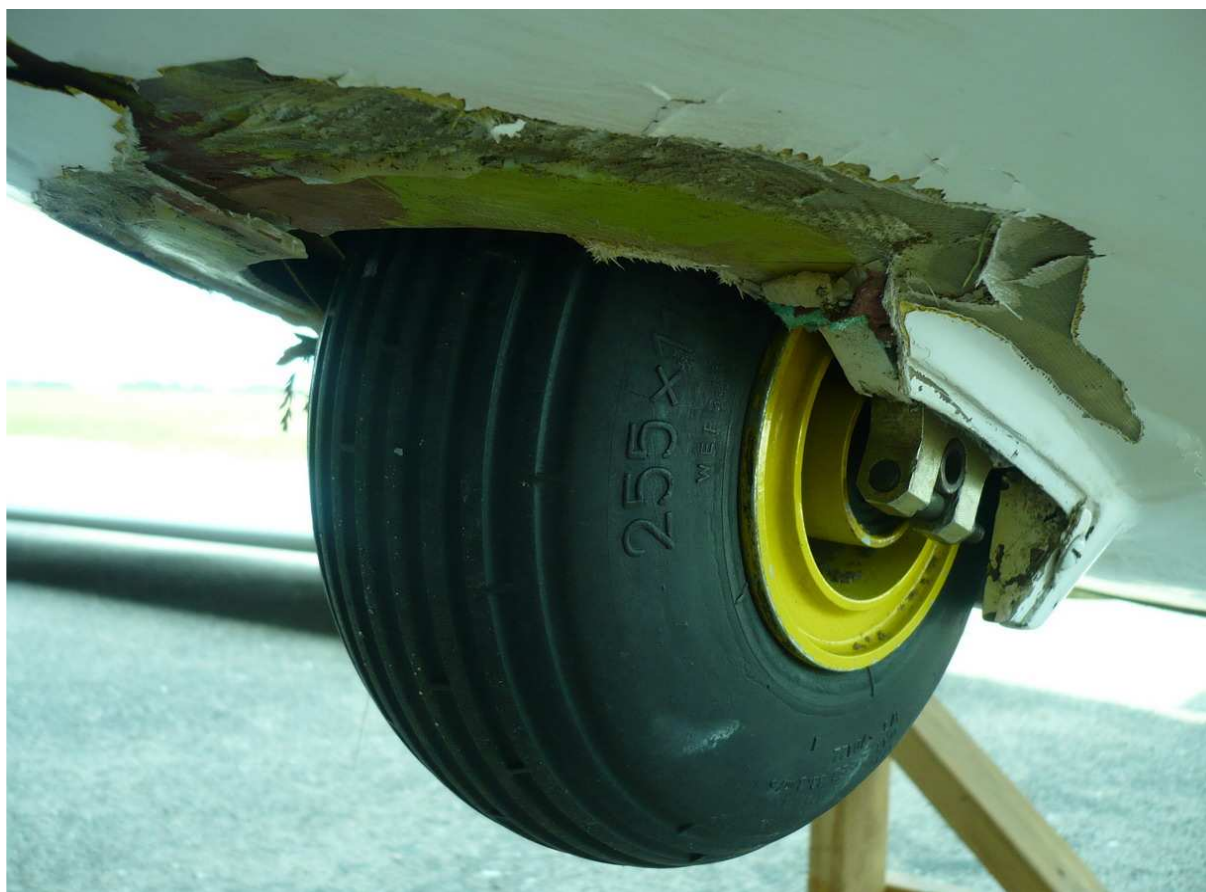
20 – Uszkodzenia w pobliżu przedniego koła podwozia, lewa strona.
