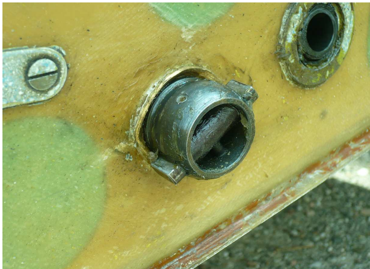
38 – Żebro nasadowe spływowe lewego skrzydła – zbliżenie na złącza sterowania.
