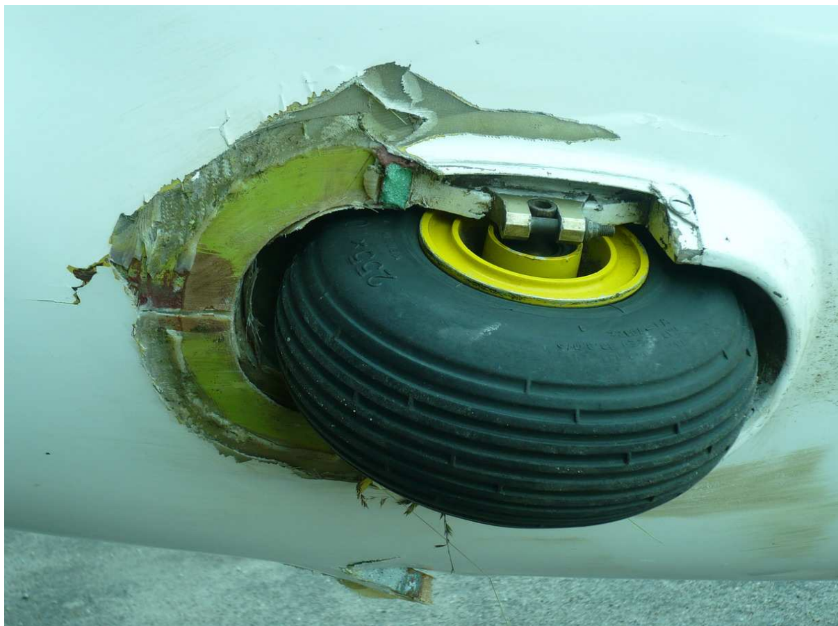
21 – Uszkodzenia w pobliżu przedniego koła podwozia, widok od spodu.
