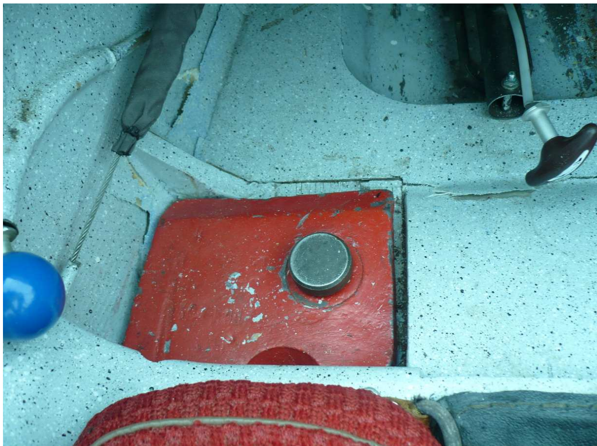
28 – Wnętrze przedniej kabiny, lewa strona. Widoczne pęknięcia i rozklejenia - zbliżenie.
