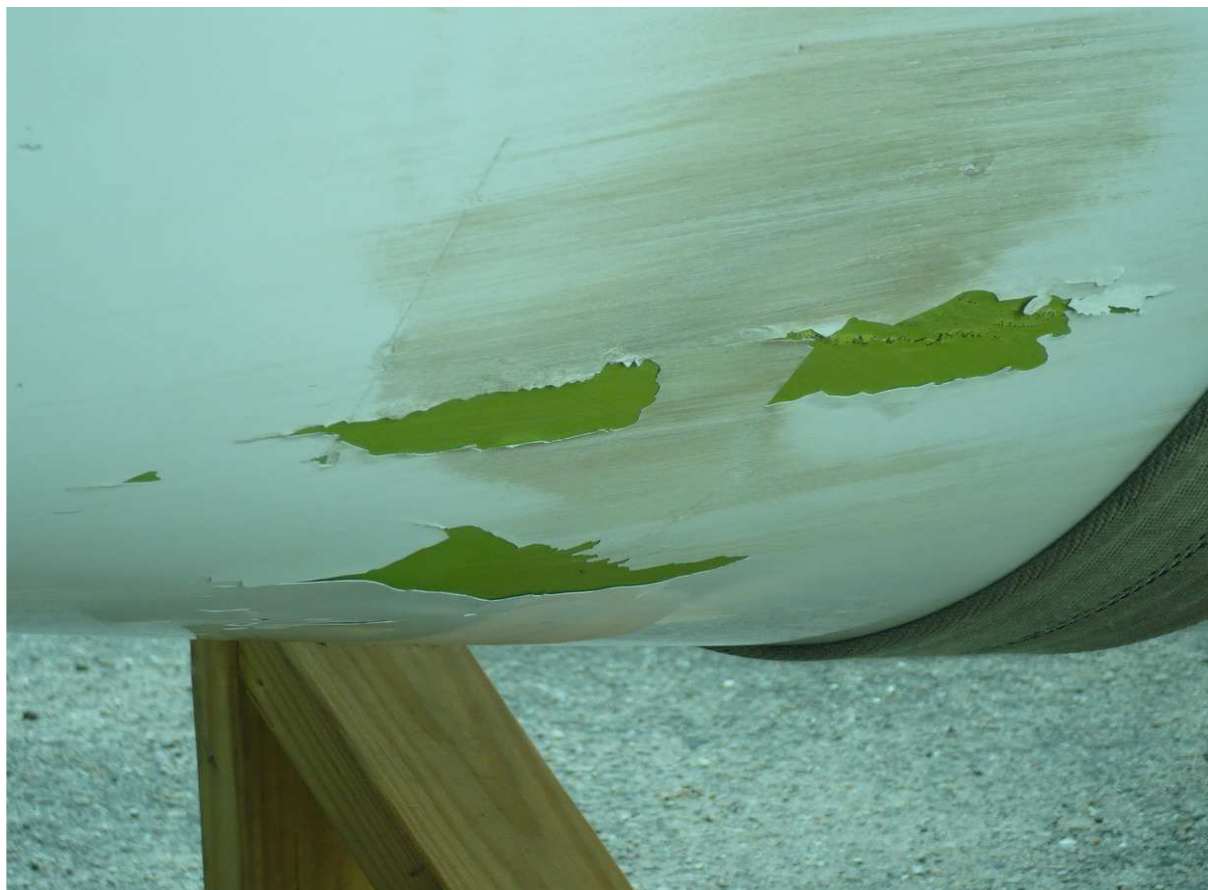
18 – Otarcie pokrycia lakierniczego na spodzie przedniej części kadłuba.
