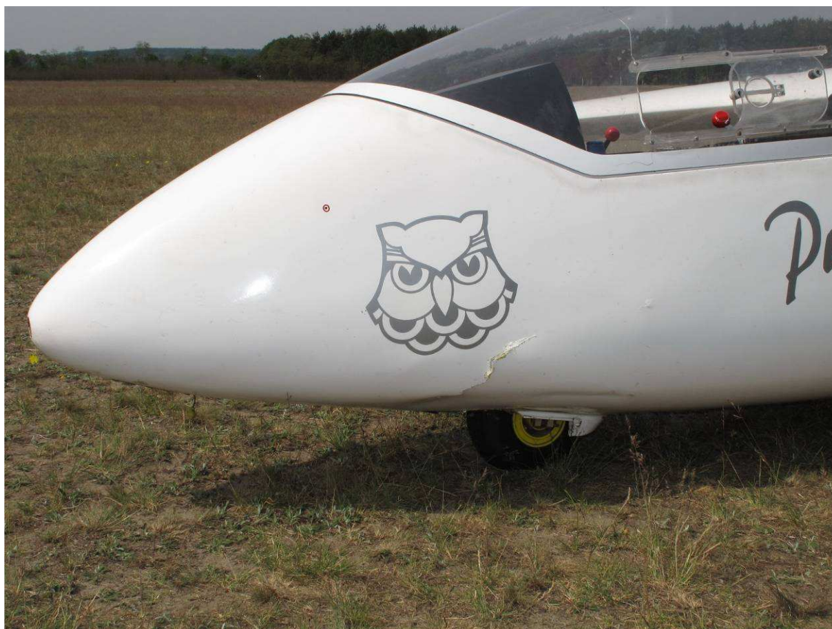
14 – Przód kadłuba, lewa strona – zbliżenie. Widoczne pęknięcie pokrycia w pobliżu przedniego koła podwozia.
