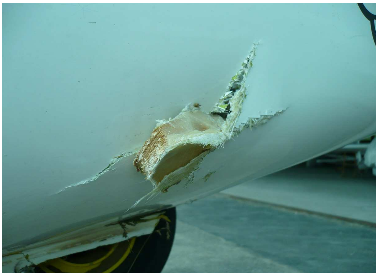
17 – Pęknięcie pokrycia przedniej części kadłuba z prawej strony – zbliżenie. Przebicie pokrycia elementem wręgi.
