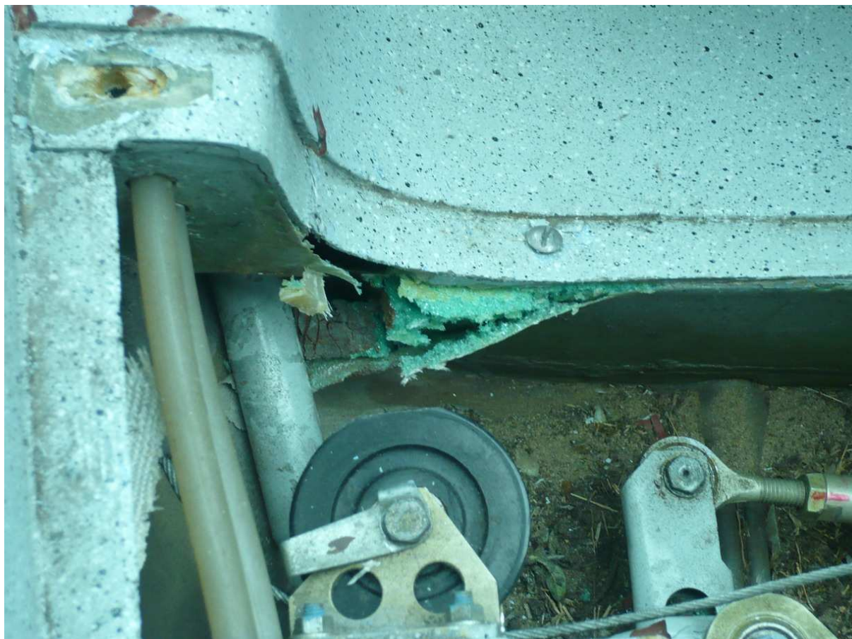
32 – Prawa strona przedniej kabiny po zdjęciu osłony układu sterowania ręcznego. Widoczne uszkodzenia.
