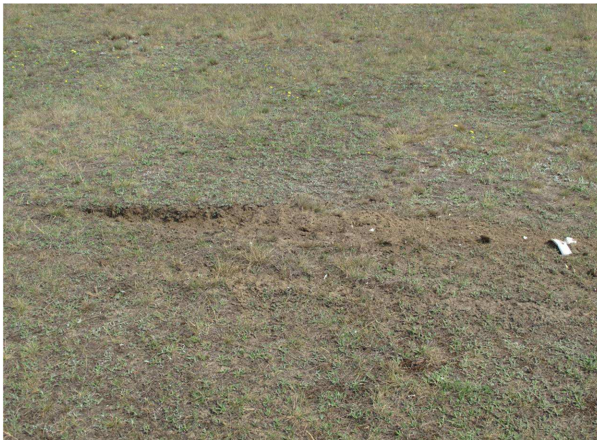
6 – Ślad uderzenia przednią częścią kadłuba i szczątki owiewki koła przedniego – widok z boku.
