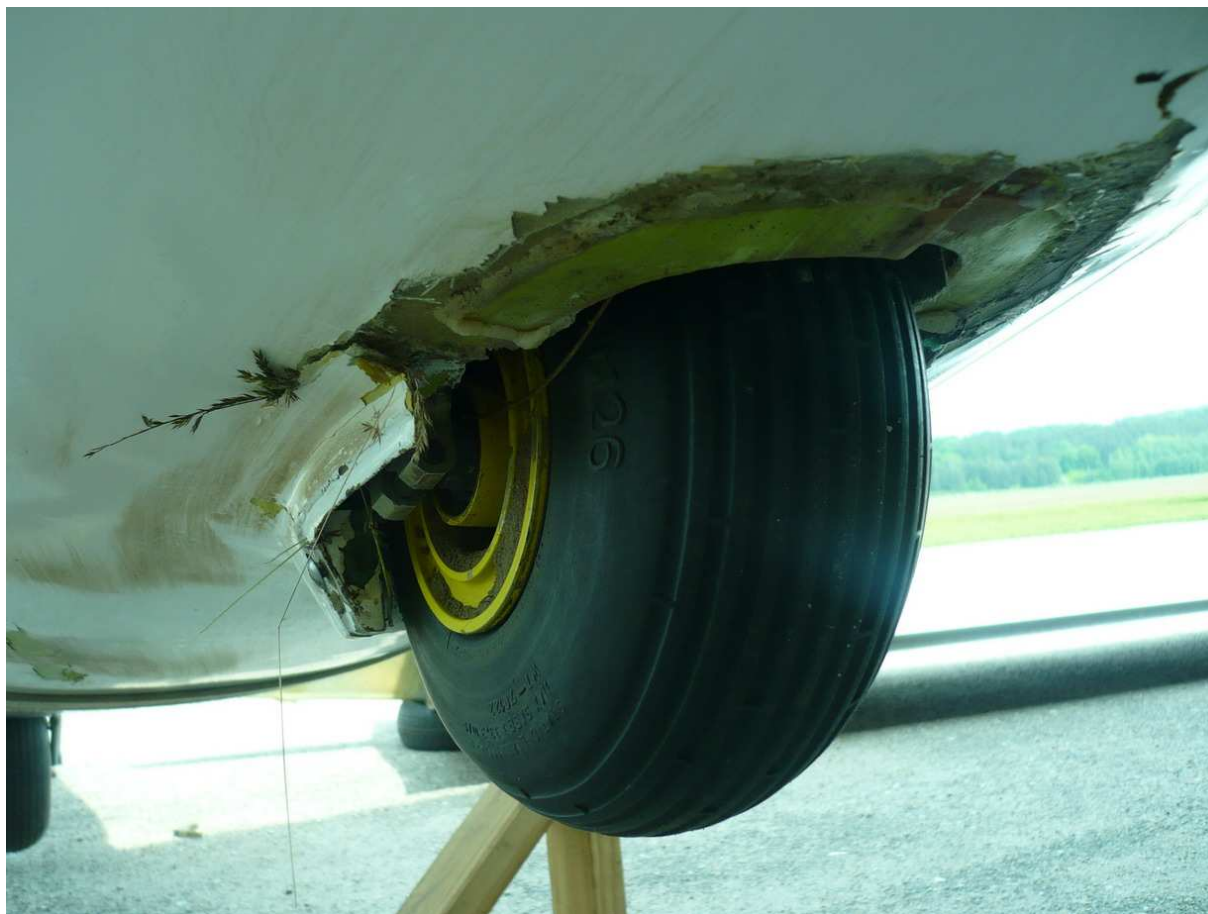
19 – Uszkodzenia w pobliżu przedniego koła podwozia, prawa strona.
