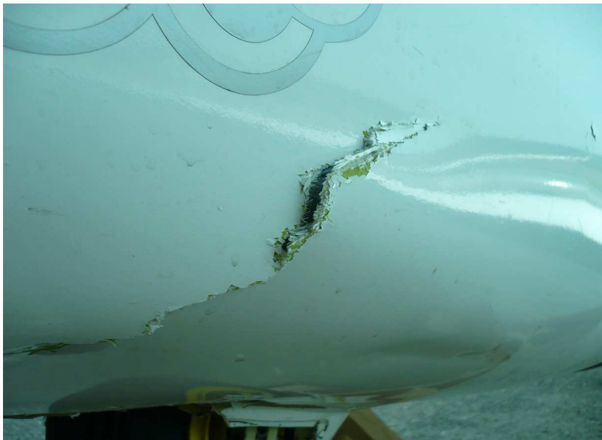
16 – Pęknięcie pokrycia przedniej części kadłuba z lewej strony – zbliżenie.
