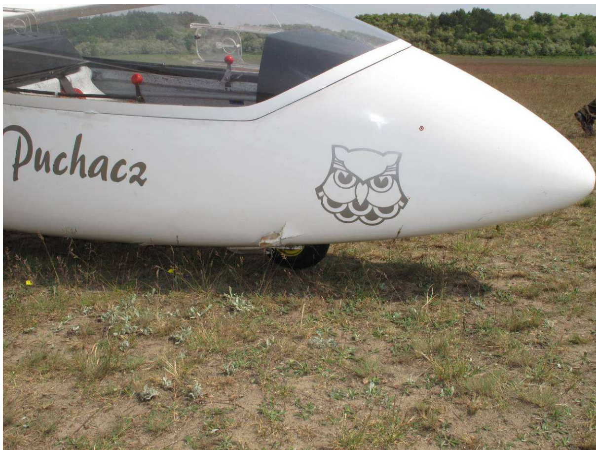
15 – Przód kadłuba, prawa strona – zbliżenie. Widoczne pęknięcie pokrycia w pobliżu przedniego koła podwozia.
