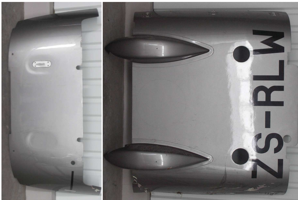
33 i 34 – Dolne pokrywy kadłuba po zdemontowaniu. Na jednej z nich poprzednie znaki rozpoznawcze.
