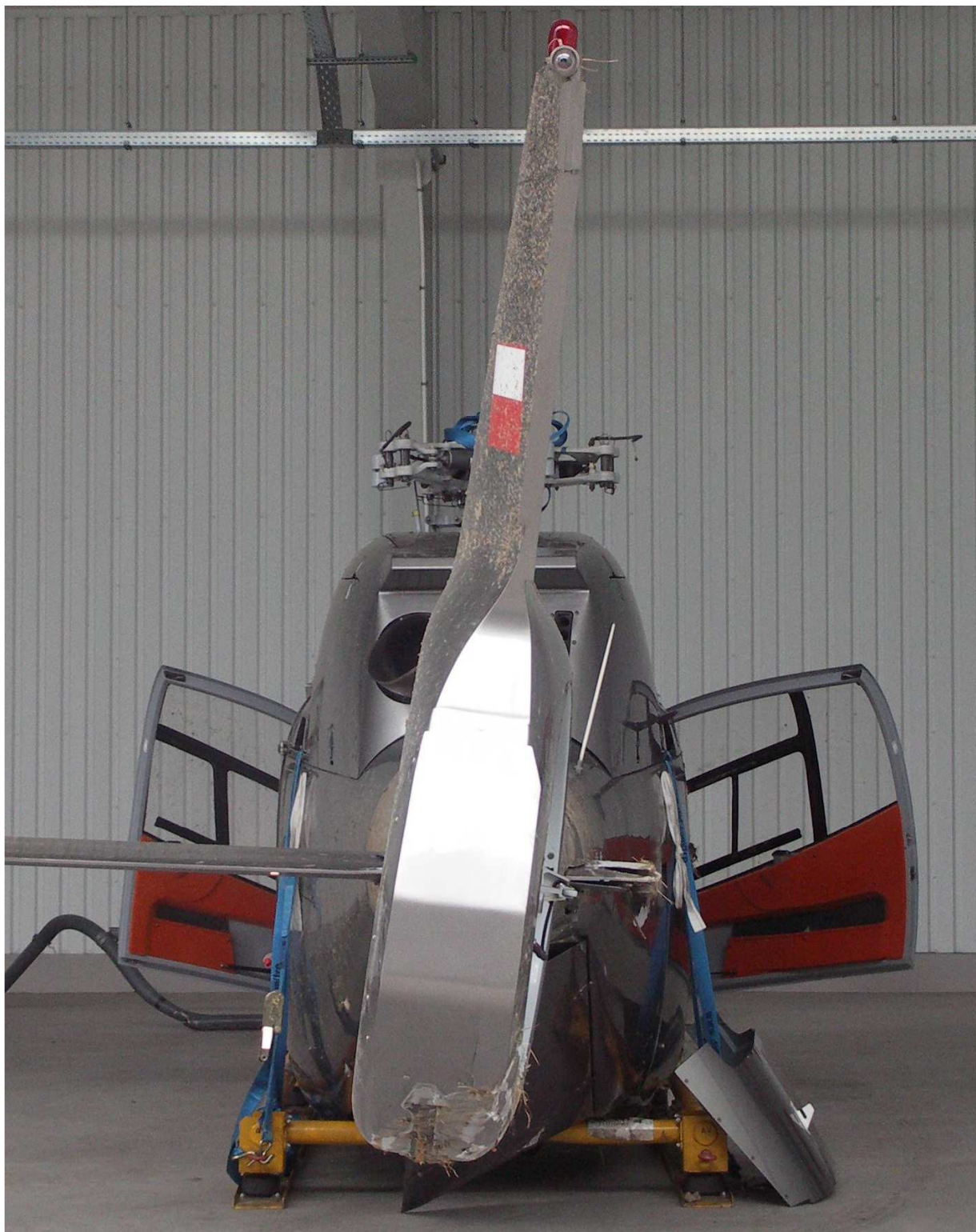
22 – Widok na śmigłowiec od tyłu. Zwraca uwagę skrzywienie kadłuba wskutek skrętnego zniszczenia belki ogonowej.
