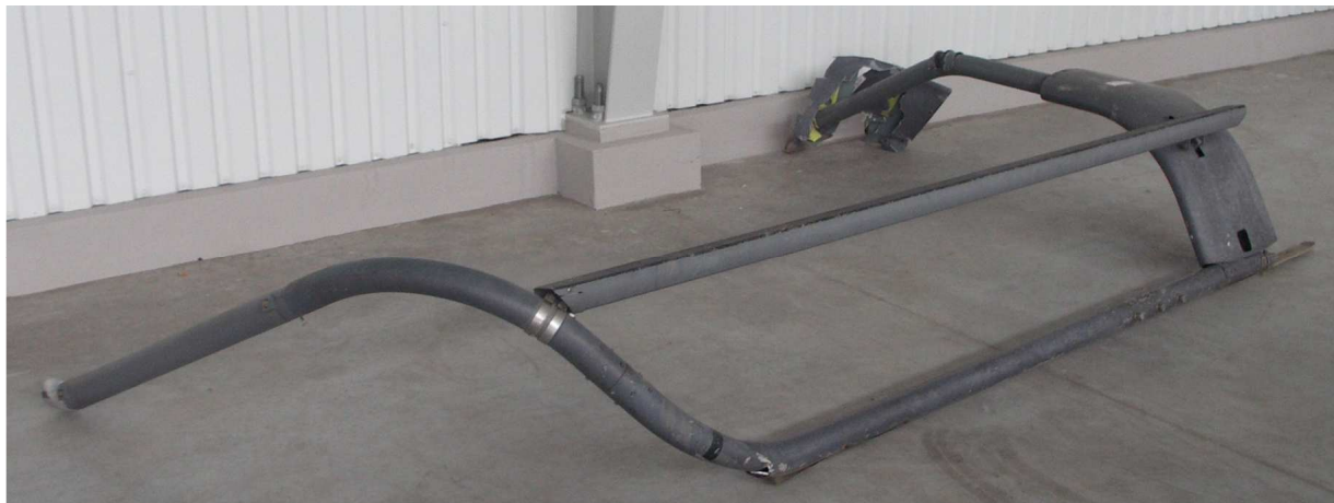
25 – Zniszczone podwozie po zdemontowaniu.
