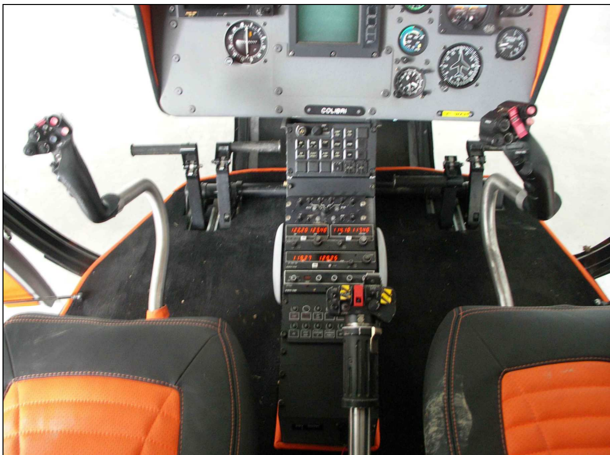
49 – Wnętrze kabiny, widok na tablicę przyrządów, pulpit centralny i sterownice.
