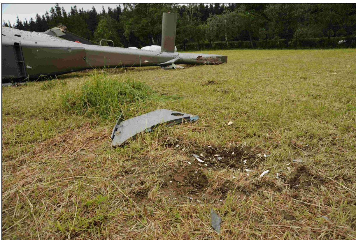
17 – Ślad płozy ogonowej i odłamana płetwa statecznika pionowego.
