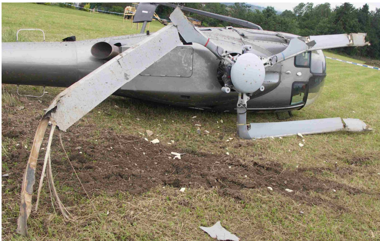
20 – Zniszczony wirnik główny i jego ślady na ziemi.
