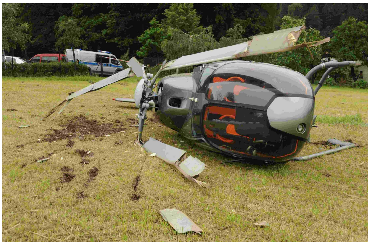
19 – Ślady łopat wirnika głównego na ziemi, świadczące o obrocie śmigłowca wokół osi pionowej z jednoczesnym przewracaniem się na prawą stronę.
