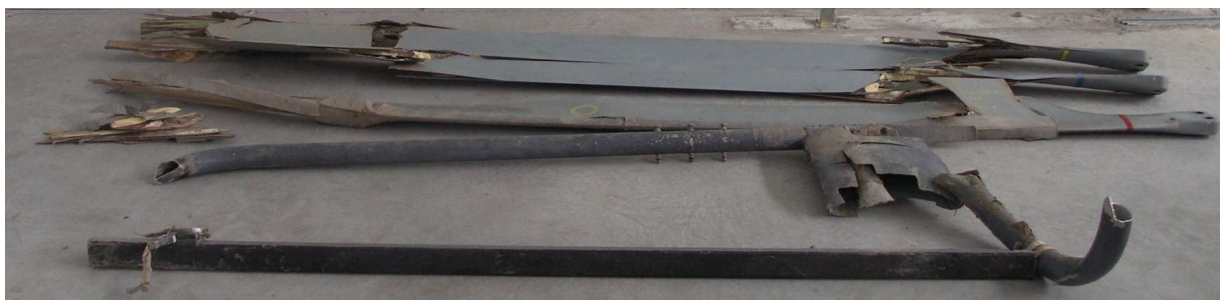
26 – Zniszczone podwozie po zdemontowaniu. Na drugim planie zniszczone łopaty wirnika głównego.
