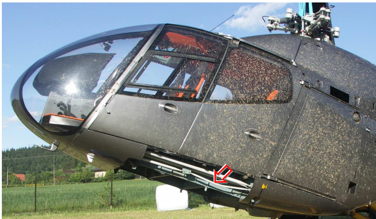
35 – Kadłub śmigłowca unoszony dźwigiem na miejscu wypadku. Widoczne uszkodzenie (wyboczenie) popychacza sterowania wirnikiem głównym.
