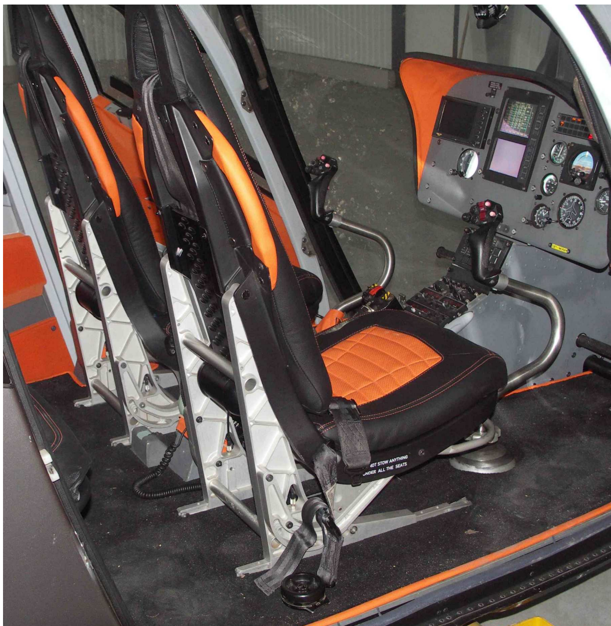
47 – Zbliżenie zawieszenia przednich foteli – widać, że nie nastąpiło ich przemieszczenie pionowe w prowadnicach tłumiących.
