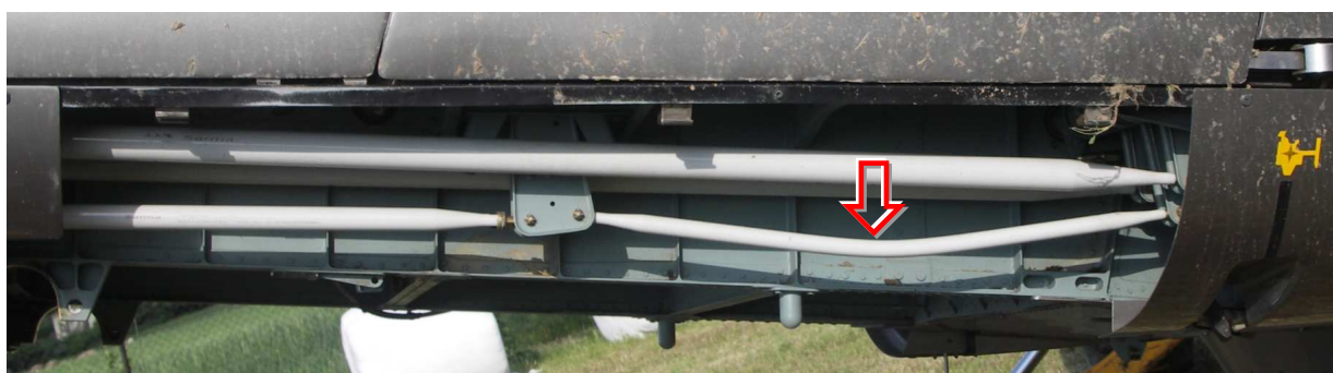
36 – Zbliżenie fragmentu kadłuba, pokazujące wyboczony popychacz sterowania wirnikiem głównym.
