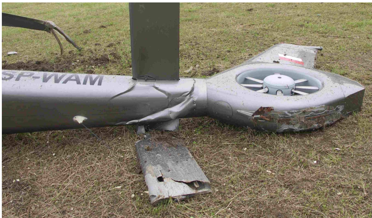
18 – Uszkodzenia tylnej części kadłuba. Widoczne ukręcenie z nadłamaniem belki ogonowej i złamana prawa część statecznika poziomego oraz uszkodzenia obudowy fenestronu po odłamaniu płetwy statecznika pionowego z płożą ogonową.
