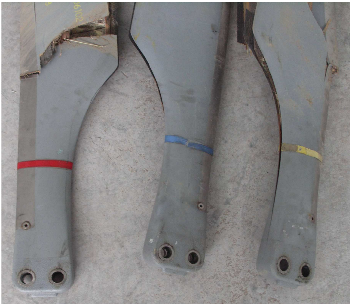
21 – Nasady łopat wirnika głównego po demontażu.
