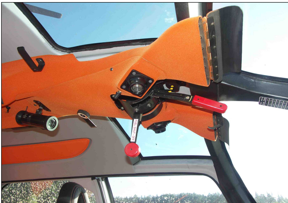
46 – Górny pulpit sterowania – widoczna dźwignia zaworu odcinającego dopływ paliwa do silnika w położeniu „zamknięte”.
