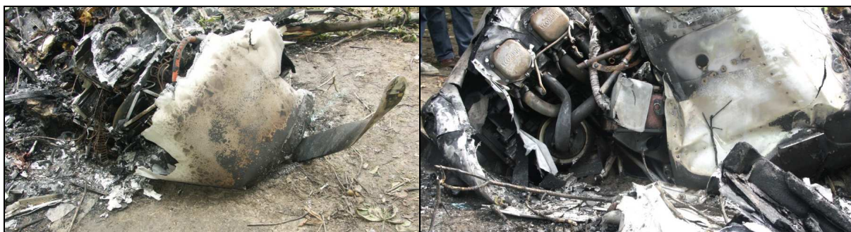
36 – Szczątki przedniej części kadłuba, widoczna górna osłona silnika i łopata śmigła. 37 – Silnik, lewa strona.
