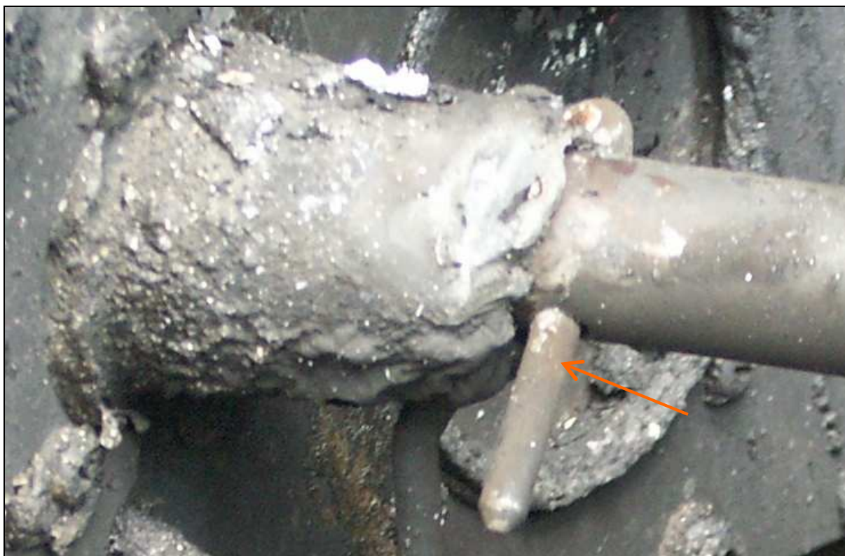
45 – Nieprawidłowo włożona blokada wolantu – zbliżenie.
