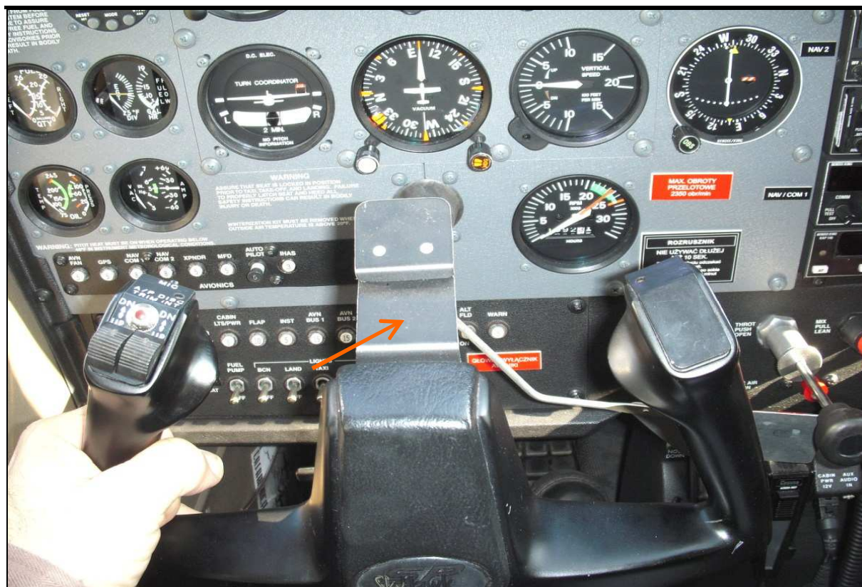
46 – Lewy wolant z uchwytem na pomoce nawigacyjne (identycznie jak na SP-ZAP, uchwyt wskazany pomarańczową strzałką) w kabinie innego samolotu tego samego typu. Uchwyt ten może zasłaniać otwór w obszarze lewego wolantu, przeznaczony do wkładania blokady wolantu.
