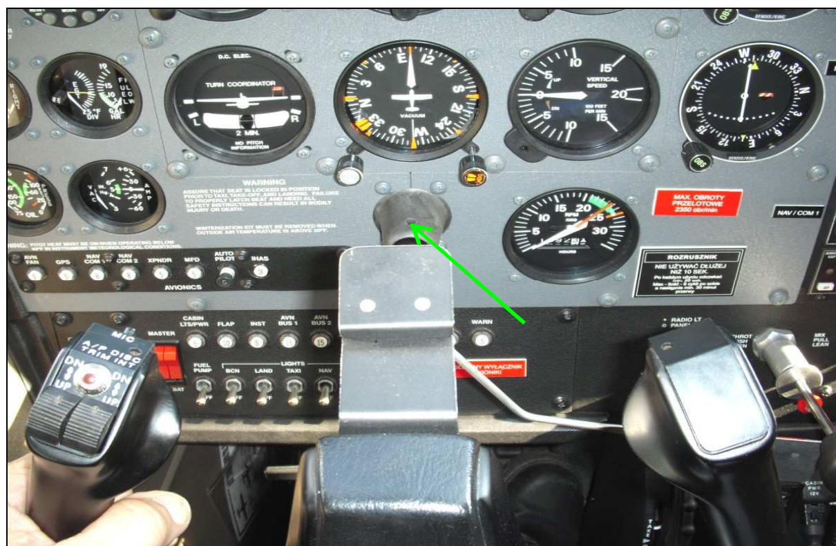
47 – Przy pewnym ruchu głowy do przodu (lub przyciągnięciu wolantu) otwór w obszarze lewego wolantu, przeznaczony do wkładania blokady wolantu, staje się widoczny (zielona strzałka).
