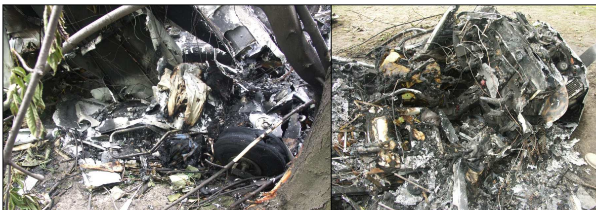
34 – Szczątki przedniej części kadłuba. 35 – Wnętrze kabiny i tablica przyrządów
