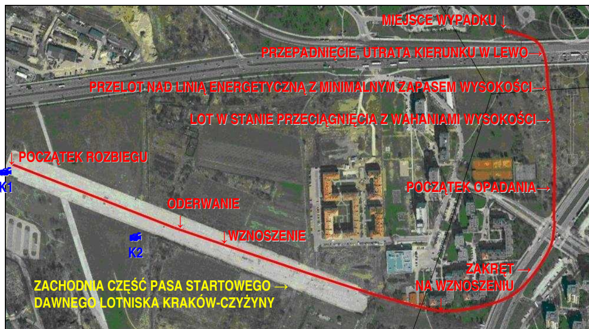
19 – Trasa ostatniego lotu samolotu SP-ZAP (czerwona linia), schematycznie zaznaczono poszczególne fazy i punkty trasy. Czarnymi liniami zaznaczone przewody napowietrznych linii energetycznych. K1 – kamera, z której pochodzi seria zdjęć poklatkowych fot.14. K2 – kamera, z której pochodzi seria zdjęć poklatkowych fot.4.
