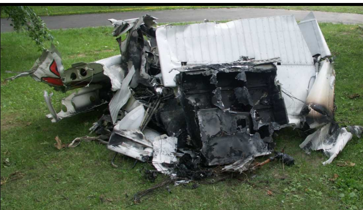
41 – Szczątki podczas wywożenia z miejsca wypadku, widoczna wypalona strefa zbiornika paliwa w lewym skrzydle.
