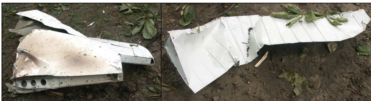
38 – Oderwana jedna z końcówek statecznika poziomego. 39 – Zniszczona klapa.
