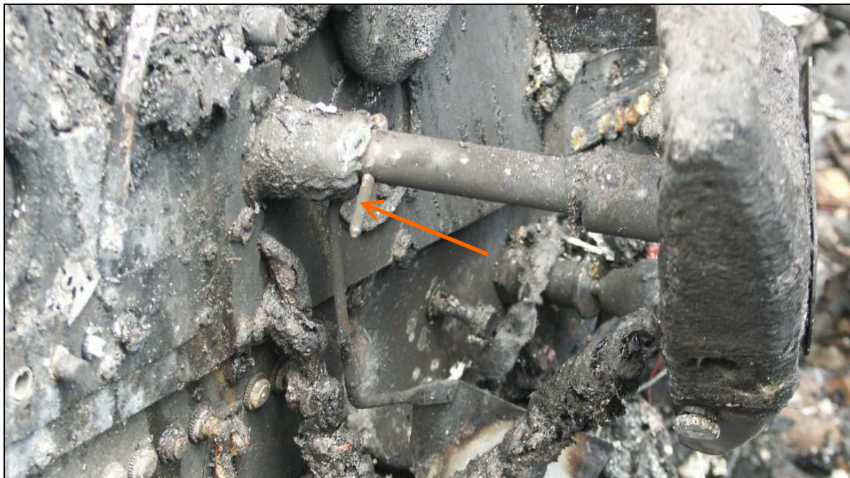
44 – Obsada lewego wolantu w tablicy przyrządów z lewej strony – widoczna nieprawidłowo włożona blokada.
