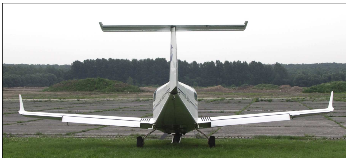
10 – Samolot po wypadku, widok od tyłu. Klapy przestawione w położenie „do lądowania”.
