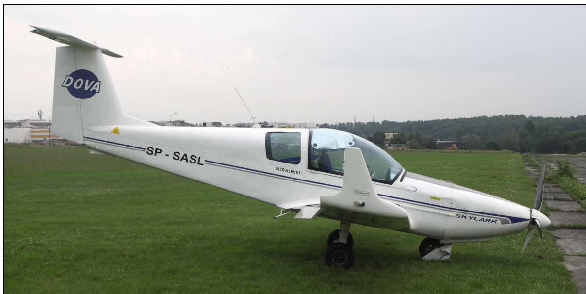
12 – Samolot po wypadku, widok z prawej strony. Klapy przestawione w położenie „do lądowania”.
