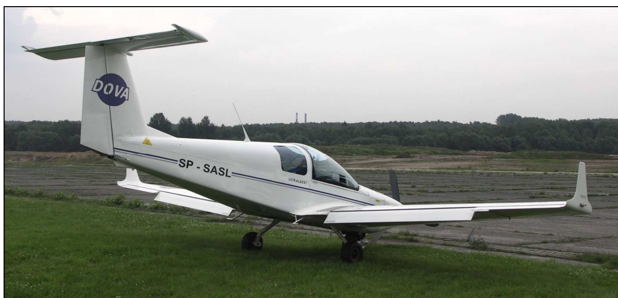
11 – Samolot po wypadku, widok \frac{3}{4} od tyłu z prawej strony. Klapy przestawione w położenie „do lądowania”.
