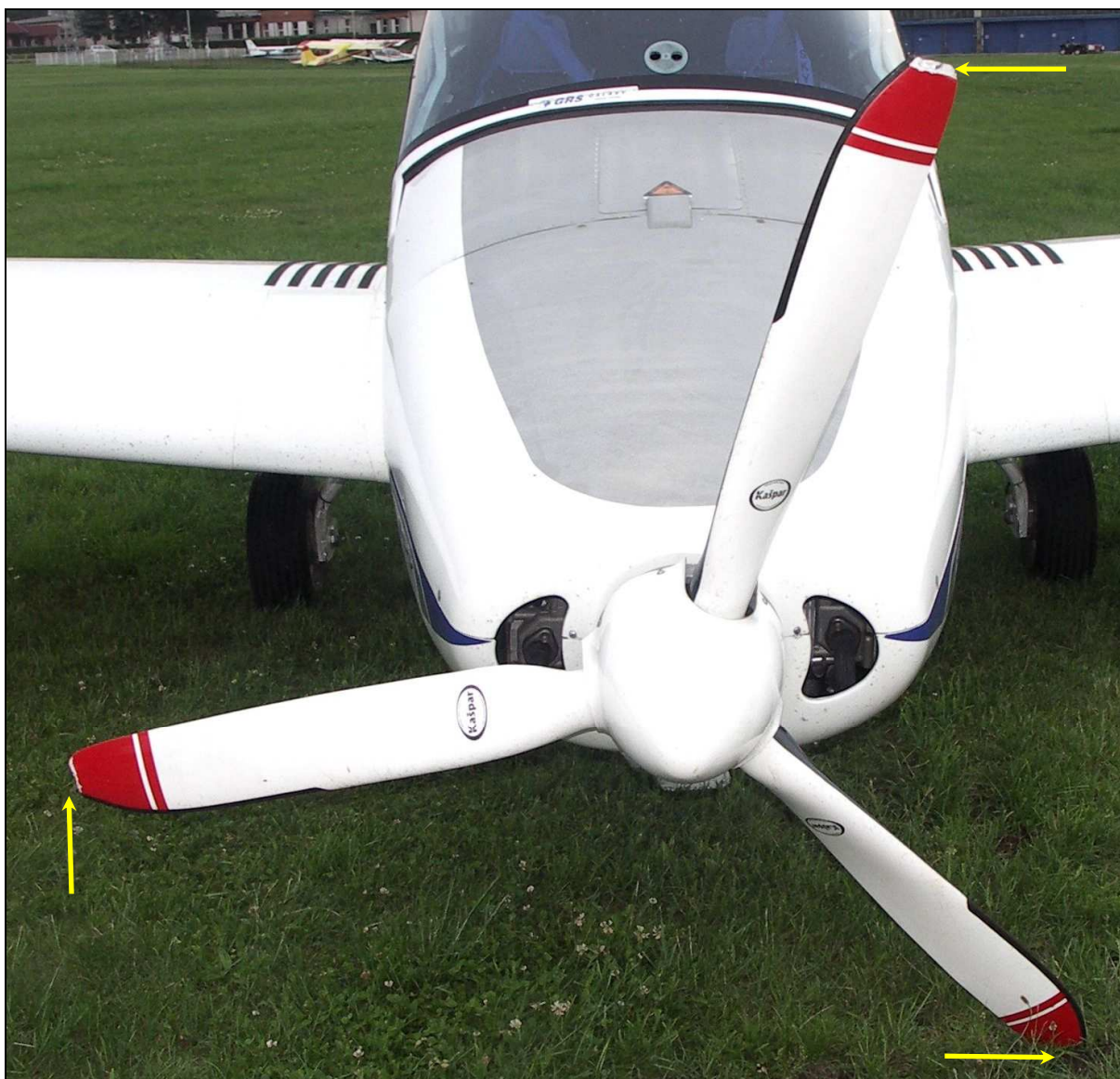
25 – Śmigło w zbliżeniu – dobrze widoczne uszkodzenia końcówek łopatek.
