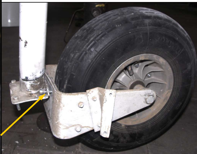
23 – Dolna część goleni z widelcem i kołem, lewa strona. Strzałką wskazana poluzowana wskutek zerwania gwintu lewa tylna śruba mocująca widelec do stopki goleni. Para przednich śrub włożona w otwory stopki.
