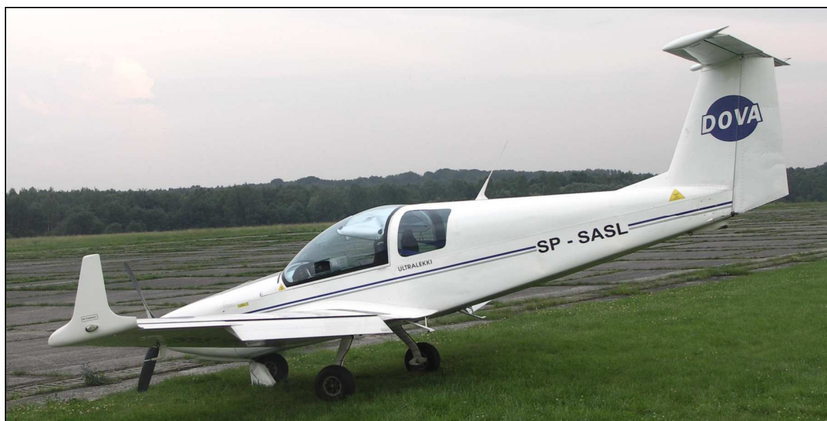
9 – Samolot po wypadku, widok \frac{3}{4} od tyłu z lewej strony. Klapy przestawione w położenie „do lądowania”.
