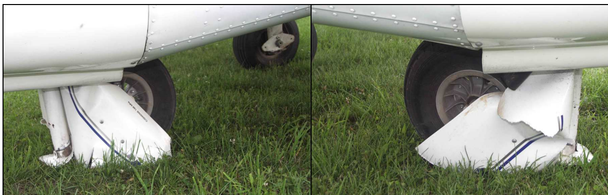
15, 16 – Zbliżenie na uszkodzone podwozie przednie z lewej i prawej strony.
