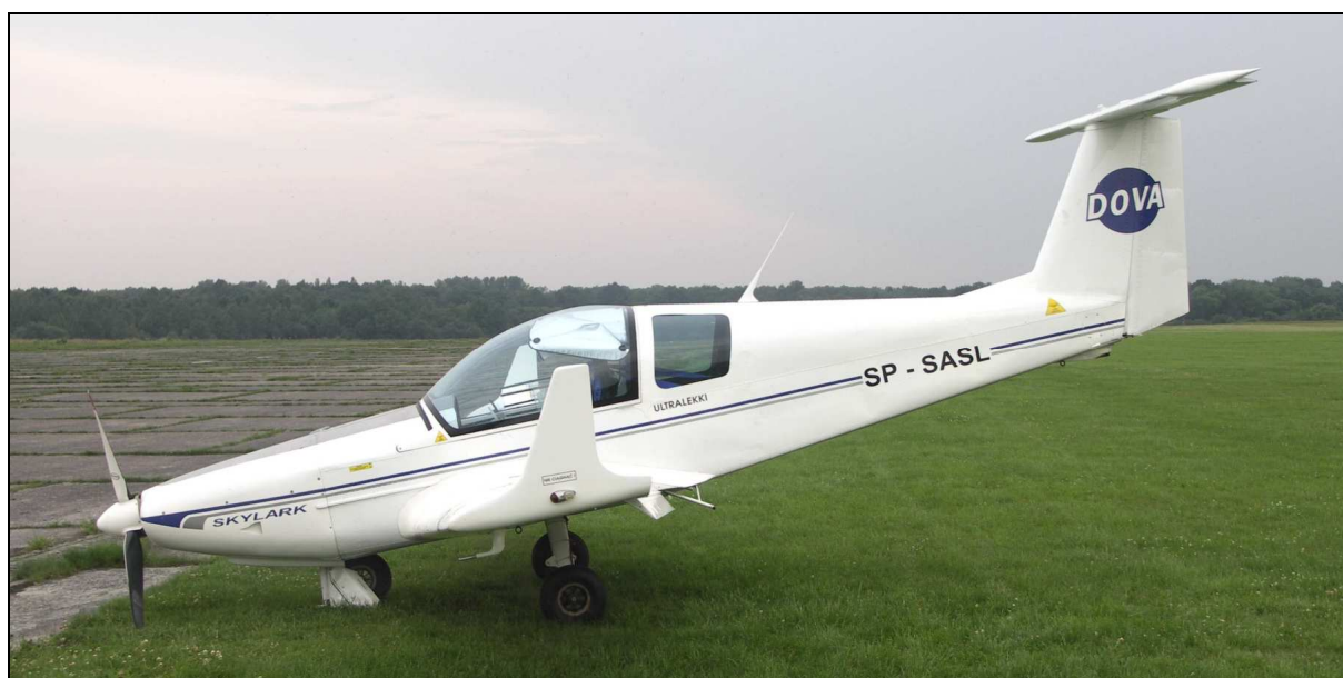
8 – Samolot po wypadku, widok z lewej strony. Klapy przestawione w położenie „do lądowania”.
