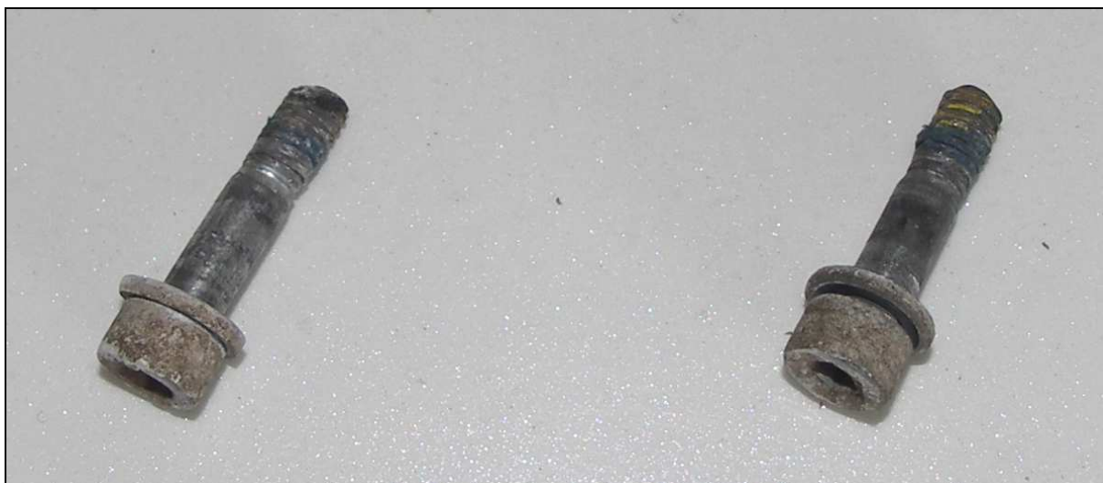
24 – Zerwane przednie śruby mocujące widelec koła do stopki goleni podwozia przedniego.
