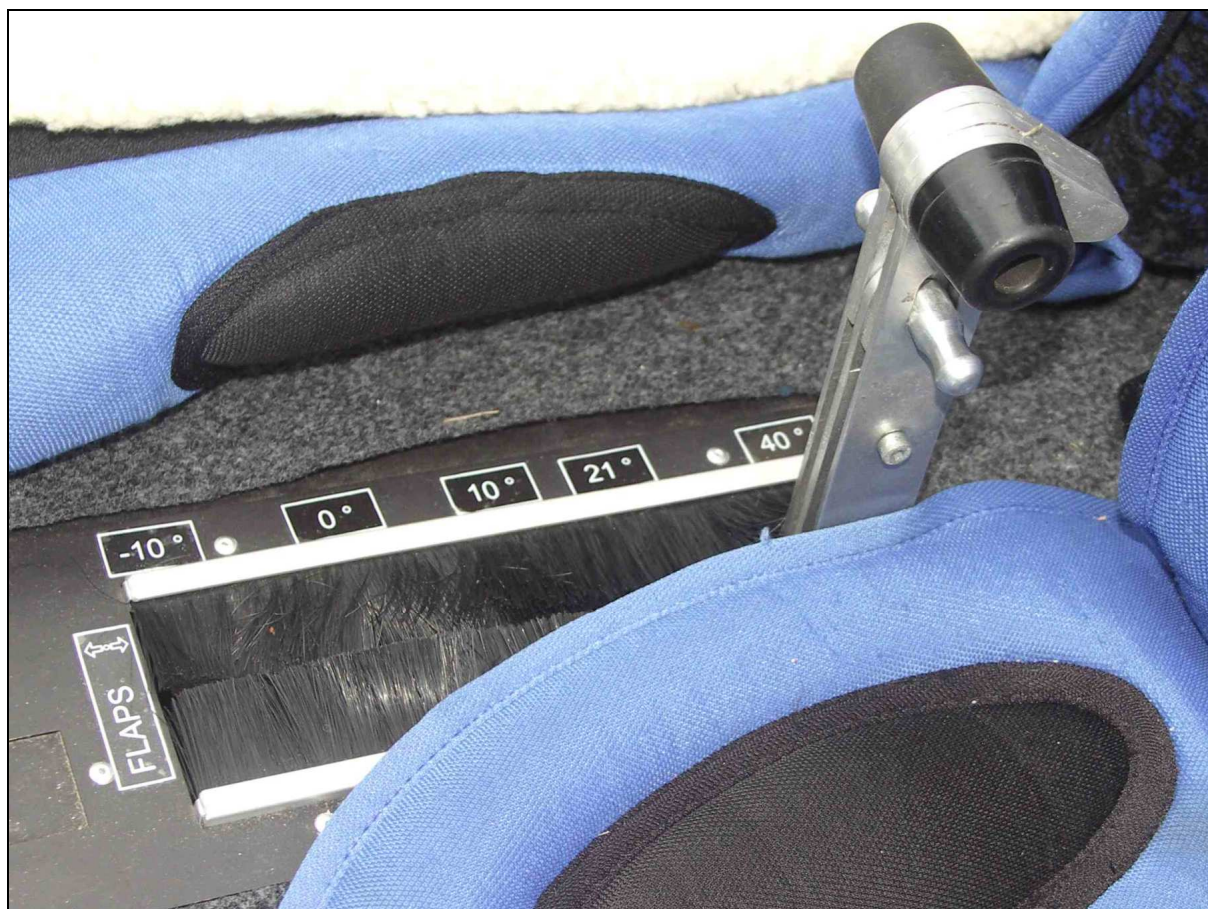
27 – Dźwignia sterowania klapami, przestawiona po wypadku do położenia „40°”.
