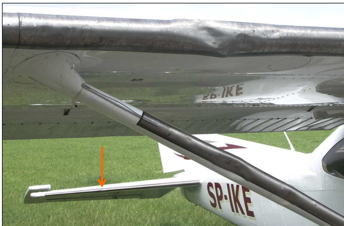
27 – Uszkodzenia noska prawego skrzydła, prawego zastrzału skrzydłowego i prawego statecznika poziomego (strzałka) – zbliżenie.
