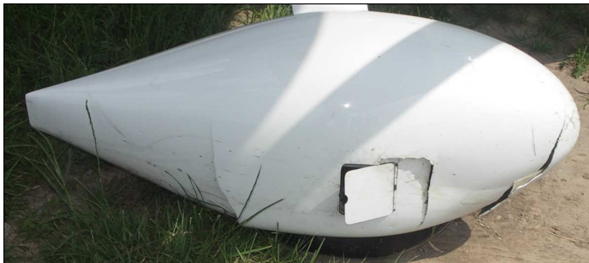
28 – Uszkodzenia owiewki prawego koła.
