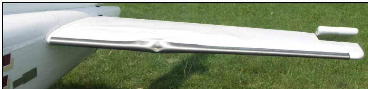
25 – Uszkodzenie (wgłębienie) noska lewego statecznika poziomego.
