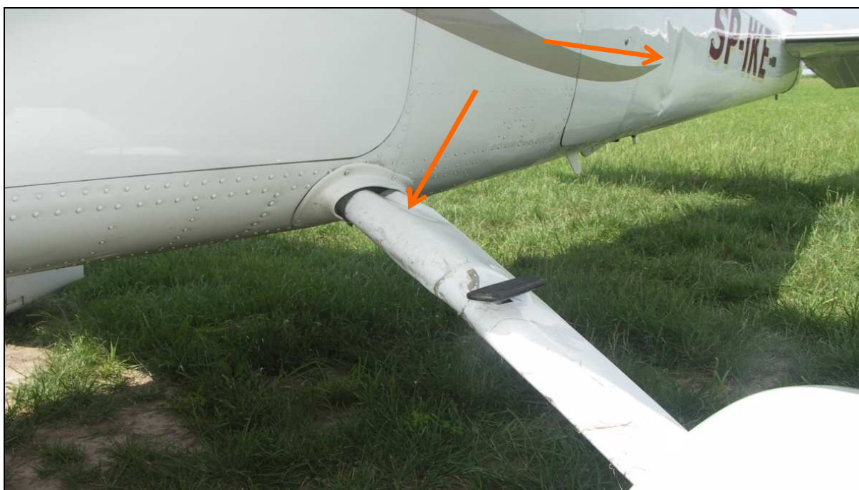
22 – Zniszczenie goleni lewego podwozia głównego i odkształcenie pokrycia kadłuba po lewej stronie.
