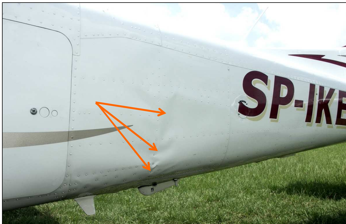
23 – Odształcenie pokrycia kadłuba po lewej stronie.
