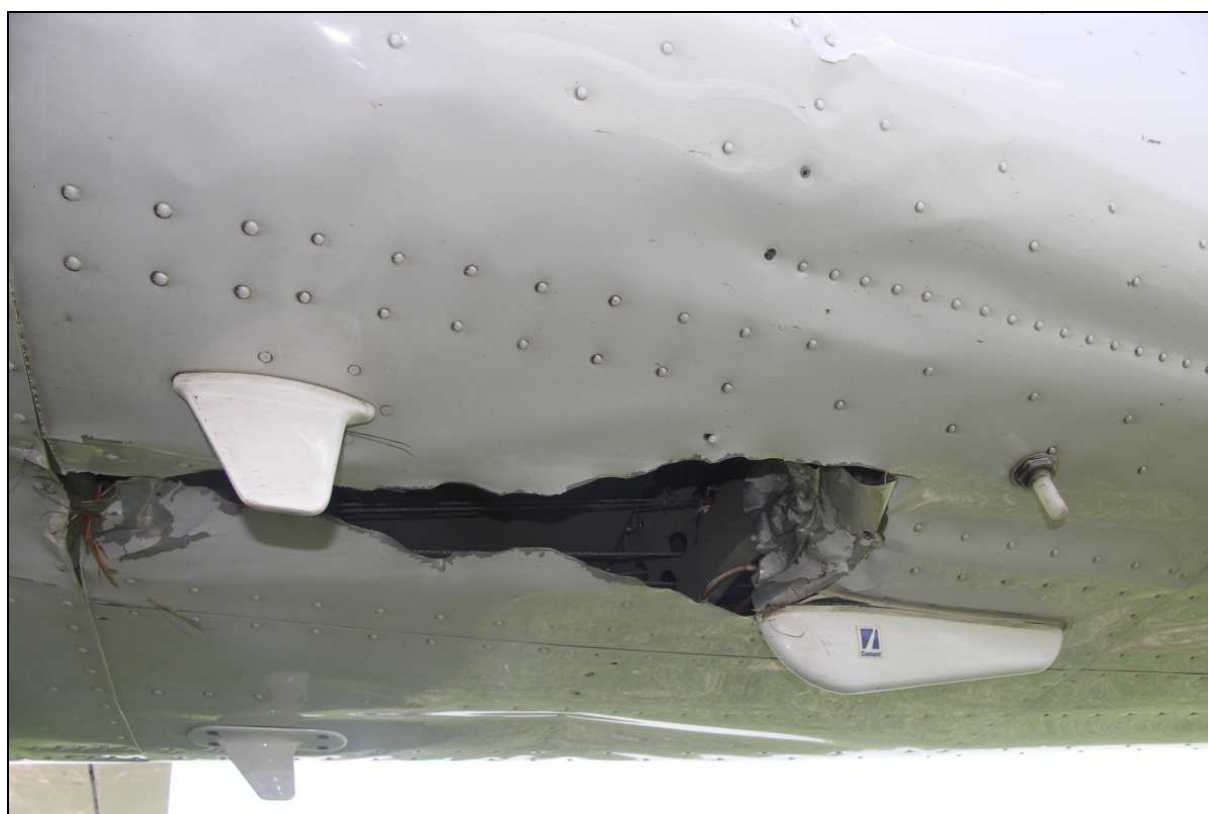
24 – Rozdzarcie dolnego pokrycia kadłuba między wręgami za bagażnikiem.
