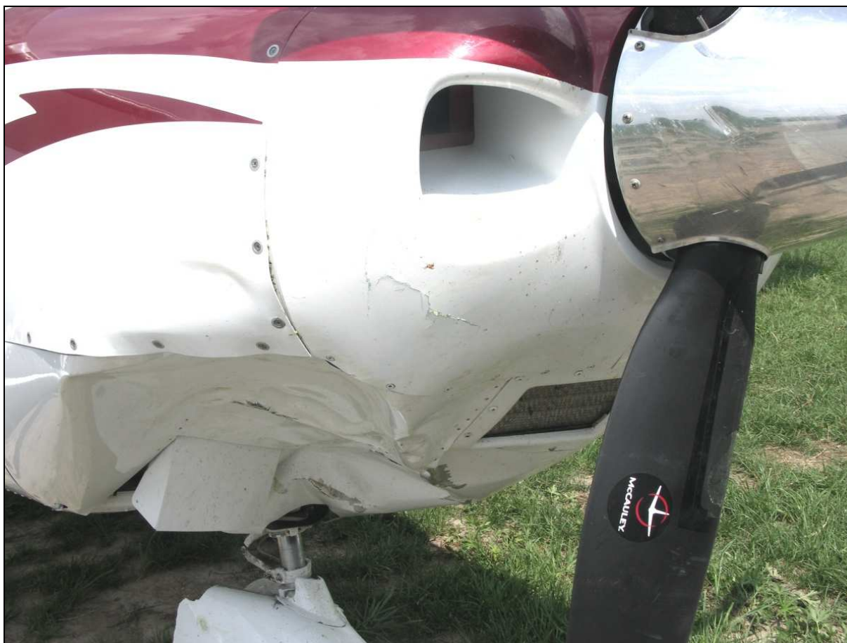
19 – Zbliżenie na uszkodzenia dolnej osłony silnika.
