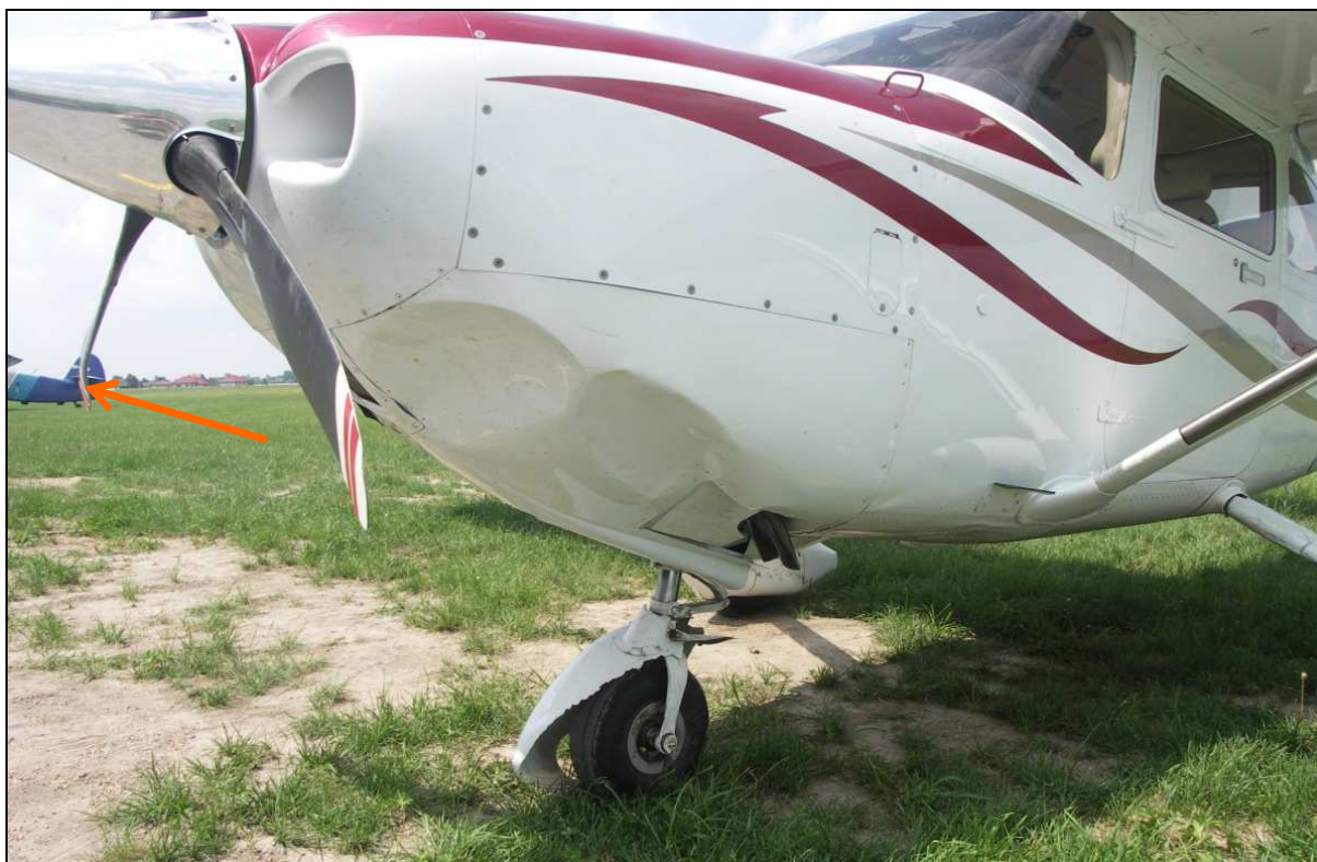
16 – Uszkodzenia dolnej osłony silnika, owiewki przedniego podwozia i rury wydechowej z lewej strony. Strzałką wskazana odkształcona końcówka łopaty śmigła.
