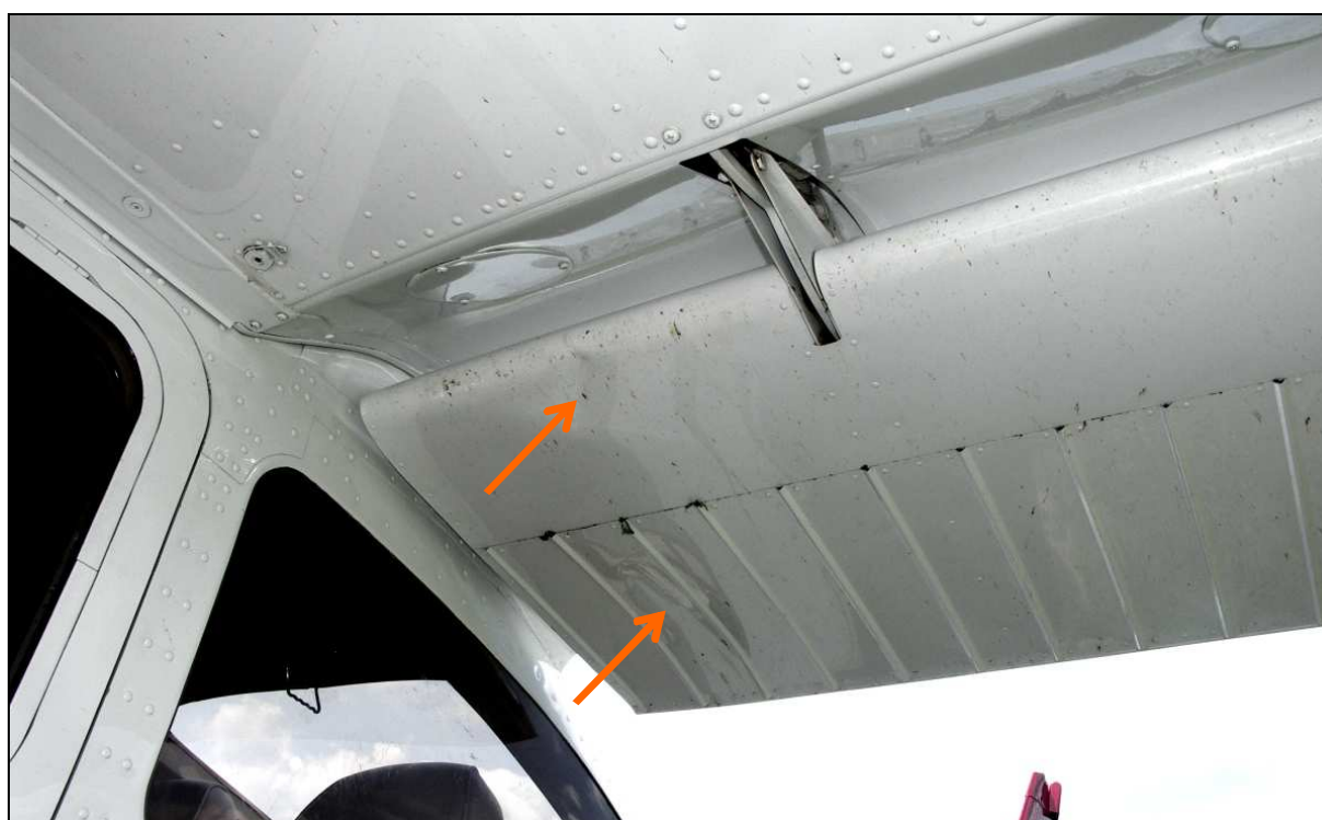
30 – Uszkodzenia (wgniecenia) pokryć dolnej powierzchni lewej kłapy u nasady.
