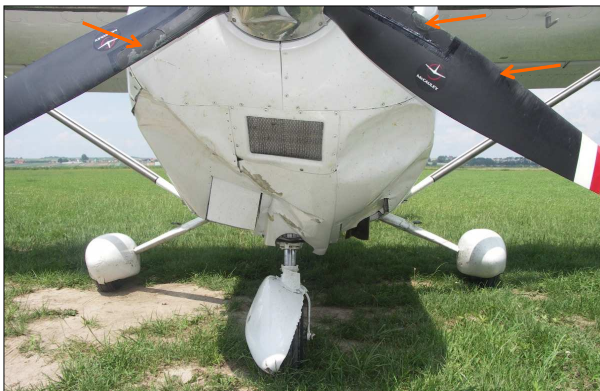
15 – Przód samolotu w zbliżeniu. Widoczne uszkodzenia dolnej osłony silnika, rury wydechowej i owiewki przedniego podwozia oraz uszkodzenia krawędzi natarcia łopat śmigła i nakładek grzejnych (wskazane strzałkami).
