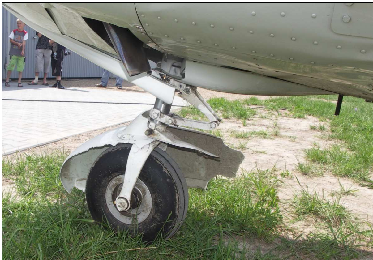
21 – Zniszczona owiewka przedniego podwozia i zgnieciona rura wydechowa. Widoczne zniekształcenia dolnego pokrycia kadłuba.
