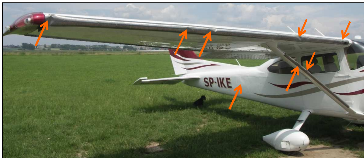
26 – Uszkodzenia (wgłębienia) noska prawego skrzydła i prawego zastrzału skrzydłowego oraz uszkodzenie owiewki prawego koła i odkształcenie pokrycia kadłuba z prawej strony.
