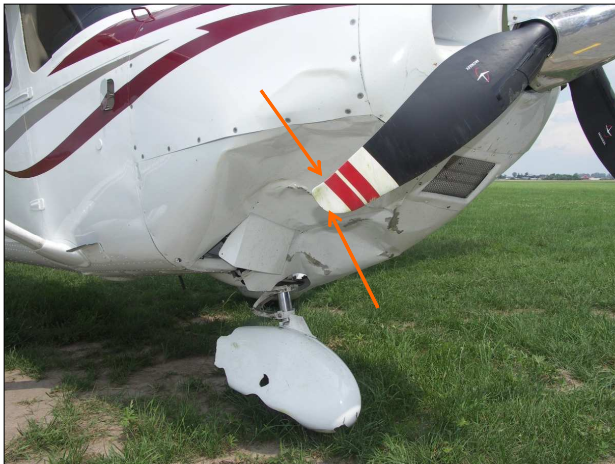
14 – Uszkodzenia dolnej osłony silnika i owiewki przedniego podwozia z prawej strony. Strzałką wskazana odkształcona końcówka łopaty śmigła.
