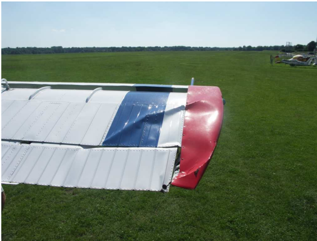
1. Uszkodzenia prawego skrzydła i prawej lotki.
