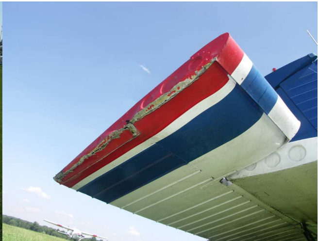
2. Uszkodzenia prawego segmentu steru wysokości.
